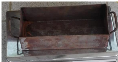
Figura 3. Molde metálico de ladrillo
