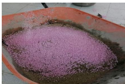
Figura 15. Proceso de mezclado con 40 % de poliestireno XPS
