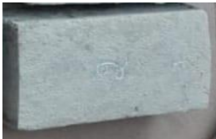
Figura 14. Ladrillo de concreto con 20 % de poliestireno XPS
