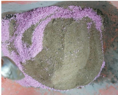
Figura 13. Proceso de mezclado con 20 % de poliestireno XPS
