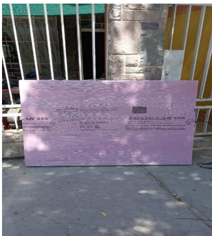
Figura N° 71 Plancha de poliestireno extruido
