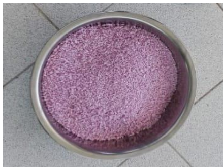
Figura 7. Poliestireno extruído triturado
