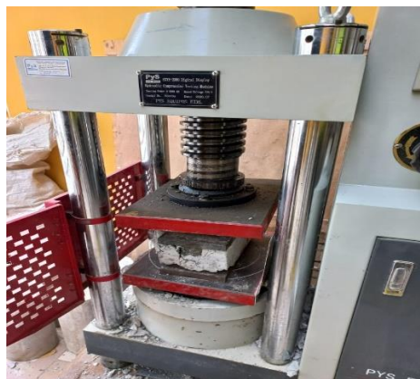
Figura N° 67 Resistencia a compresión a los 14 días
