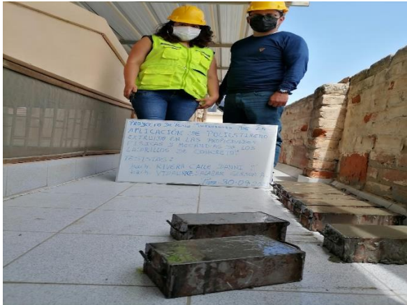
Figura N° 59 Proceso de fraguado de los ladrillos de concreto Fuente: Elaboración propia
