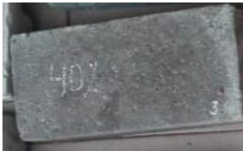
Figura 16. Ladrillo de concreto con 40 % de poliestireno XPS
