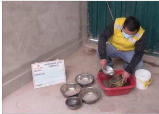
Figura 17. En la imagen se muestra el lavado del material con la malla N°200 para el análisis granulométrico
