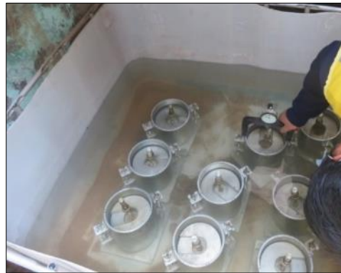
Figura 34. Moldes en la posa verificando la expansión del suelo.
