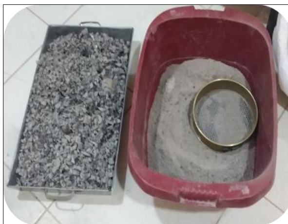
Figura 11. Proceso de separación de la cenizas con el tamiz N°04
