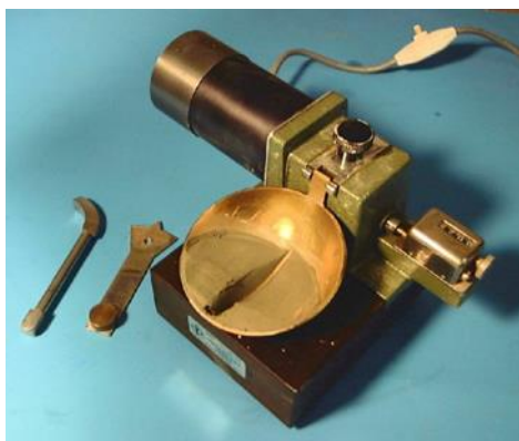
Figura 3. Detalle de la copa Casagrande con su ranurador
