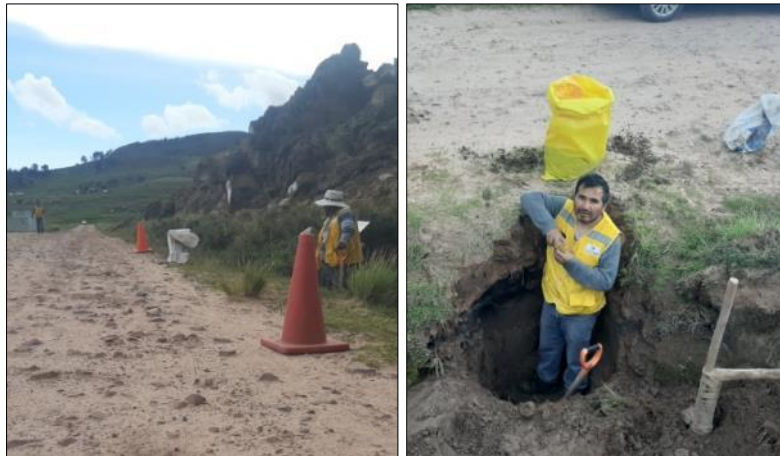
Figura 14. Las dos imágenes corresponden a la Calicata N°02, donde la imagen de la izquierda muestra el margen izquierdo de la carretera, y la imagen de la derecha muestra la calicata excavada.
