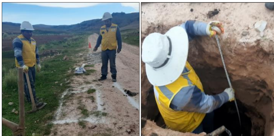
Figura 14. Las dos imágenes corresponden a la Calicata N°02, donde la imagen de la izquierda muestra el margen izquierdo de la carretera, y la imagen de la derecha muestra la calicata excavada.
