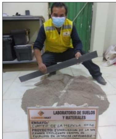
Figura 23. Una vez mezclado se procedió con el cuarteo
