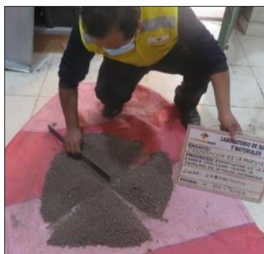
Figura 16. En la imagen se muestra el cuarteo para el análisis granulométrico para el suelo patrón.
