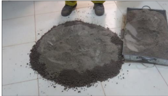
Figura 22. Mezcla del suelo con las cenizas
