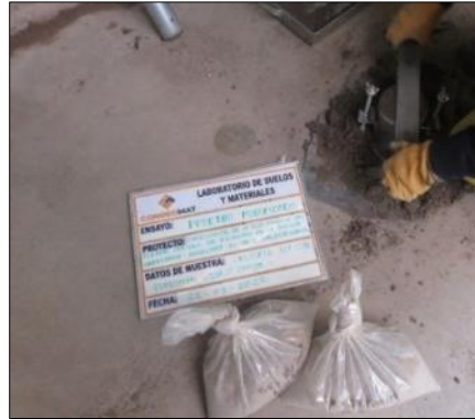
Figura 30. Ensayo de Proctor modificado método "A"
