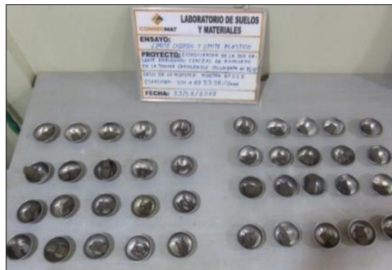
Figura 29. Muestras para sacar el contenido de humedad de los ensayos de limite líquido y limite plástico.
