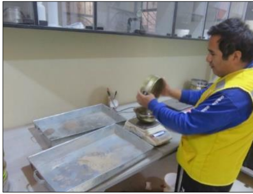
Figura 25. Imagen realizando el análisis granulométrico
