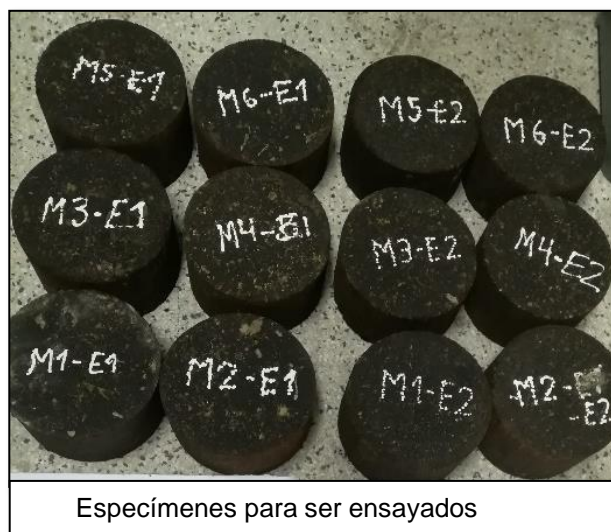
Figura 7. Especímenes con emulsión asfáltica
