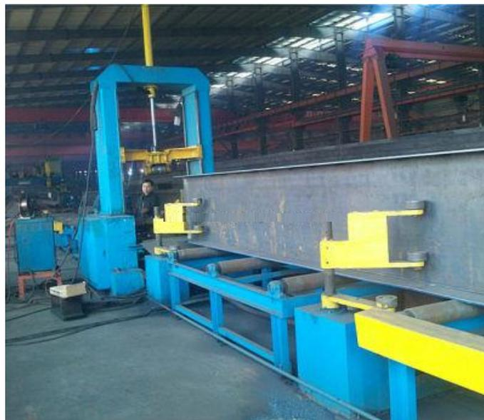
Figura 1. Sistema de soldeo de viga móvil.
