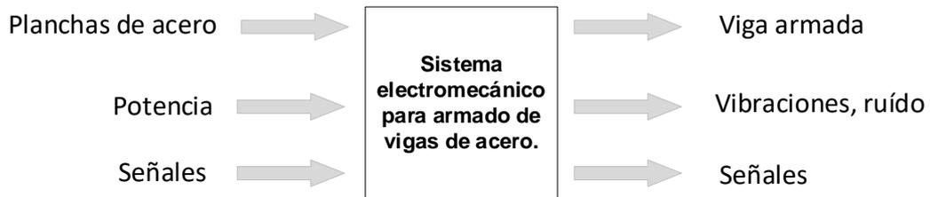
Figura 11. Blackbox sistema de armado de vigas no estándar. *Fuente: propia.*
