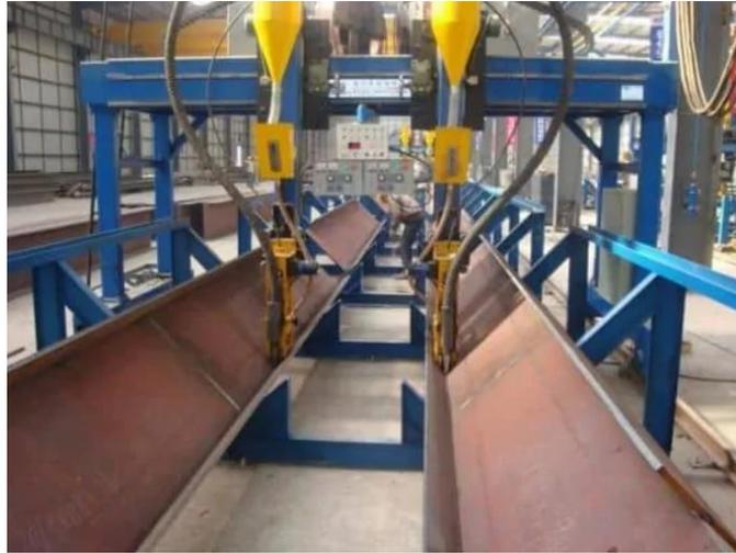
Figura 2. Sistema de soldeo de doble viga estática inclinada. (Waldun, 2022)
