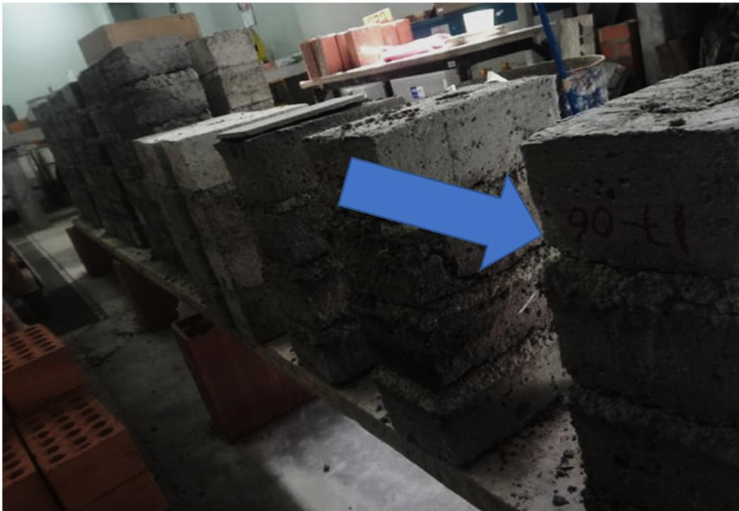
*Figura 24.* Término y tiempo de espera para el total de fraguado de las pilas 28 días. Elaboración propia.
