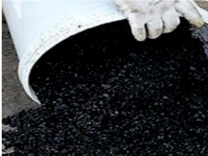
*Figura 16.* Pre-mezclado de asfalto reciclado. Fuente propia
