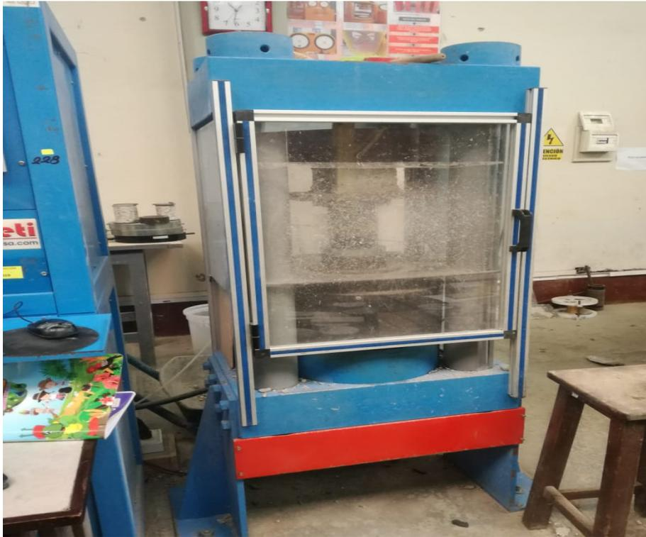
La máquina uniaxial, PROETI. Para el ensayo de compresión de ladrillos en unidades de albañilería. Certificado de calibración. CMC -067-2019. Elaboración propia.
