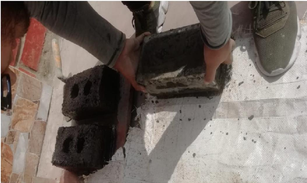
Figura 15: ladrillo de asfalto pre-secado y fabricación. Elaboración propia.
