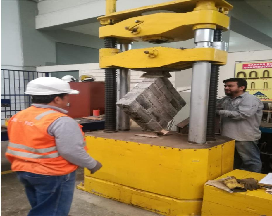
Ensayo de compresión al murete. Elaboración propia.
