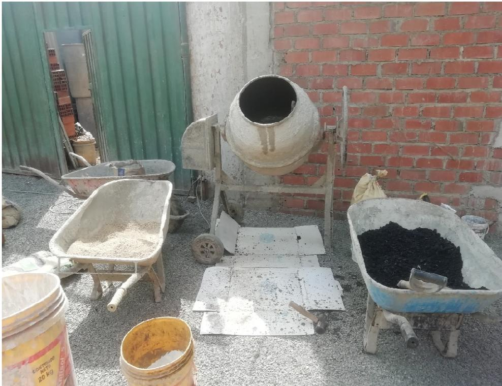
Materiales y equipos para la fabricación de ladrillos LAR. Elaboración propia.
