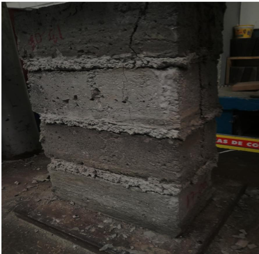
Ensayo de compresión en pilas de los ladrillos LAR. Fallas de fisuras verticales y grietas menores para P-1, P-2, P-3. Elaboración propia.
