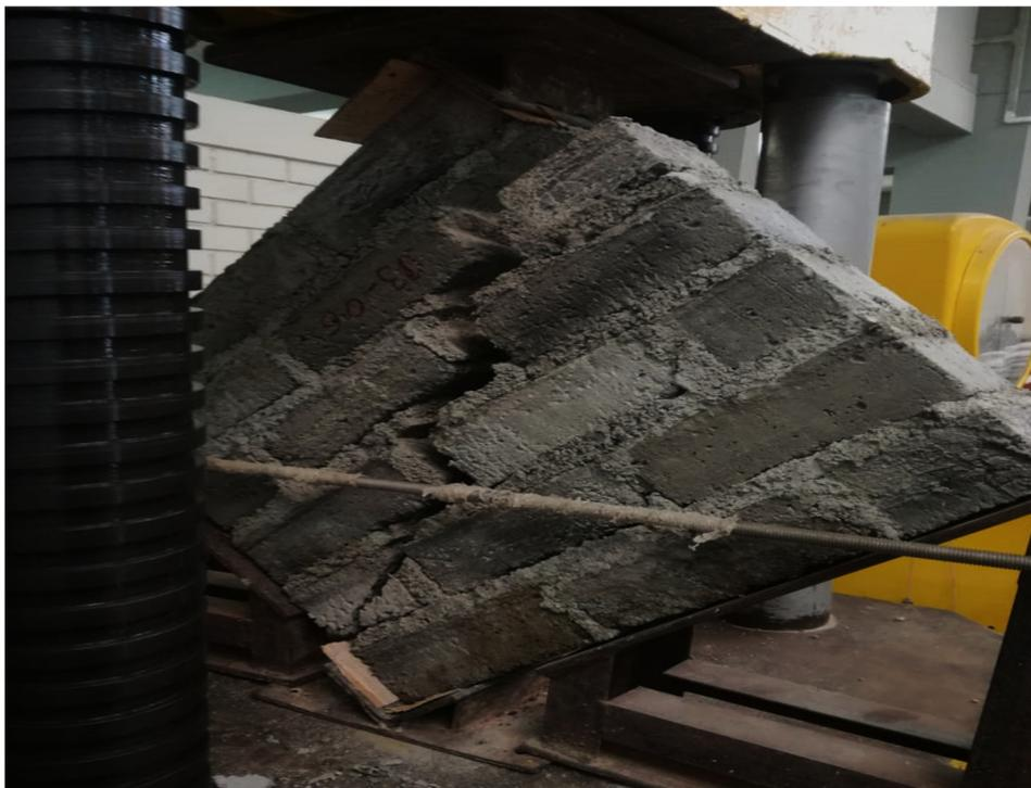
Ensayo de compresión a corte diagonal del murete. Falla de mortero. M -3
