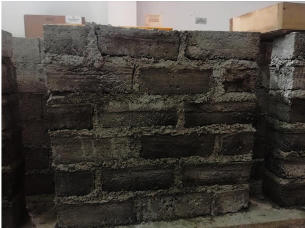
Figura 27. Elaboración propia. Murete de ladrillos LAR. 0.60 x 0.60m.
