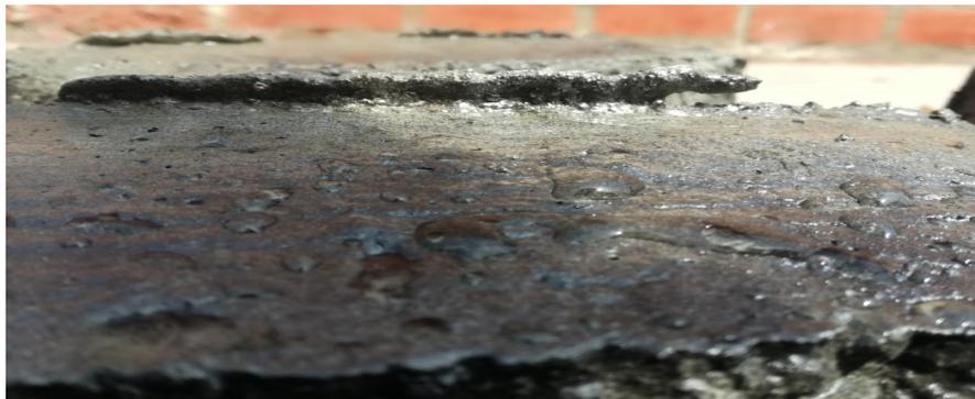
*Figura 22:* Ensayo de absorción al ladrillo de asfalto reciclado por 24 horas en unidad de albañilería. Fuente propia.
