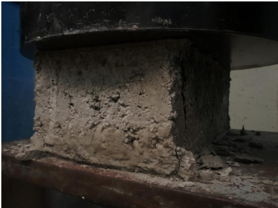
Pruebas del ensayo en unidades de albañilería para las muestras L-1, L-2, L-3, L-4, L-5 con similares resultados. Elaboración propia.
