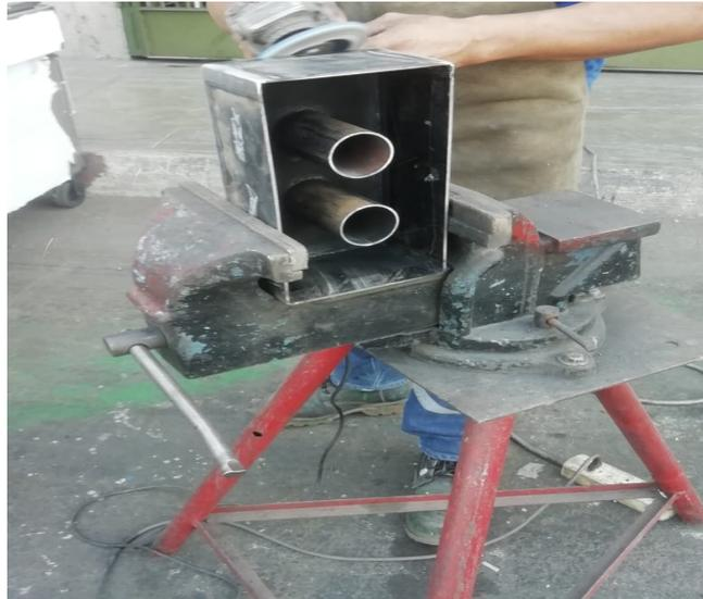
*Figura 17:* molde de acero para la fabricación del ladrillo a base de asfalto y agregados finos.
