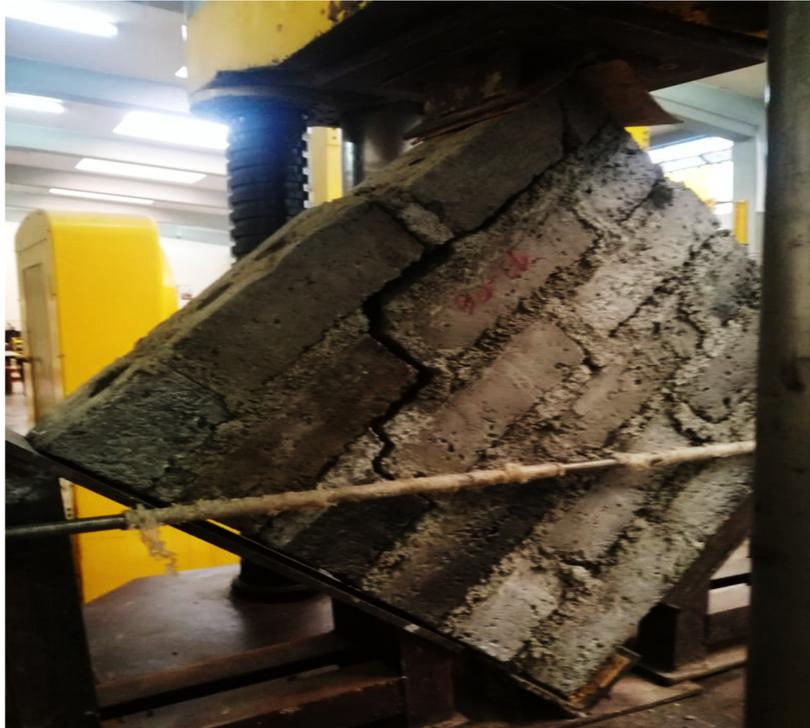
Figura 28. Ensayo, corte diagonal del murete en la maquina universal. TOKYOKOKI SEIZOSHO Elaboración propia.
