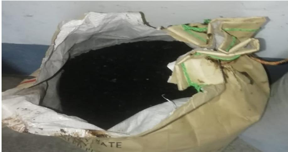
Figura 3. Asfalto reciclado
