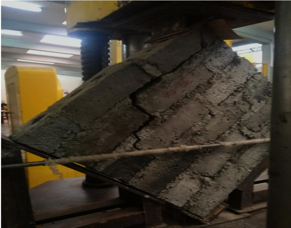
Ensayo de murete. Falla similar de mortero para M-1 Y M-2. Elaboración propia.
