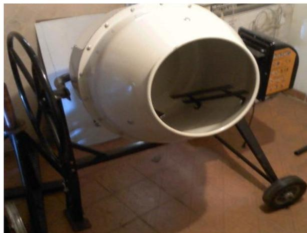
*Figura 18:* Trompo mezcladora de media bolsa  $\frac{1}{2}$  para la uniformidad de los materiales. Fuente propia.
