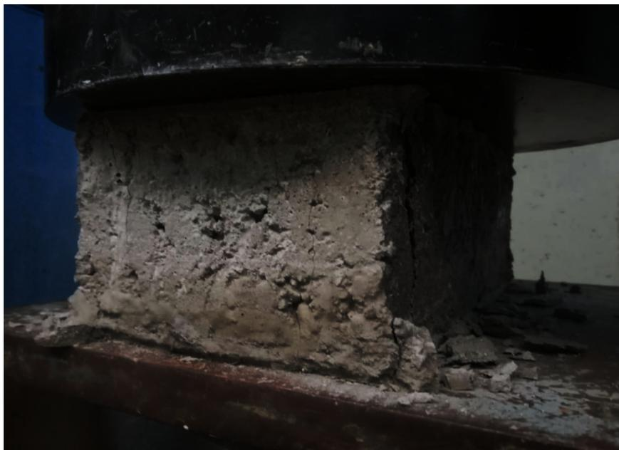
*Figura 20:* Ensayo de compresión al ladrillo de asfalto reciclado en unidades de albañilería. Ensayadas con la maquina uniaxial, PROETI. Certificado calibrado de cmc-067 - 2019. Elaboración propia.
