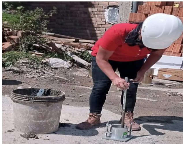
Figura 15 Ensayo de Peso Unitario del concreto
