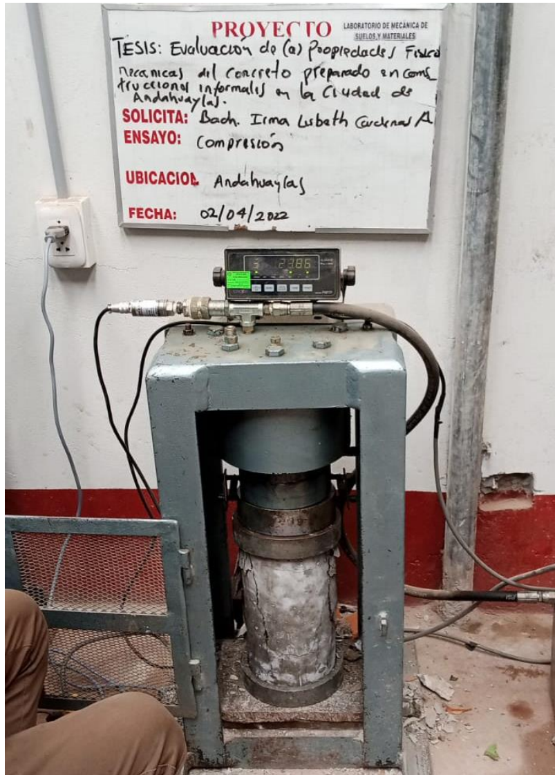
Figura 55 ensayo de compresión-vivienda 1
