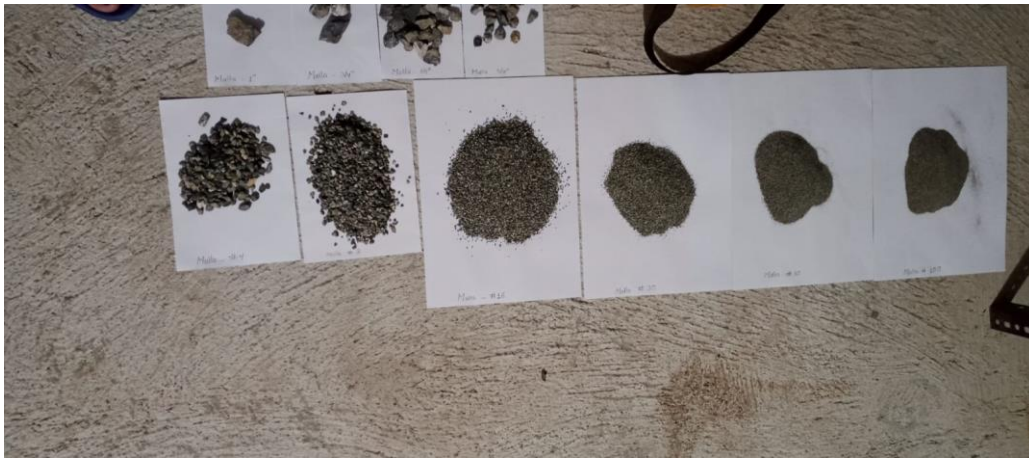
Figura 20 Ensayo granulométrico- vivienda 1
