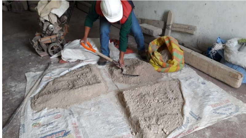
Figura 10. Cuarteo de la mezcla de lodos de concreto con el suelo
