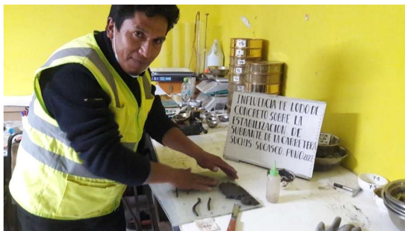
Figura 13. Elaboración de los hilos de suelo para el límite plástico
