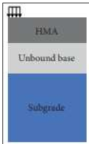
Figura 6. Estructura de un pavimento, conseguido de « Propiedades mecánicas de las cenizas de fondo de incineradores de residuos sólidos urbanos (MSWI) como alternativas de materiales de subrasante », por Huang et al., 2020, p. 3
