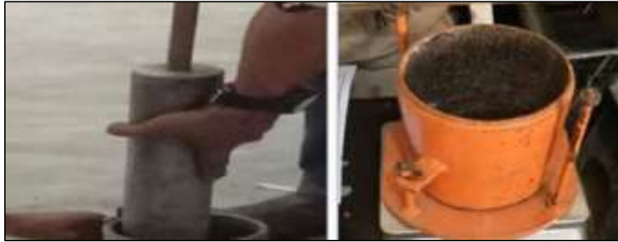
Figura 4. Ensayo de Proctor modificado, tomado de «Análisis de la compactación del suelo utilizando estándares Proctor en el diseño de la construcción de carreteras», por Mahardika et al. (2021, p. 4)
