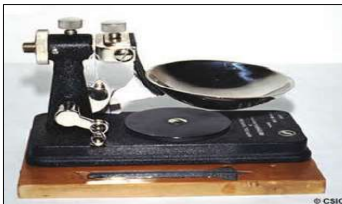
Figura 2. Cuchara de Casagrande, tomado de « Contribución al conocimiento de la geotecnia temprana durante el siglo XX: Arthur Casagrande », por Galindo, Lara y Guillán (2018, p. 108)
