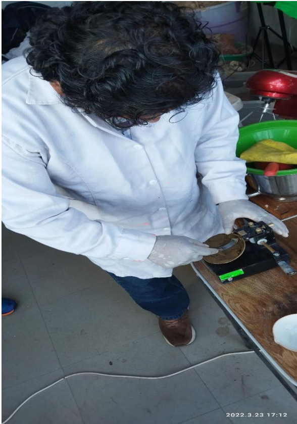
FIGURA12. Preparación muestra en copa Casagrande para cada A.P.V
