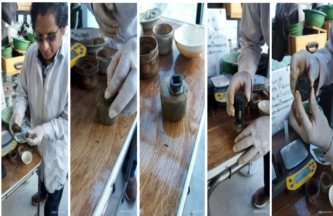
Sometimiento al esfuerzo de corte, a la muestra de suelo, con la Veleta de tipo torvane para cada A.P.V.
