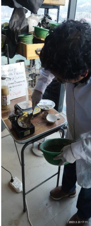
Aplicación del equipo de copa Casagrande para el ensayo del límite líquido.
