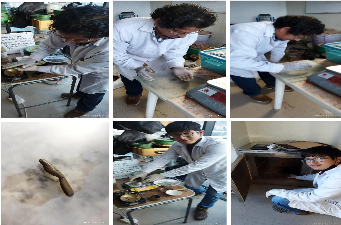
Preparación y elaboración del ensayo de plasticidad del suelo.
