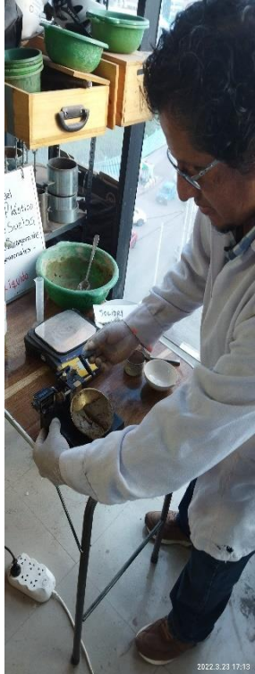
Aplicación del equipo de copa Casagrande para el ensayo del límite líquido.
