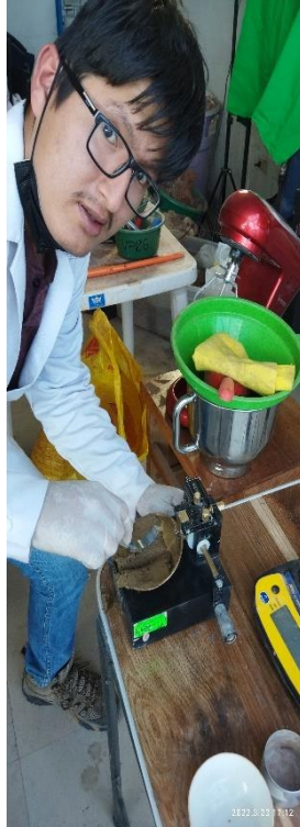
Aplicación del equipo de copa Casagrande para el ensayo del límite líquido.
