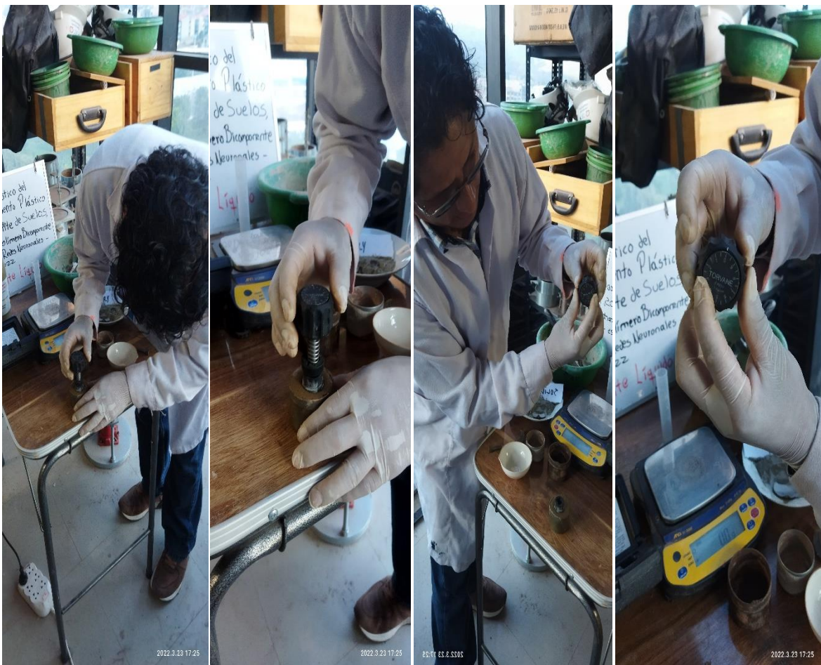
FIGURA29. Aplicación del equipo Veleta Torvane para la lectura de la resistencia al corte del suelo
