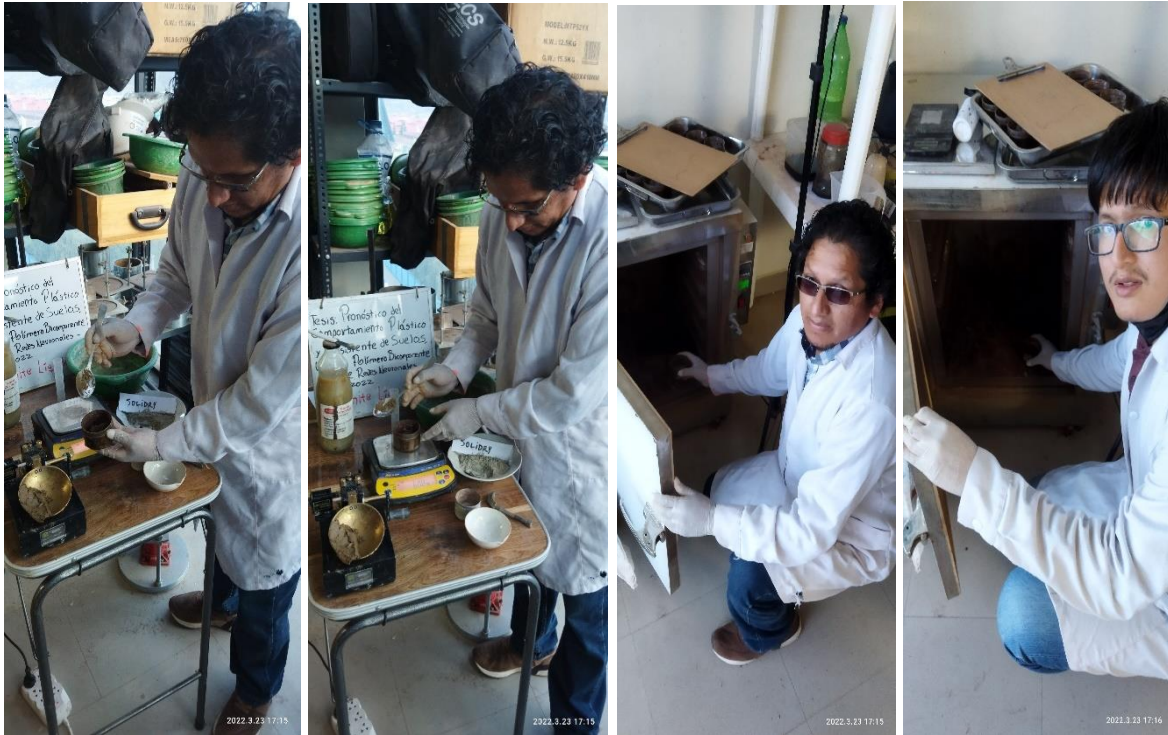
Pesado de la muestra húmeda, para posteriormente, secarlo en el horno a una temperatura no menor de 300°C, realizado para cada A.P.V.
