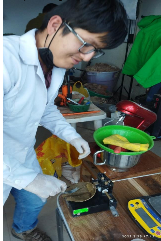
FIGURA12. Preparación muestra en copa Casagrande para cada A.P.V
