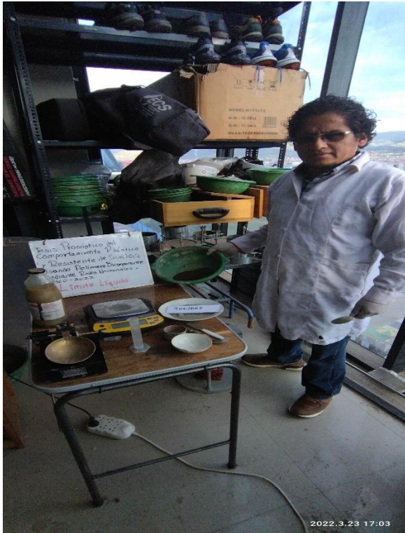
A la izquierda , equipo y material para el ensayo de limite líquido y a la derecha , equipo para para el ensayo de la resistencia al corte del suelo (Veleta Torvane)
