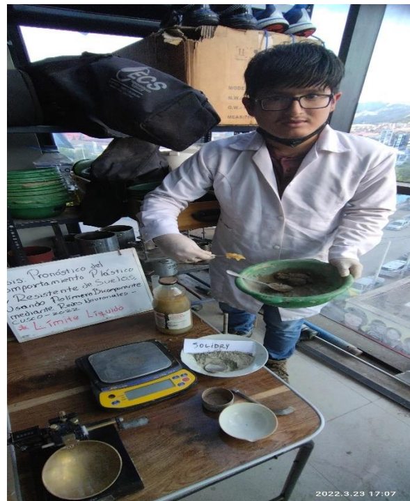
Adición de polímero sólido, Solidry ( izquierda ) y polímero líquido, Consolid 444 ( derecha )
