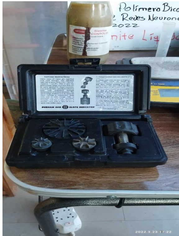
A la izquierda , equipo y material para el ensayo de limite líquido y a la derecha , equipo para para el ensayo de la resistencia al corte del suelo (Veleta Torvane)
