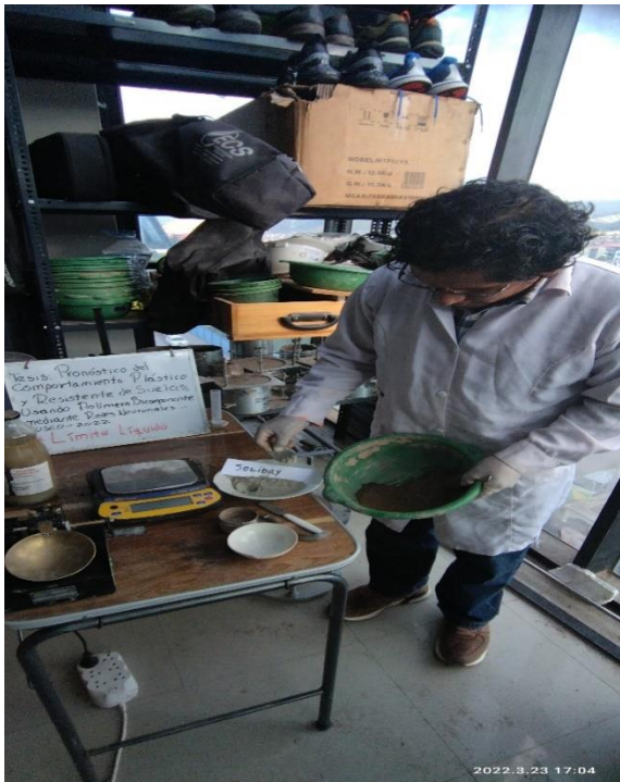
Adición de polímero sólido, Solidry ( izquierda ) y polímero líquido, Consolid 444 ( derecha )
