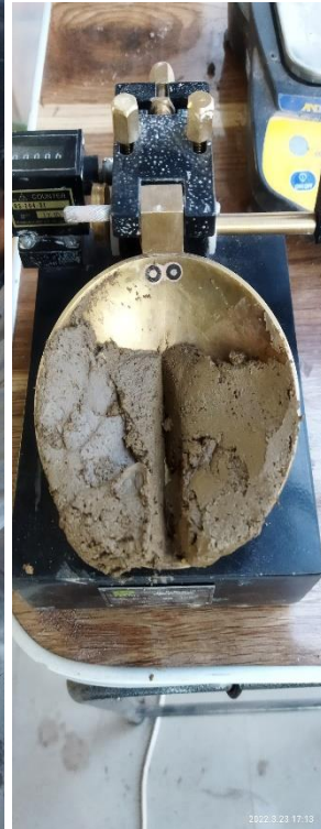
Aplicación del equipo de copa Casagrande para el ensayo del límite líquido.
