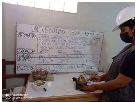
**Figura 3.10.** Ensayo LL, SN + 20% CR, C1
