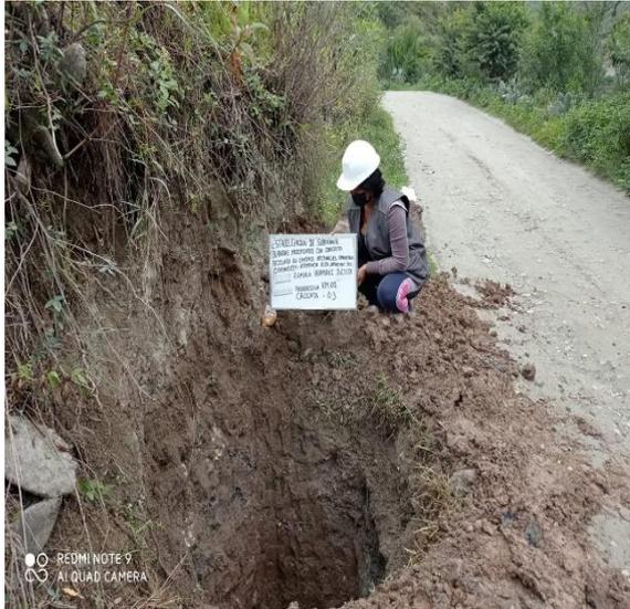
**Figura 3.4.** Extracción de muestra natural, calicata 03 Km 1+000
