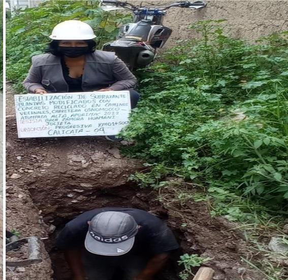
**Figura 3.5.** Extracción de muestra natural, calicata 04 Km 1+500
