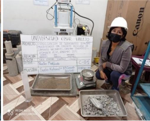
Figura 4.5. Ensayo de PM, C-01, SN + 10% CR
