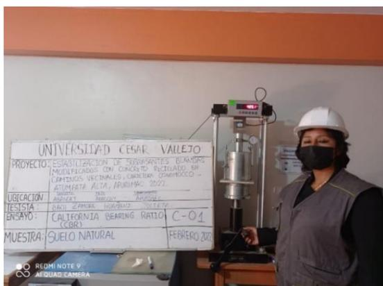
**Figura 4.8.** Ensayo de CBR, C-01 en su EN
