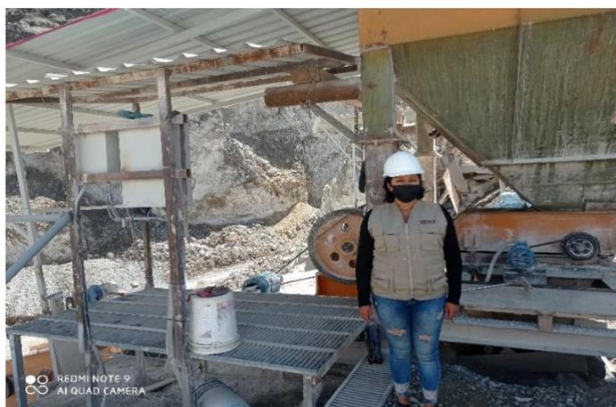
**Figura 3.7.** Trituración del concreto reciclado en una molienda
