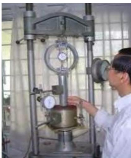
**Figura 2.3.** Ensayo del CBR en laboratorio
