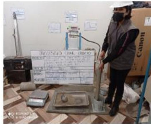
Figura 6. Ensayo de adición de concreto reciclado a espécimen CBR
