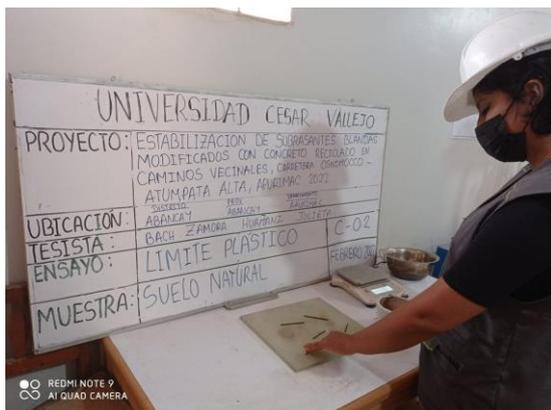
**Figura 3.16.** Ensayo LP, SN, C2
