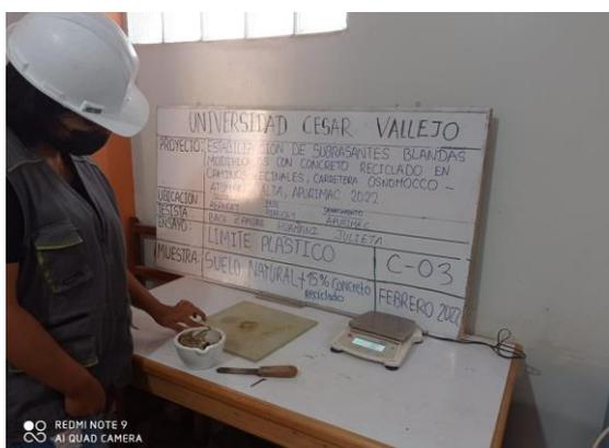
**Figura 3.18.** Ensayo LP, SN + 15% CR, C3
