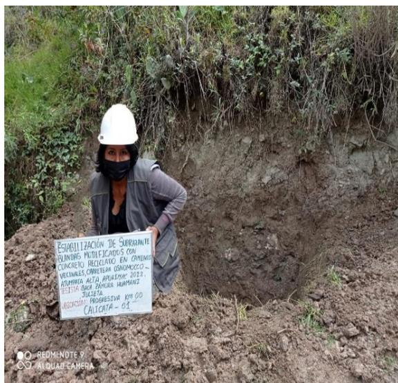
**Figura 3.2.** Extracción de muestra natural, calicata 01 Km 00+000
