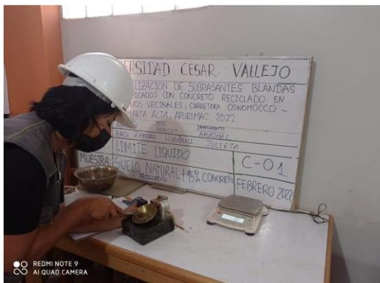
**Figura 3.11.** Ensayo de LL, SN + 15% CR, C1
