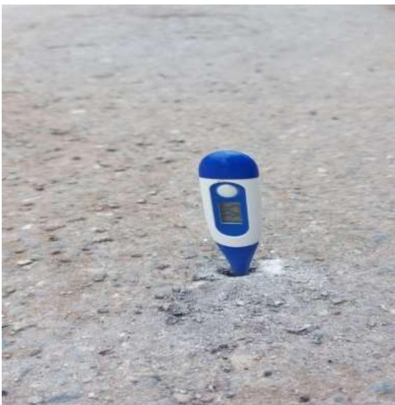
Figura N°10: Toma de la temperatura del pavimento con un termómetro digital
