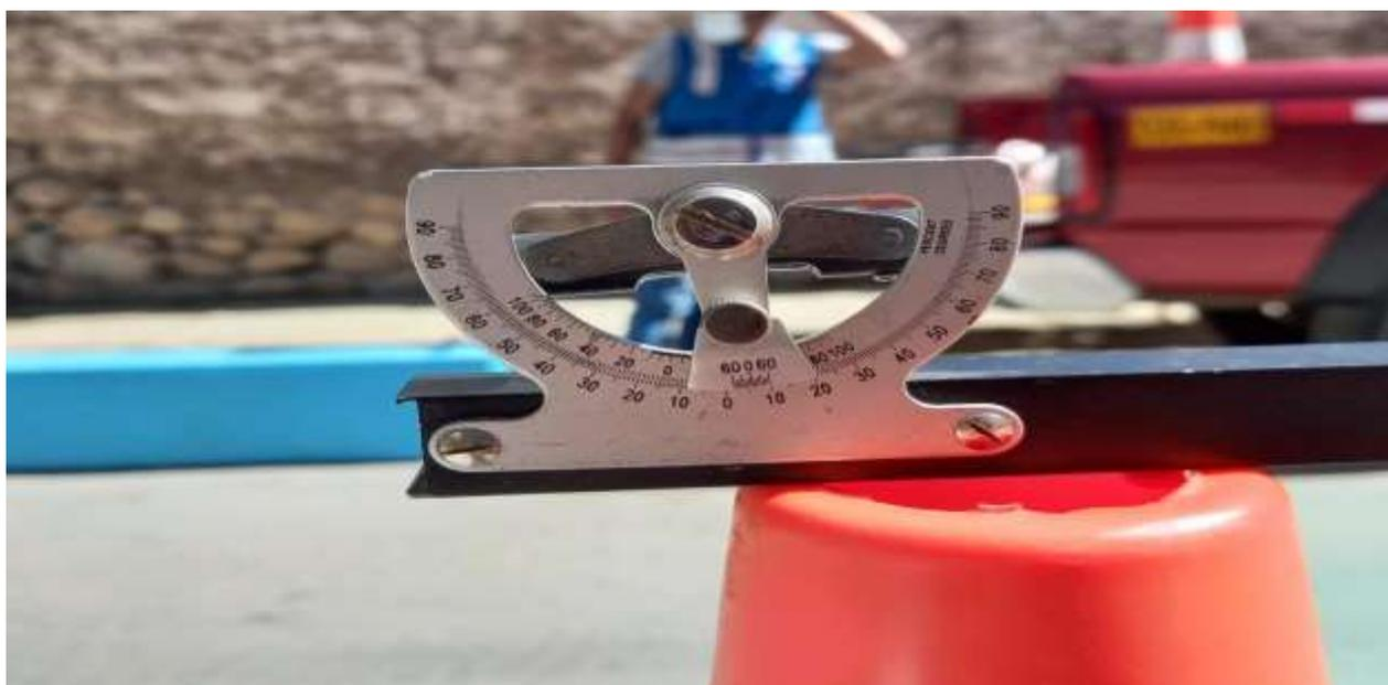
Figura N°03: lectura de pendiente por intermedio de un eclímetro
