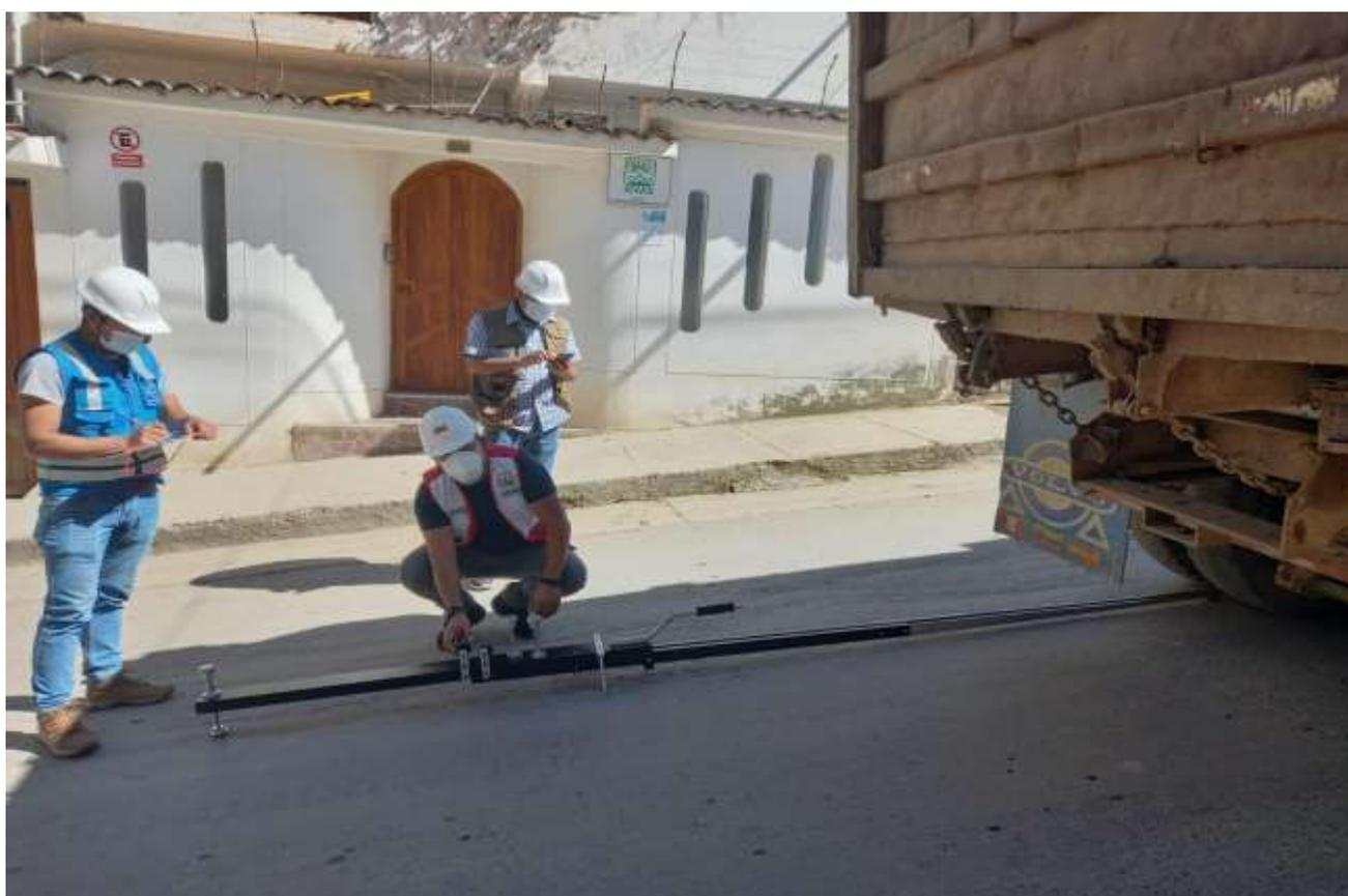
Figura N°04: Medición con viga Benkelman en eje de la zona de pendiente N°01.
