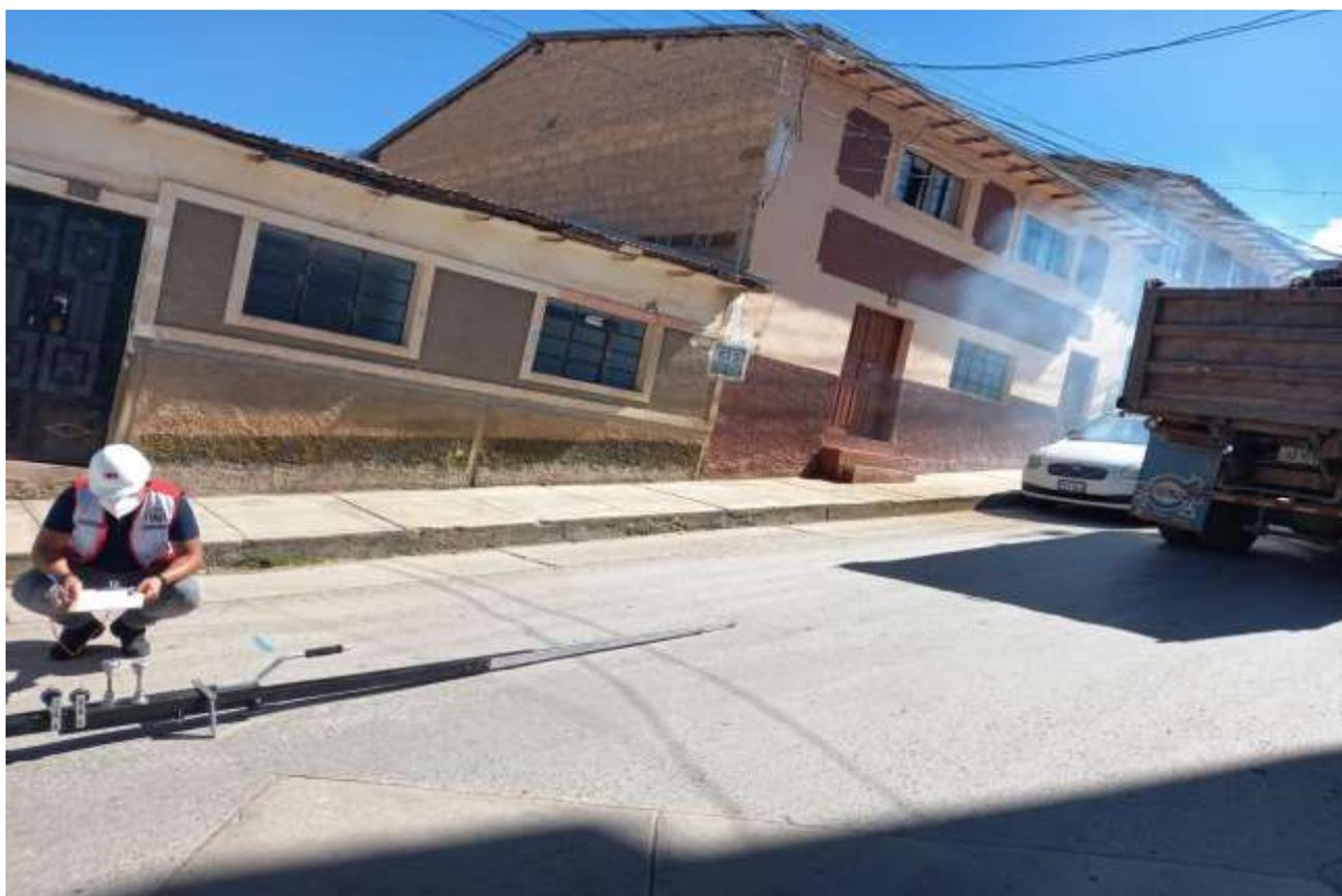
Figura N°05: lectura de diales de la deformación vertical en el carril izquierdo en zona de pendiente N°01
