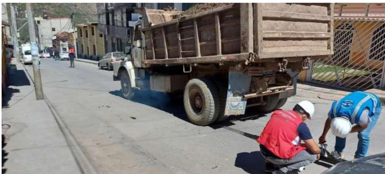
Figura N°07: Toma de lecturas de la viga Benkelman en carril izquierdo de la zona de pendiente n°03
