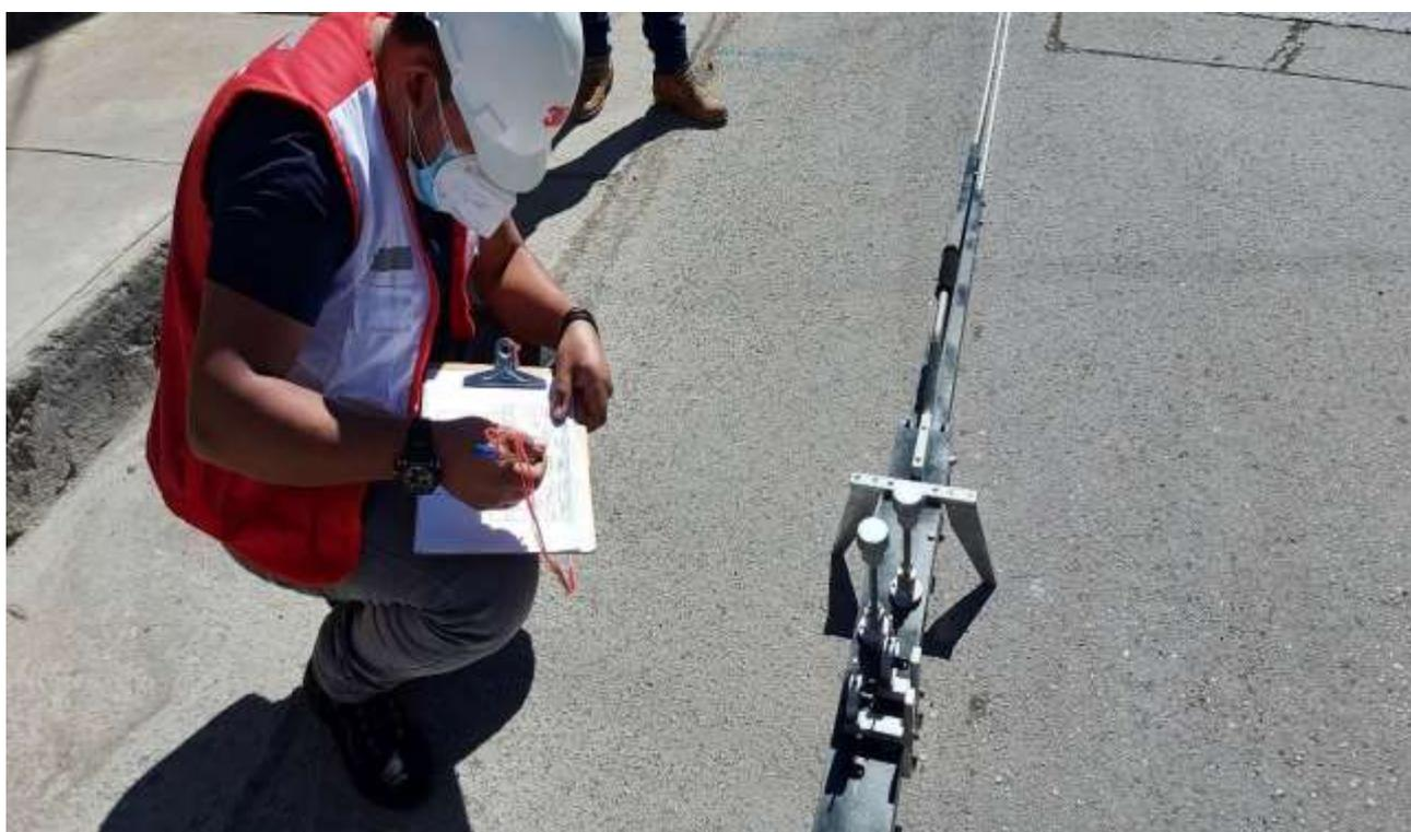
Figura N°06: Toma de lecturas de la viga Benkelman en el eje de la zona de pendiente n°02
