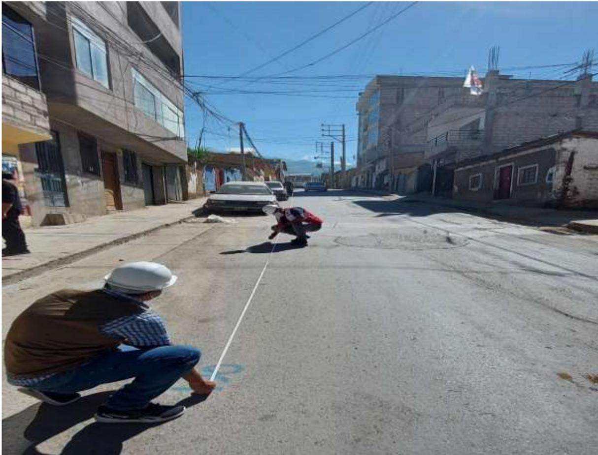
Figura N°9: Ubicación de los puntos a ser evaluados con la viga Benkelman.
