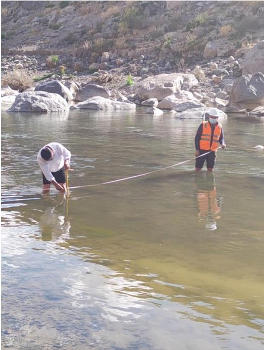
Foto N° 01 Se muestra la medición del río Colca para determinar el caudal fecha 07/2021
