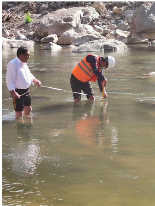
Foto N° 02 se aprecia la medición de la profundidad del río de fecha 07/2021
