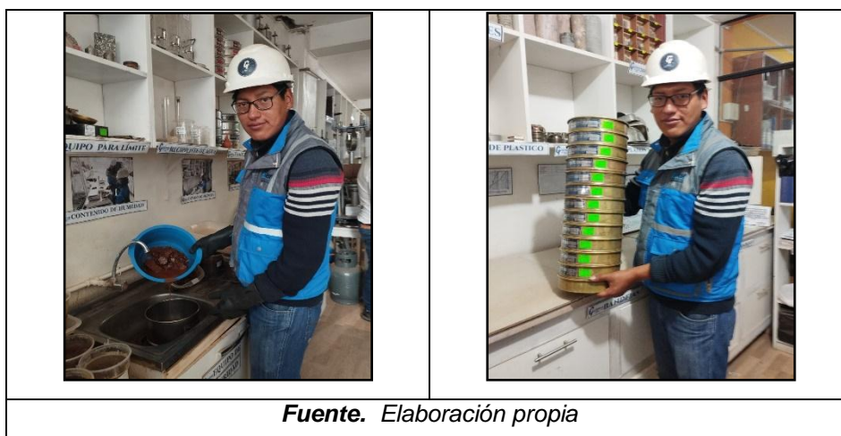
Figura 29. Ensayo de lavado y tamizado
