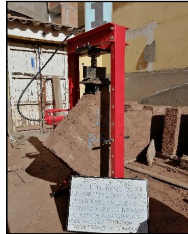
Fotografía 32: Ensayo de compresión al corte diagonal o tracción indirecta en muretes con adición de protectores faciales
