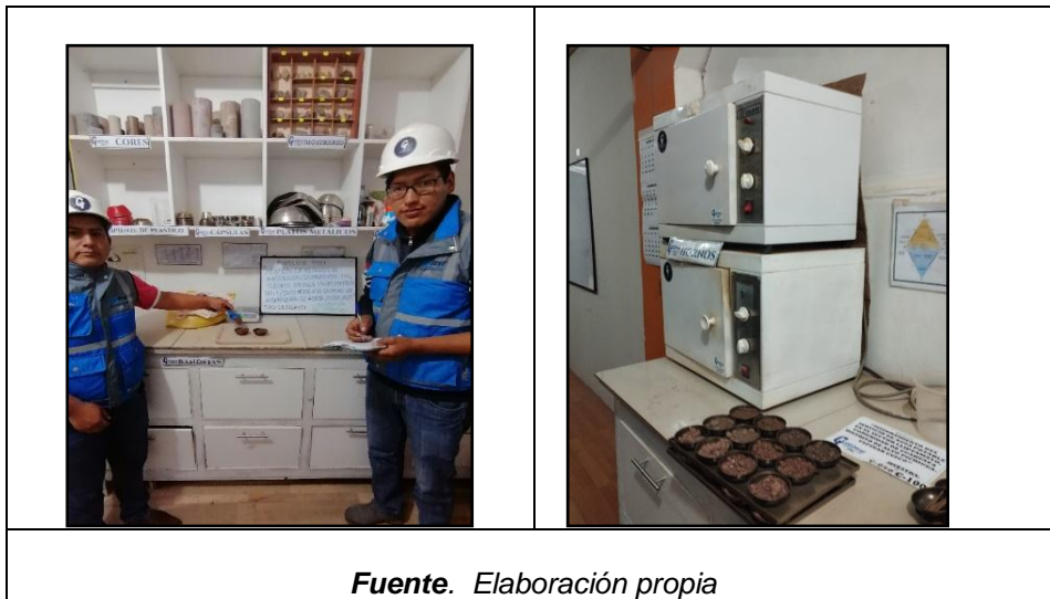
Figura 26. Ensayo de pruebas de contenido de humedad
