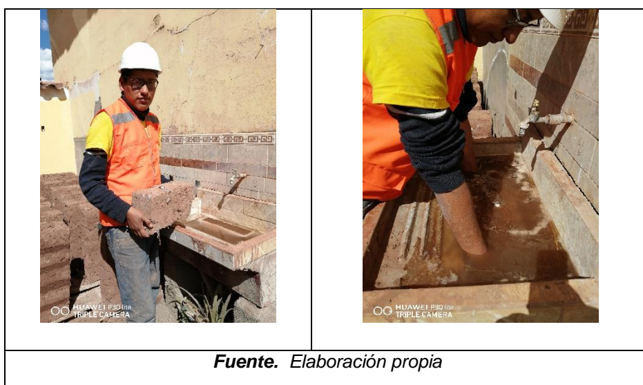
Figura 51. Ensayo de absorción del adobe
