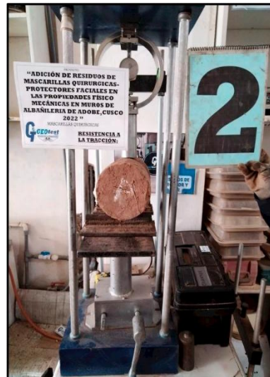
Fotografía 28: ensayo de tracción del adobe
