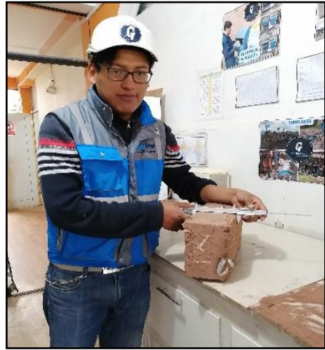
Fotografía 24: Ensayo de alabeo de adobes
