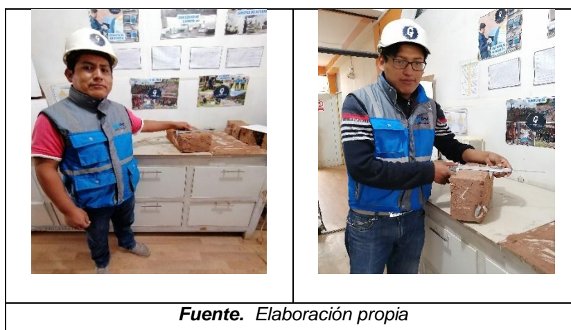
Figura 45. Ensayo de alabeo de adobes
