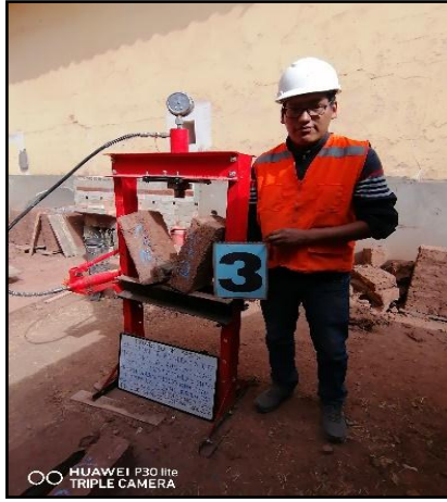
Fotografía 29: Ensayo de adherencia del mortero en el adobe con mascarillas quirúrgicas y protectores faciales
