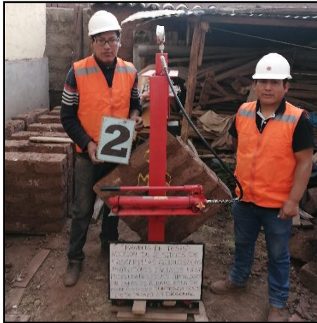
Fotografía 31: Ensayo de compresión al corte diagonal o tracción indirecta en muretes con adición de mascarillas quirúrgicas
