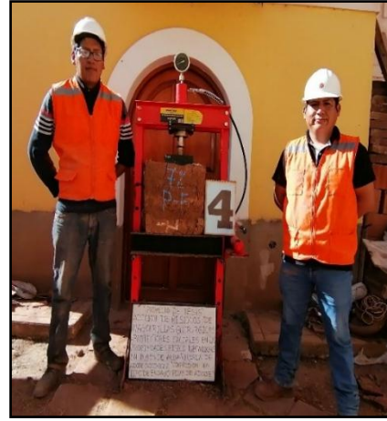
Fotografía 30: Ensayo de resistencia a la compresión axial de pilas con adición de mascarillas quirúrgicas y protectores faciales
