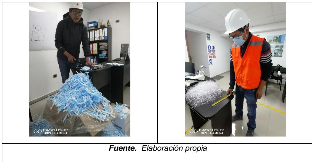
Figura 38. Triturado de mascarilla quirúrgica y protector facial
