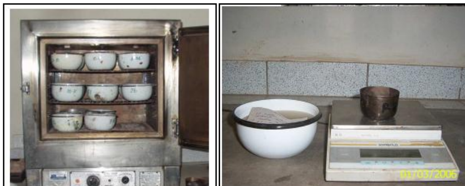
Figura 19. Prueba de contenido de humedad
