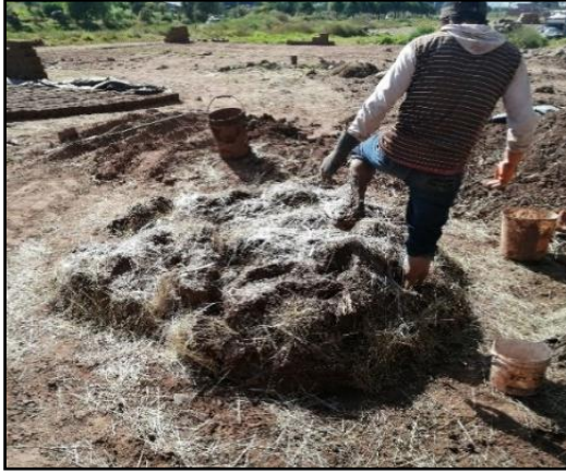
1. Fotografía 21: Mezclado del barro con los residuos de mascarillas quirúrgicas
