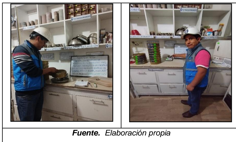
Figura 30. Ensayo de pesado retenido en cada tamiz
