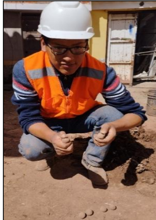
Fotografía 02: Prueba de aplastamiento de las bolitas una vez pasados las 48 horas de secado
