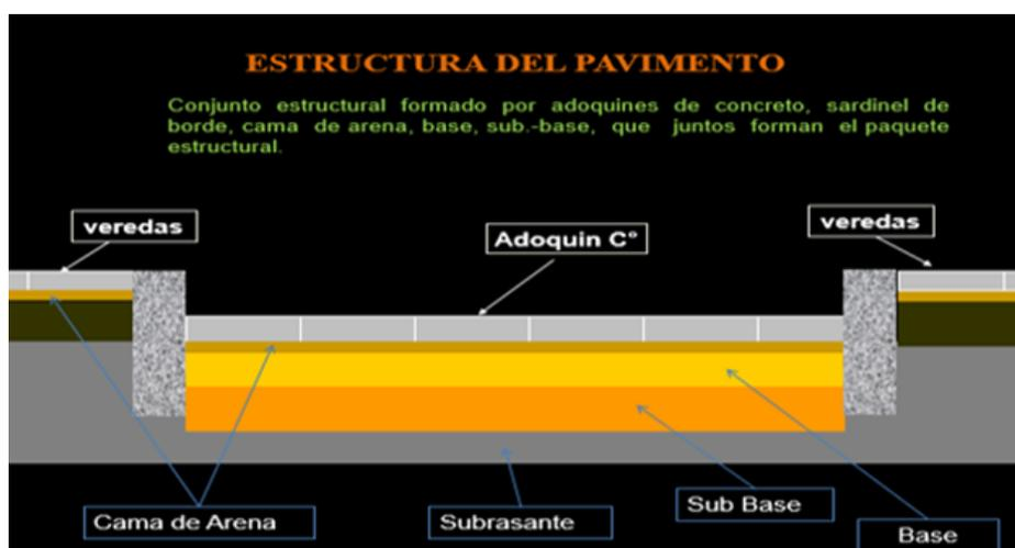
Figura N°1: Estructura de un pavimento adoquinado Inter trabado
