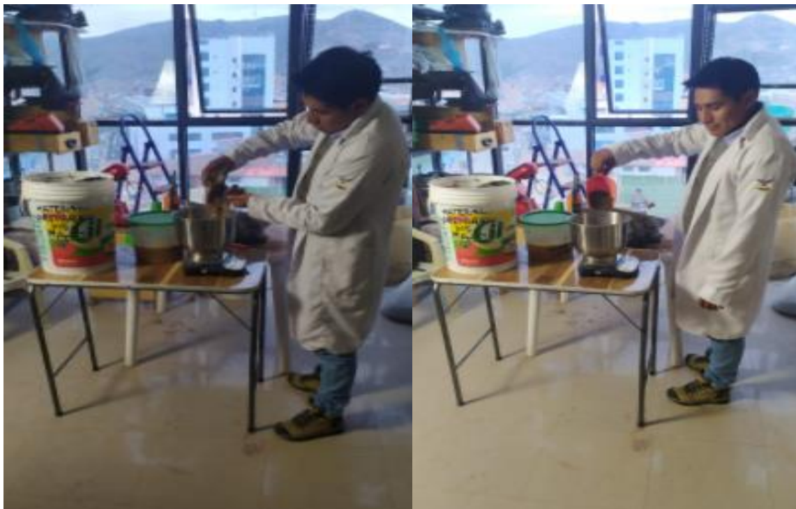
Figura 19: Se observa la dosificación con grasa porcina al suelo de pavimento peatonal del PAN Machupicchu.
