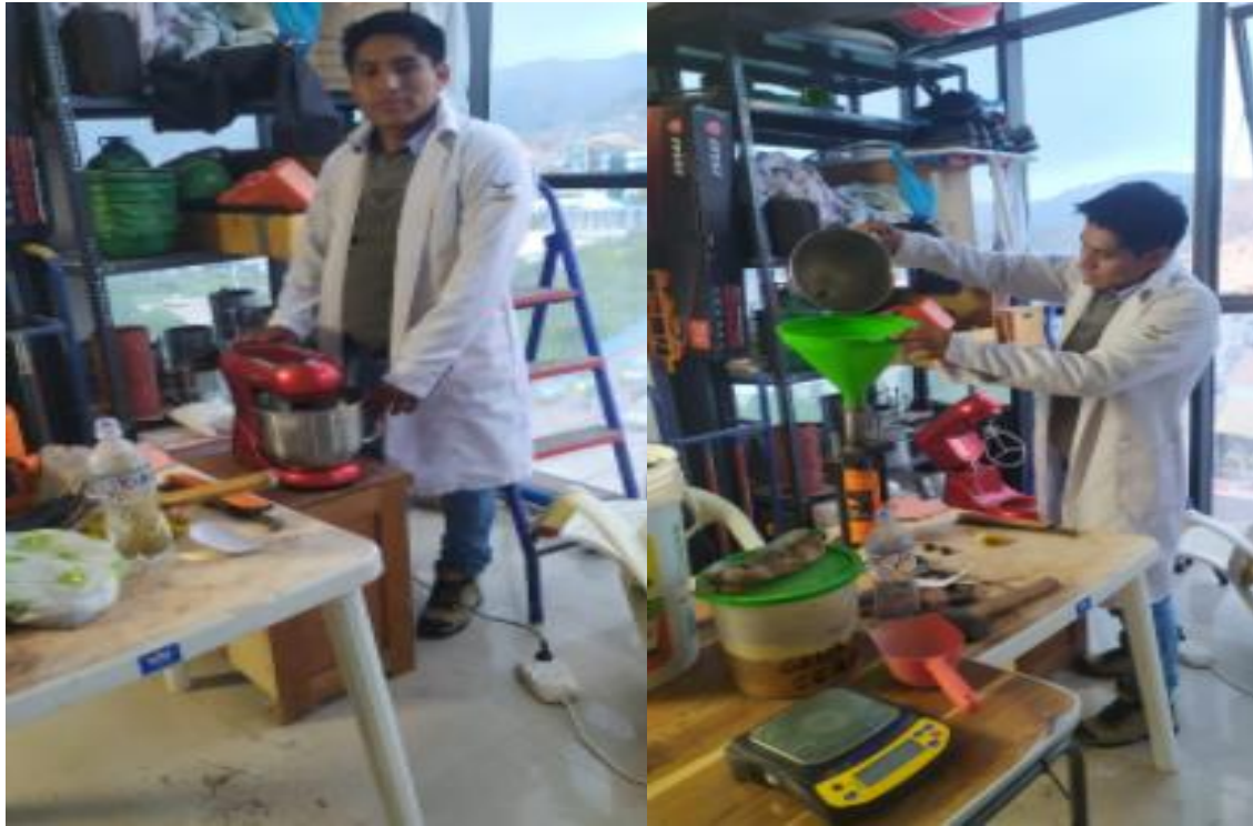
Figura 20: Se observa la mezcla del suelo con la gras porcina y preparación de pilotes del suelo de pavimento peatonal del PAN Machupicchu.
