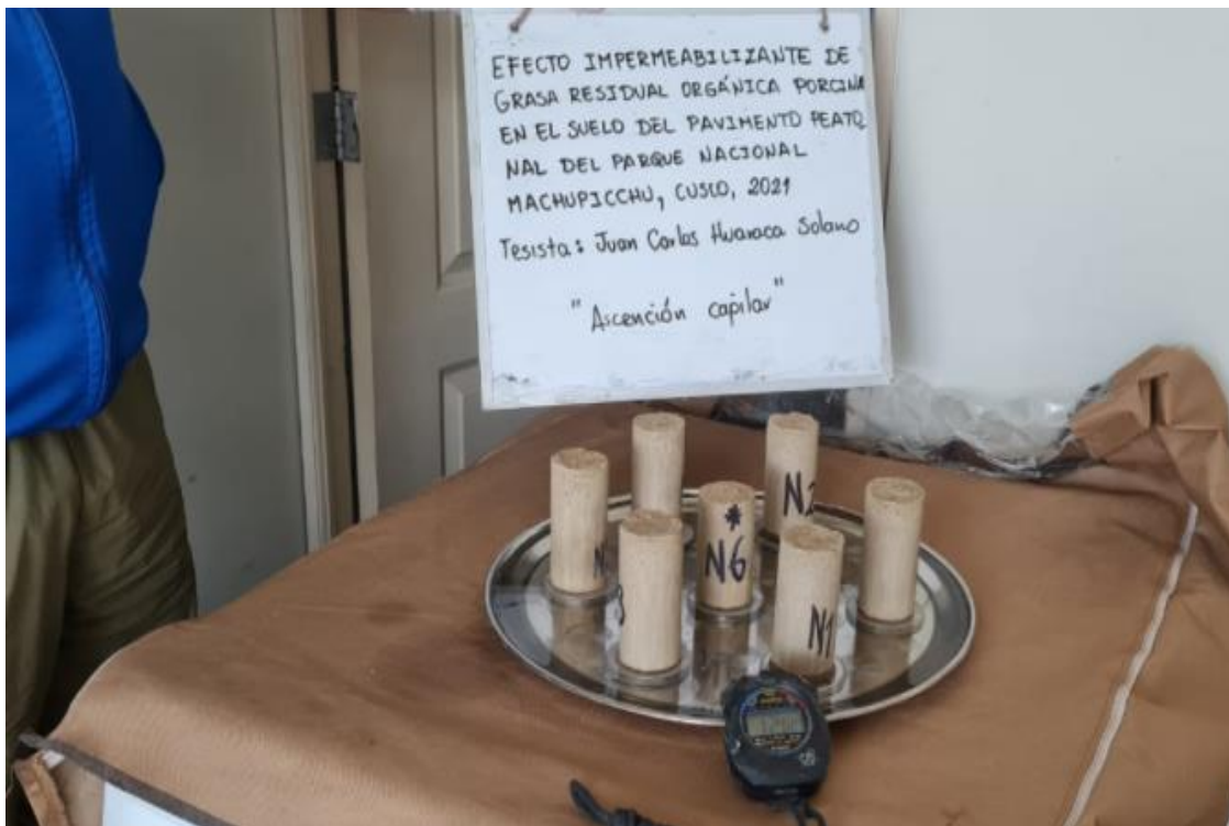
Figura 20: Se observa el ensayo de ascención capilar del suelo de pavimento peatonal del PAN Machupicchu.
