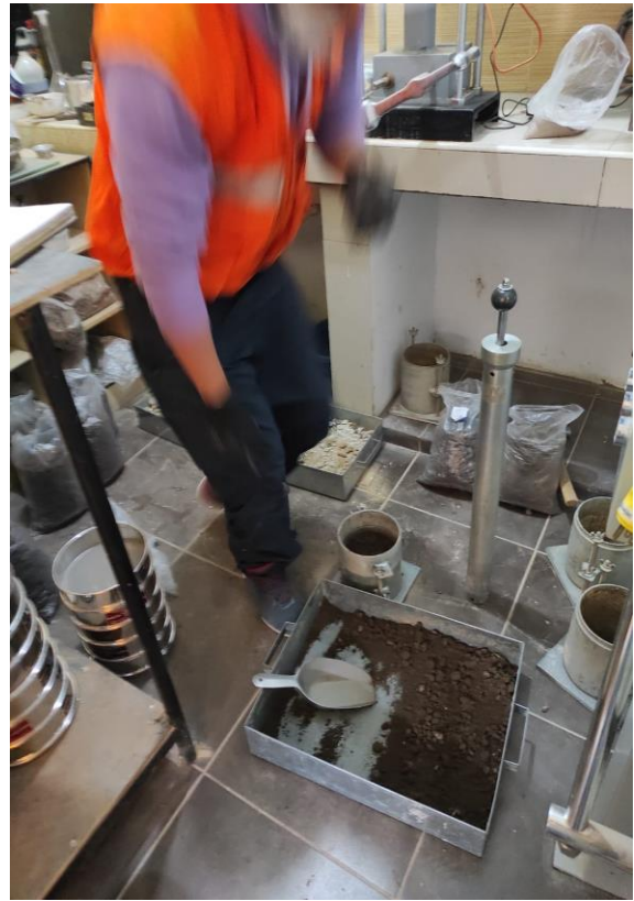
Imagen 24: Chancado con el pisón para el Proctor con el mucílago del nopal
