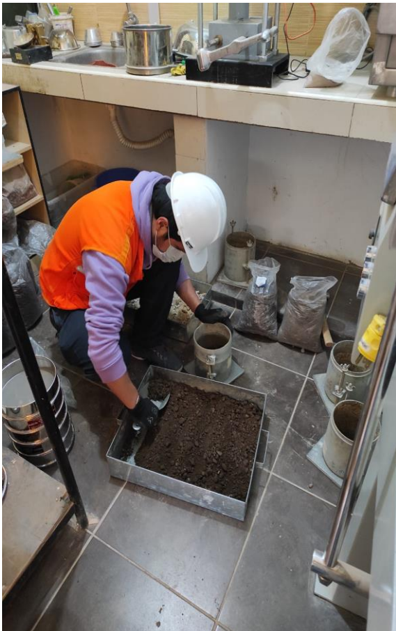
Imagen 13: Mesclado y colocado de la muestra para el CBR
