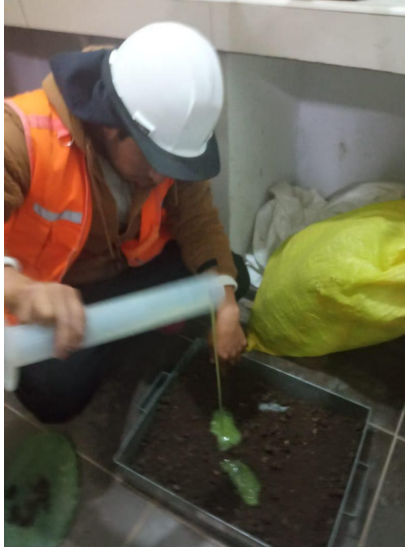
Figura 17. Ensayo de CBR con mucílago de la penca del nopal
