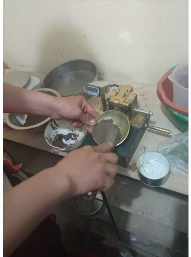
Imagen 8: Colocando la muestra en la copa de casa grande
