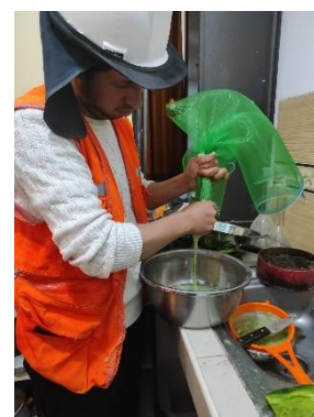
Figura 6. Extracción del mucílago con malla
