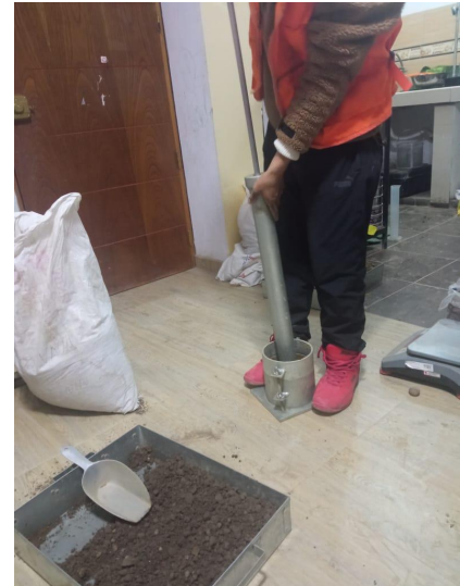
Figura 18. Chancado para determinar el grado de compactación
