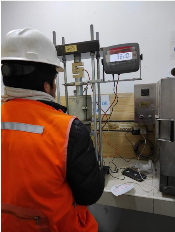
Imagen 15: prensado para ver el grado de penetración
