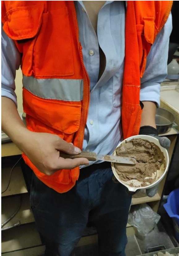
Imagen 7: Mesclado de la muestra para el límite líquido
