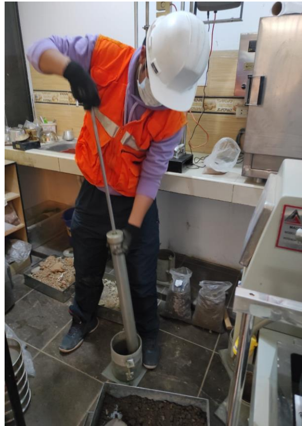
Imagen 12: Chancado con el pisón para el Proctor
