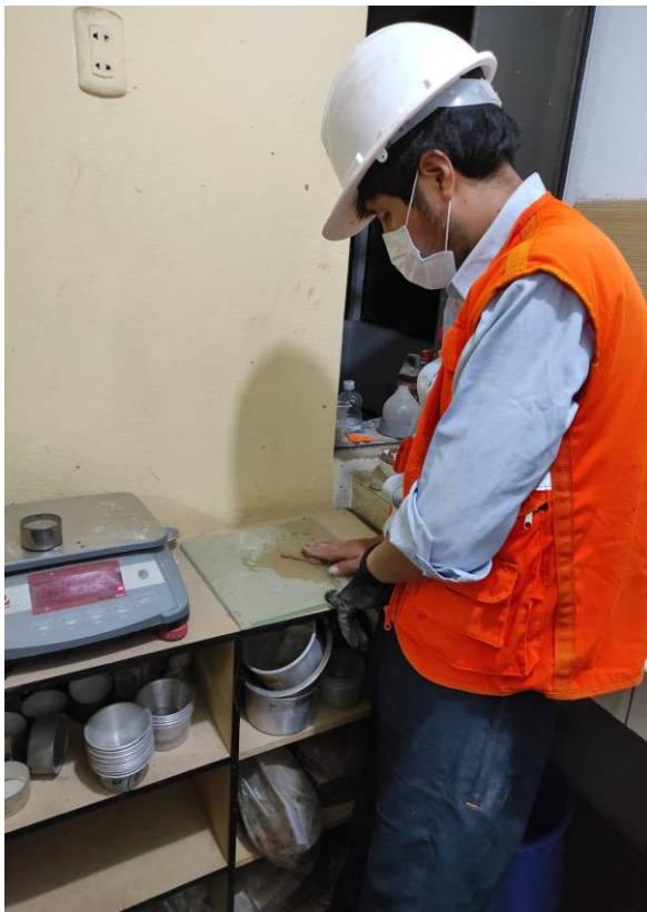
Imagen 9: Realizando los gusanos para el límite plástico
