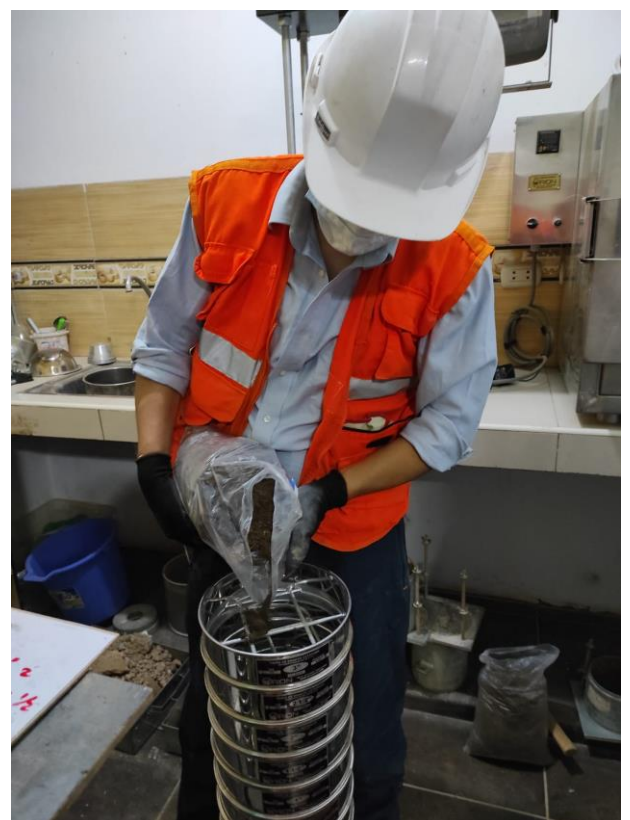
Imagen 6: Pasando por los tamices la muestra obtenida
