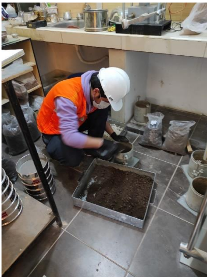
Figura 14. Ensayo del Proctor de densidad máxima seca y el contenido de humedad optimo
