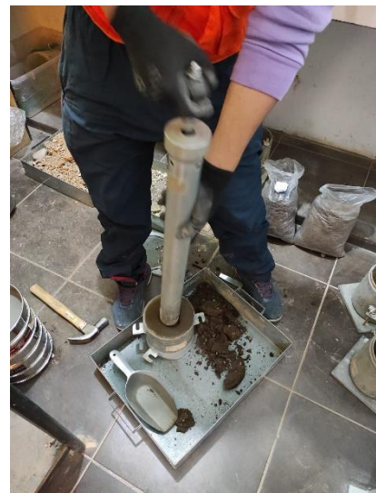
Figura 15. Chancado del pisón para la compactación en el Proctor
