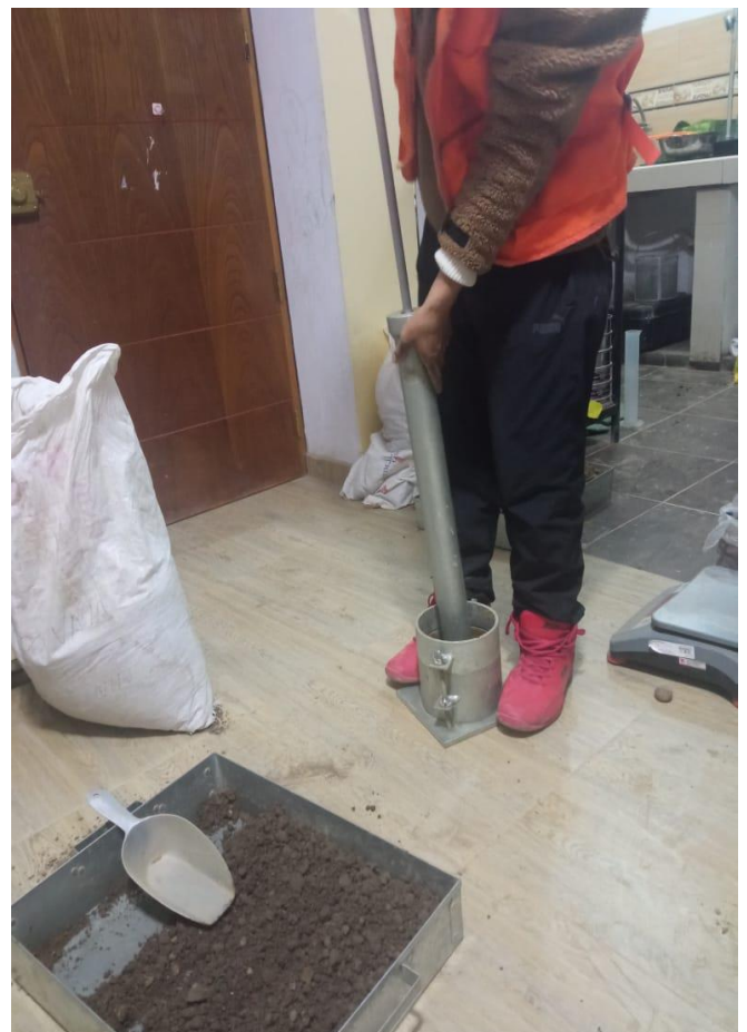
Imagen 22: Chancado con el pisón para el Proctor con el mucílago del nopal
