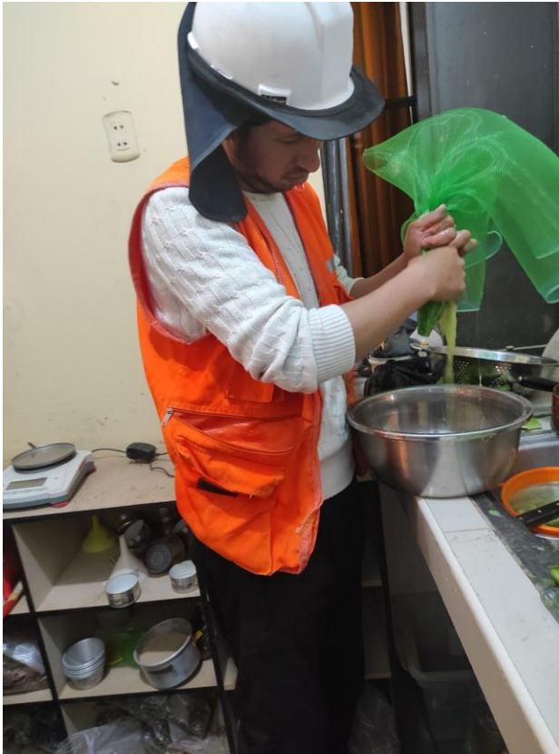
Imagen 19: Extracción del mucílago del nopal por la malla
