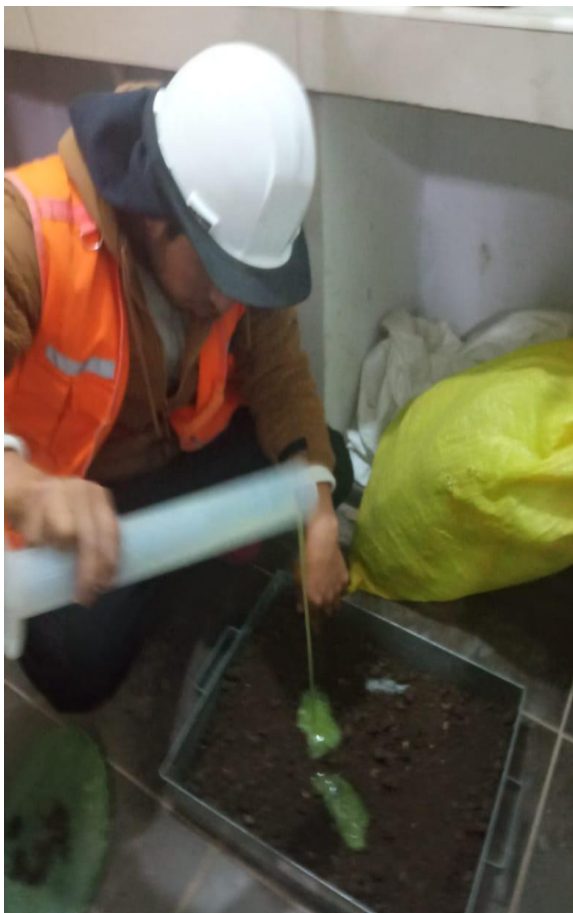
Imagen 21: Mezclado de mucílago del nopal con la muestra patrón
