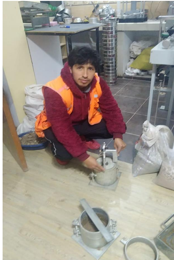
Imagen 14: Colocación del dial para la expansión
