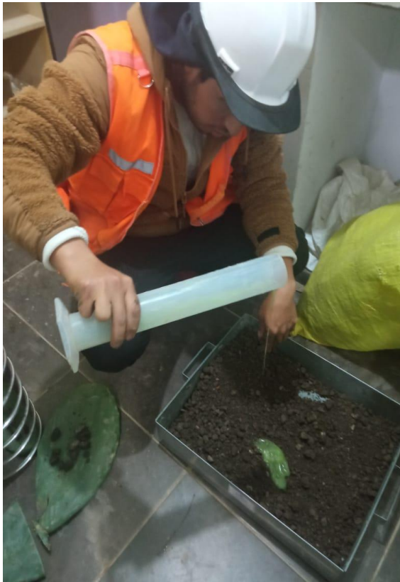
Imagen 23: Mesclado del mucílago para el CBR
