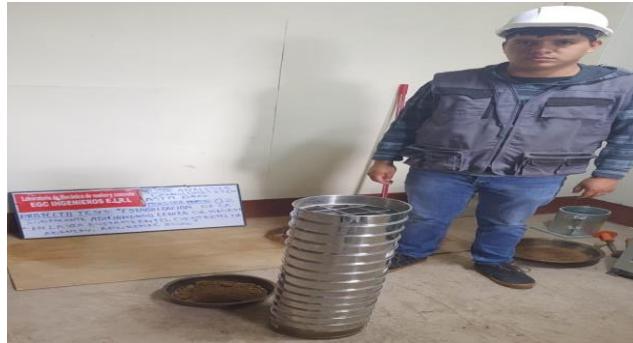
Figura 11: Ensayo análisis granulométrico por tamizado ASTM D-422
