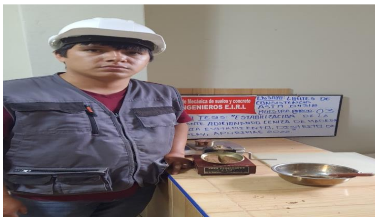
Figura 25: Determinación del límite líquido de un suelo por el método de Casagrande
