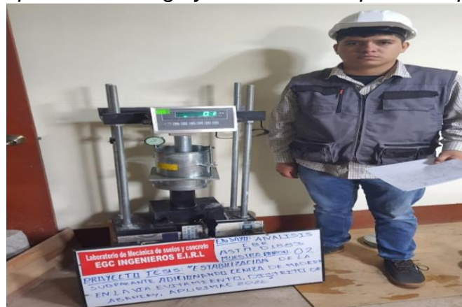
Figura 34: Dispositivo de carga y colocación del pistón de penetración
