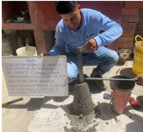
Figura 12: Ensayo de asentamiento patrón.
