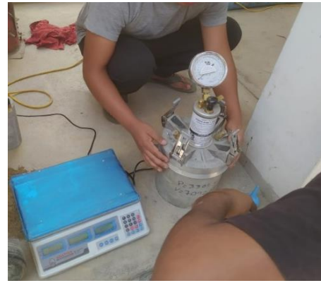
Figura 19: Equipos para el ensayo de contenido de aire
