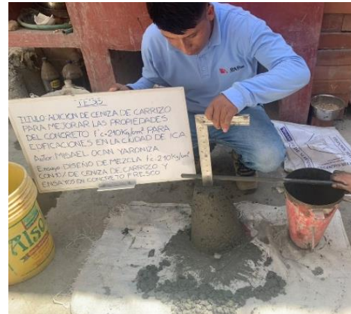
Figura 13: Equipos de ensayo de asentamiento.
