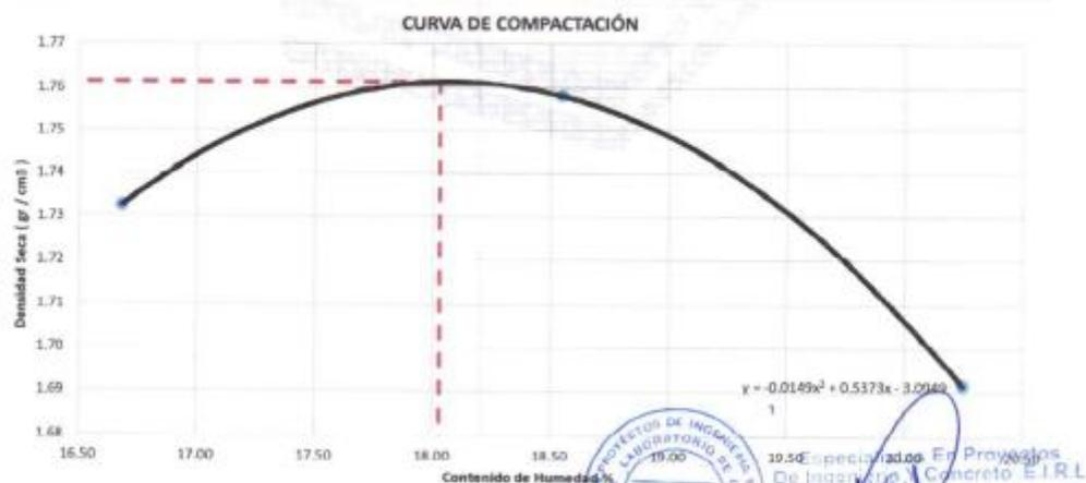
**ENSAYO DE COMPACTACIÓN PROCTOR MODIFICADO
