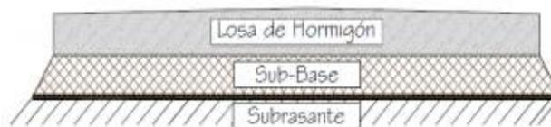
*Figura 1:* Sección transversal típica de pavimento rígido.
