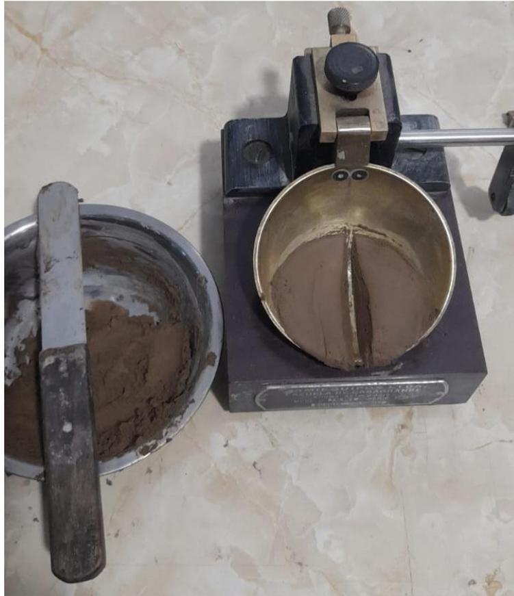
MUESTRA EN ENSAYO DE LIMITE LIQUIDO
