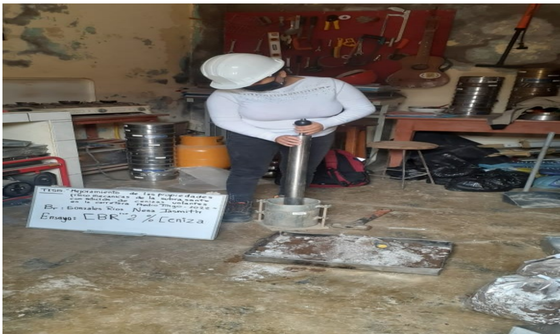
Figura 22: Compactación de suelo con adición de ceniza volante 2%
