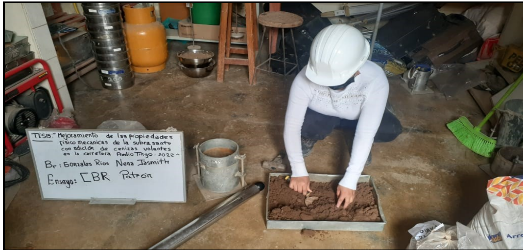
Ensayo CBR, división de muestra en 5 partes
