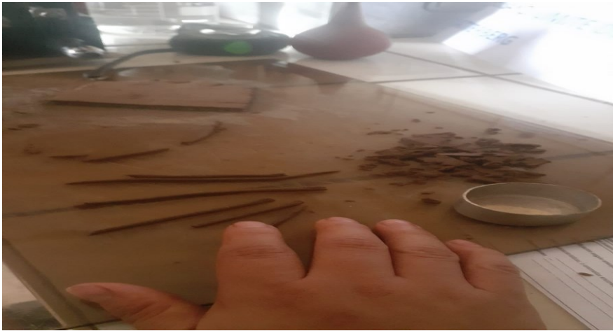
Figura 12: Ensayo límite plástico realizando los rollitos lo más delgado (3mm) con ayuda de la mano sobre lámina de vidrio
