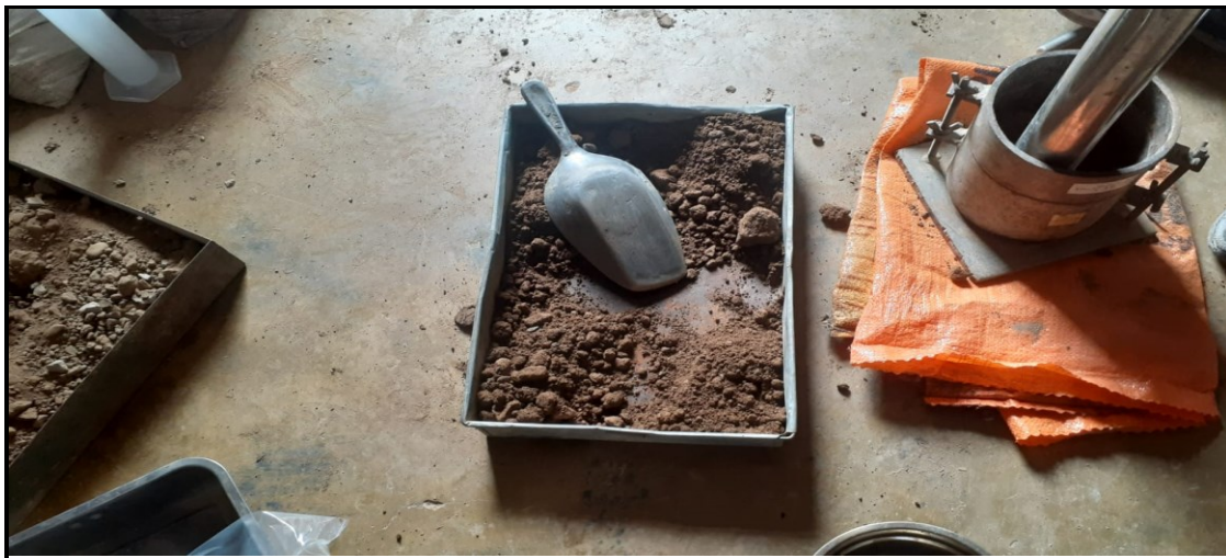
Ensayo Proctor, división en 5 partes iguales la muestra para introducir al molde
