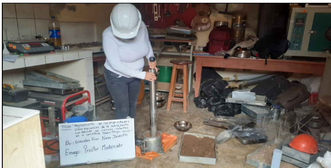
Compactación de muestra en molde con 56 golpes cada capa con el pison
