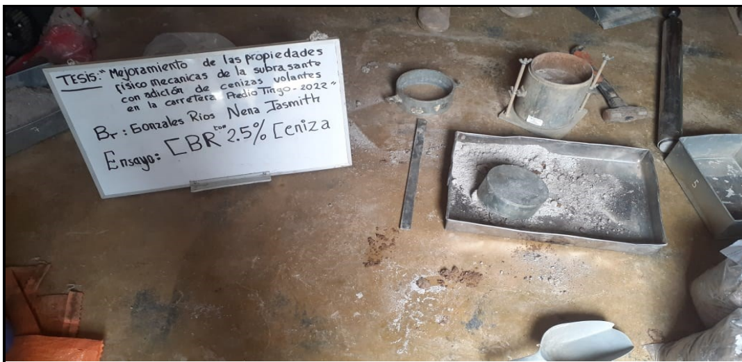
Ensayo CBR 2.5% de ceniza volante que se mezclará con el material para compactar
