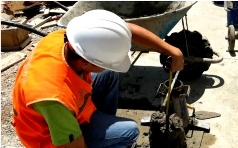
Foto 06: realizando la prueba del Slump.
