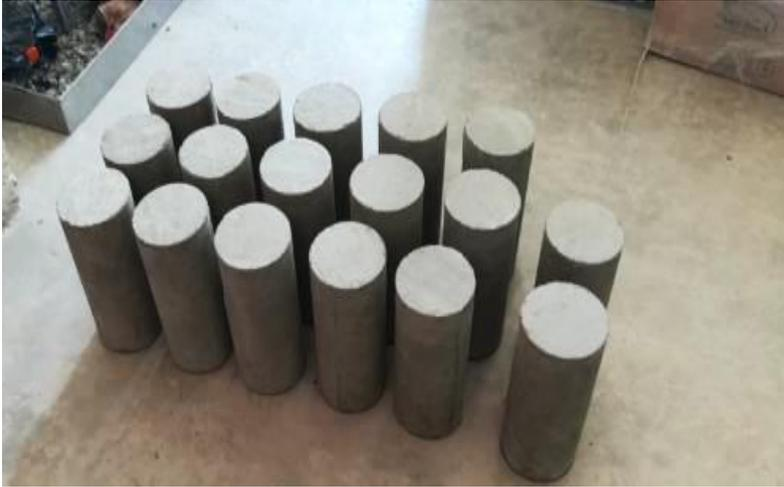
Foto 05: las probetas realizadas para el curado respectivo
