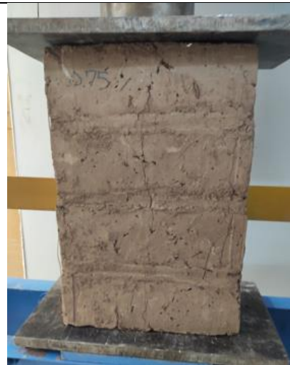
Fotografía 24: Resultado luego de someter a compresión axial en pilas.
