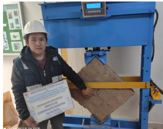
Fotografía 28: Resultado luego de someter a compresión diagonal, se puede observar la falla producida.
