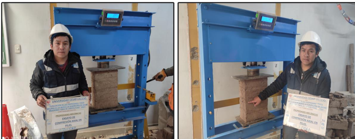
Figura 51: Ensayo de compresión axial en pilas de adobe.
