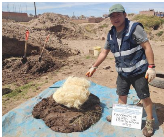
Fotografía 07: Mezcla de proporciones con fibra de cabuya para elaboración de muestras de 30x15x10cm.
