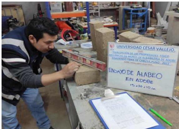
Fotografía 11: Ensayo de alabeo
