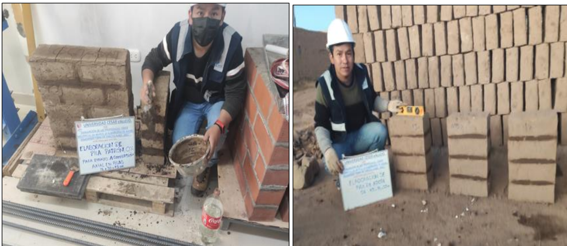
Figura 34: Elaboración de pilas y muretes de adobe de 30x15x10 cm con 0.0%, 0.5 %, 0.75 % y 1.00 % de dosificación.
