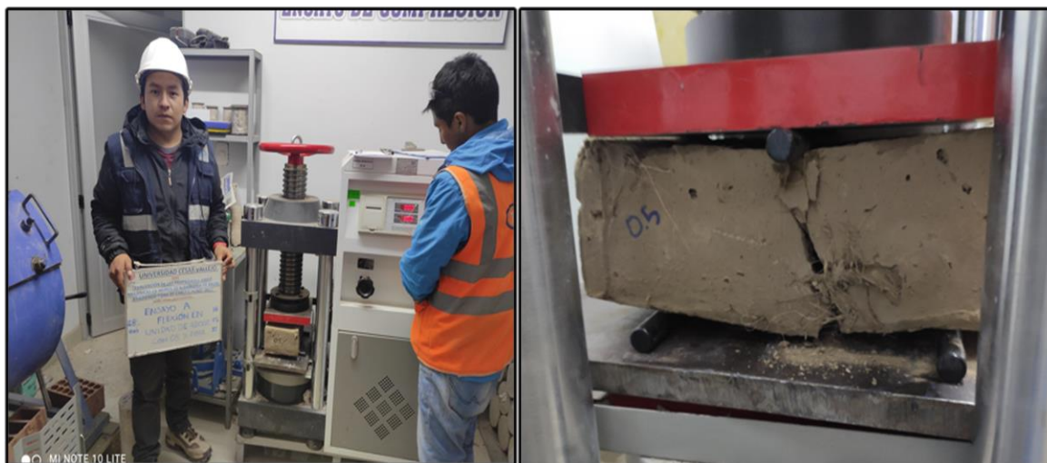
Figura 49: Ensayo de resistencia a la flexión en unidades de adobe.
