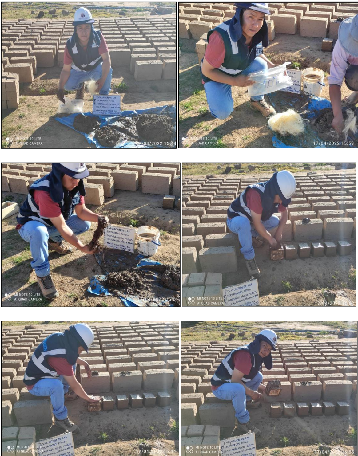
Figura 32: Elaboración de cubos de adobe de 10x10x10 cm con 0.0%, 0.5 %, 0.75 % y 1.00 % de dosificación.
