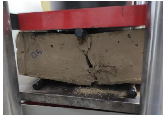
Fotografía 18: Cubos de 10 cm de arista luego de ensayo simple a compresión.
