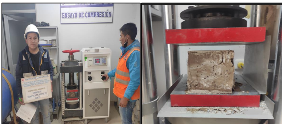
Figura 48: Compresión simple en unidades de adobe de 10 cm de arista.
