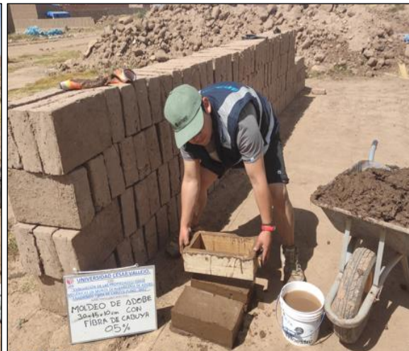
Figura 33: Elaboración de cubos de adobe de 30x15x10 cm con 0.0%, 0.5 %, 0.75 % y 1.00 % de dosificación.
