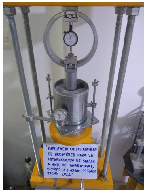
Ensayo de CBR
