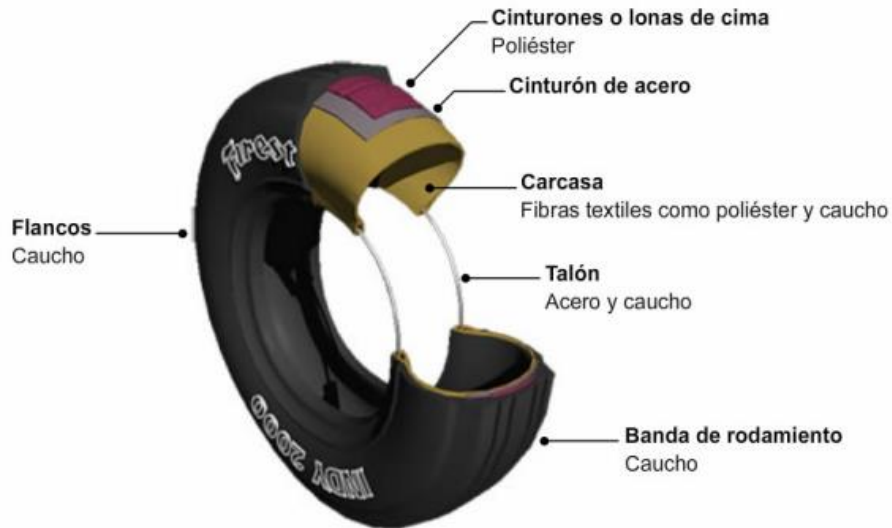
Figura 1. Esquema de las partes de un neumático comercial
