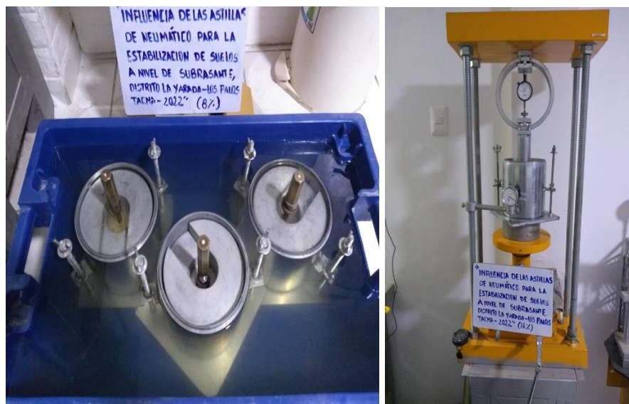
Figura 27. Ensayos de California Bearing Ratio con astillas de neumáticos de 8% y 16%.
