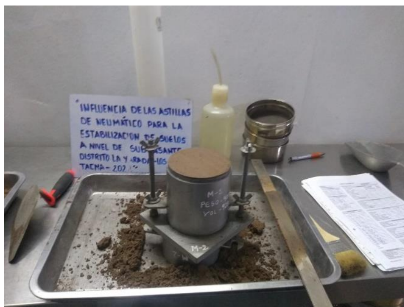
Figura 19. Proceso de Proctor modificado de la muestra natural de C-01 Fuente: Elaboración propia
