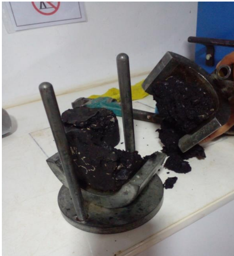
Figura 39: Rotura de briqueta en el ensayo Marshall
