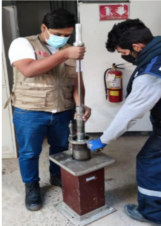
Figura 34: Compactación de la briqueta
