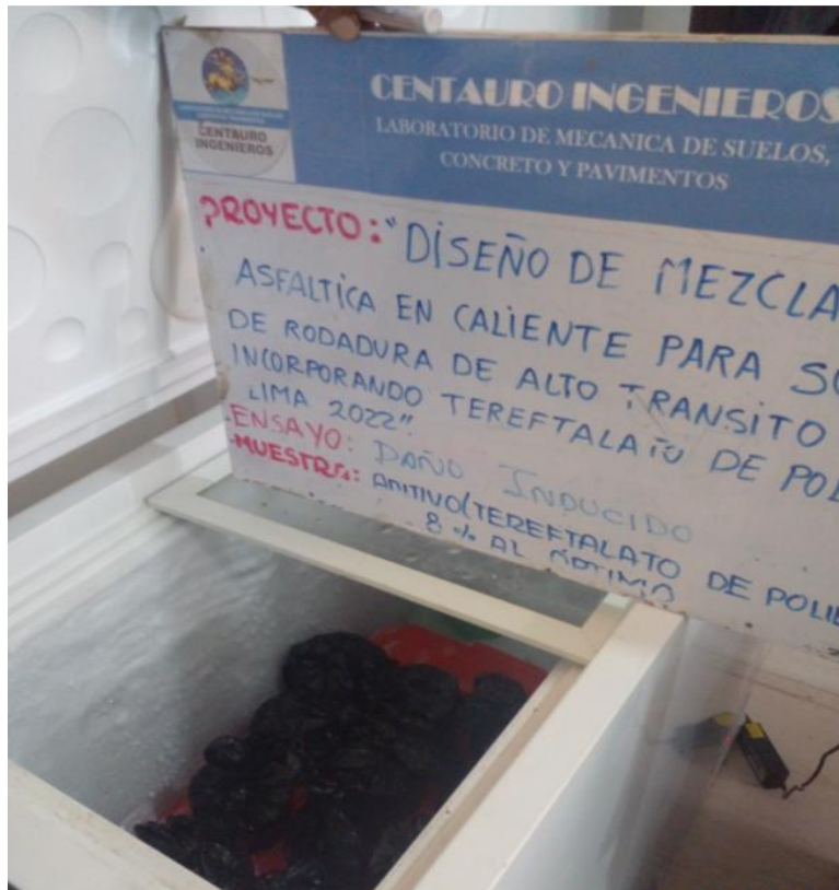
Figura 40: Ensayo resistencia al daño inducido
