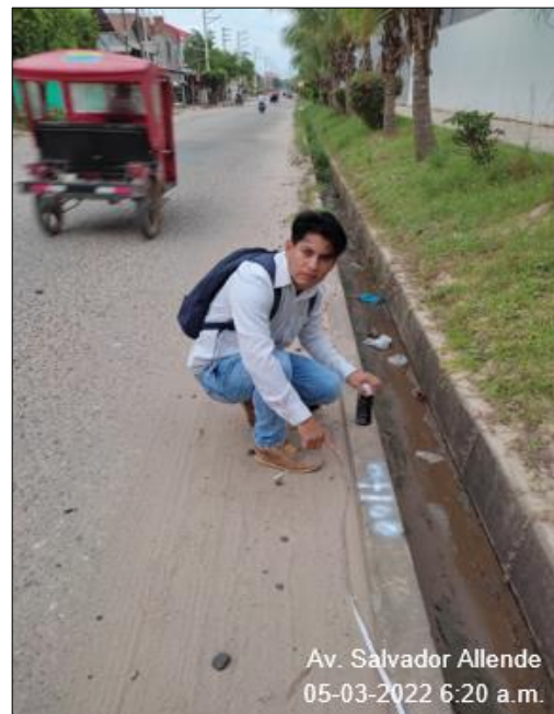
Fotografía 04. Enumerando las progresivas a cada 100 metros según el método "VIZIR" del 0+000 al 0+100
