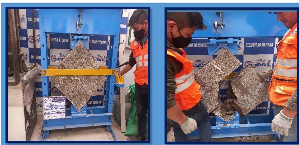
Figura 22. Ensayo a compresión diagonal de muretes Fuente: Elaboración propia.
