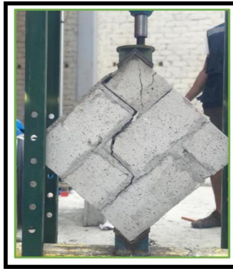
Figura 3. Resistencia a la compresión Diagonal de muretes (Akarley D. y Florian, C., 2019)
