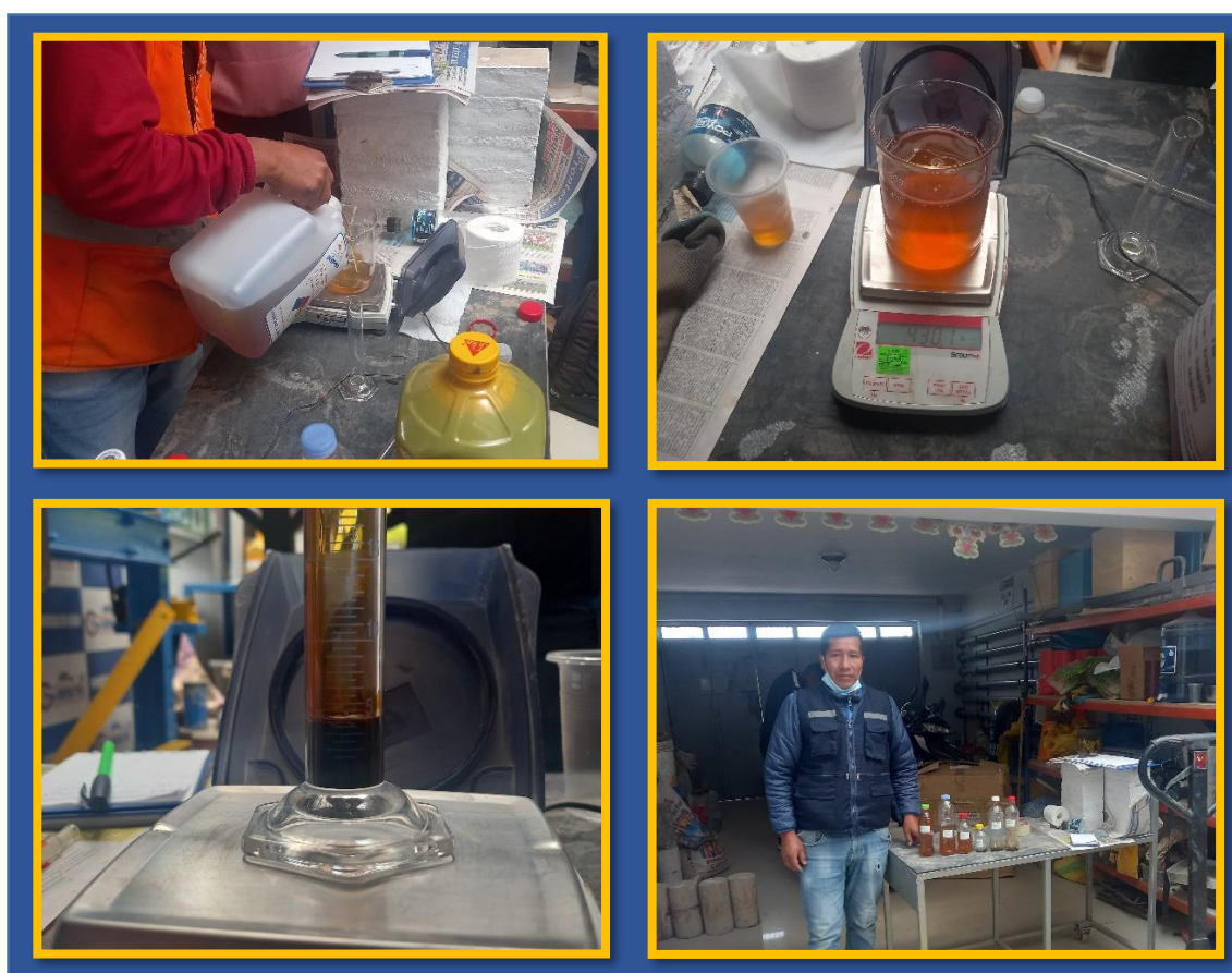
Figura 13. Dosificación de aditivos en laboratorio Fuente: Elaboración propia
