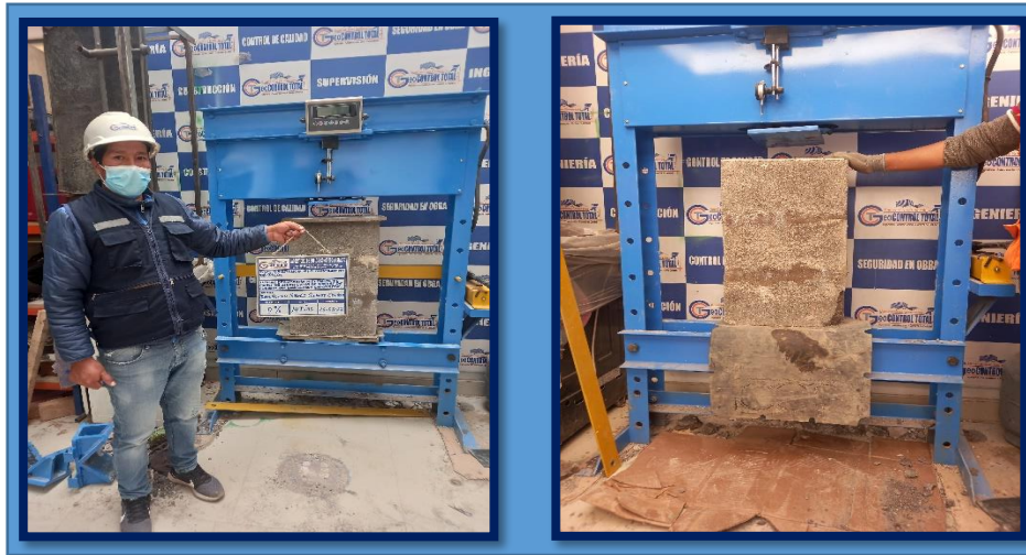
Figura 24. Ensayo a la compresión axial de pilas Fuente: Elaboración propia
