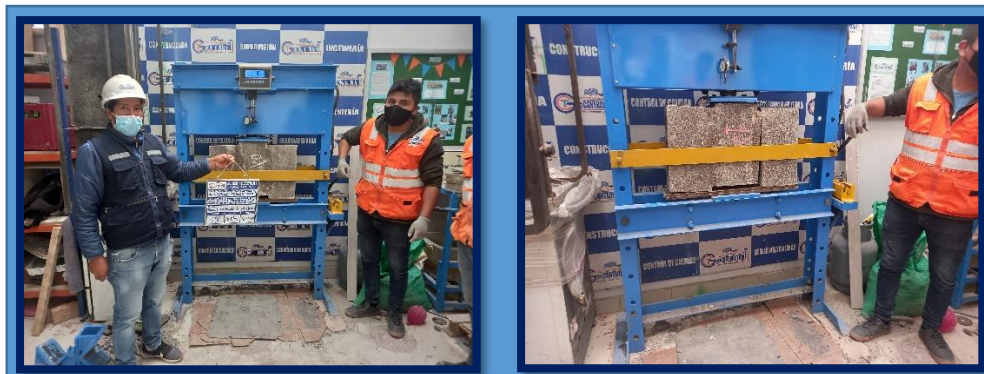
Figura 25. Ensayo a compresión adherencia al Cizalle Fuente: Elaboración propia
