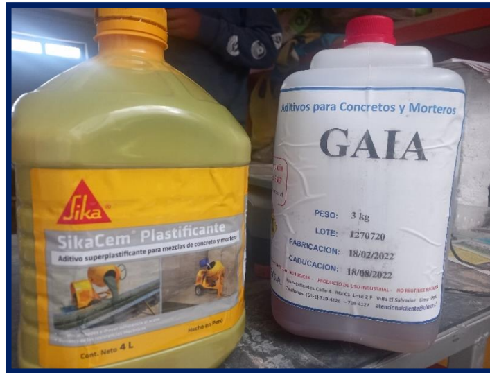
Figura 5. Aditivos GAIA nanosilice y SIKACem Superplastificante Fuente: elaboración propia
