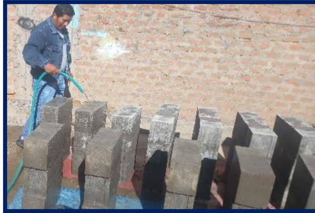
Figura 20. Curado de especímenes Fuente: Elaboración propia
