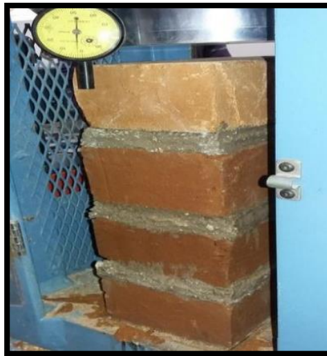
Figura 2. Resistencia a la compresión de pilas (GUEVARA , 2015)
