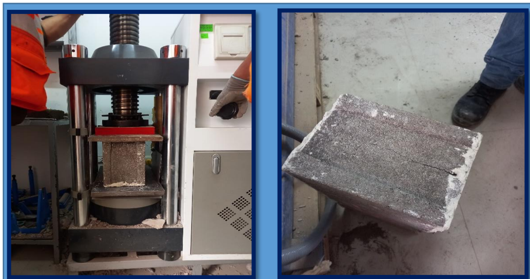
Figura 21. Ensayo a compresión axial de unidades estructurales Fuente: Elaboración propia.
