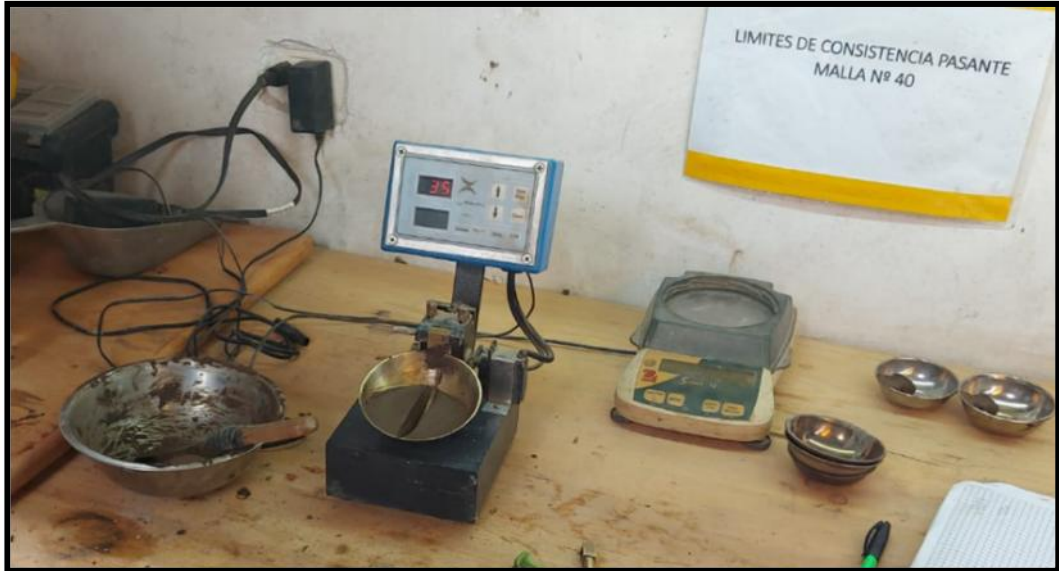
Fotografía N° 03: Realización del ensayo de limite liquido de la muestra natural
