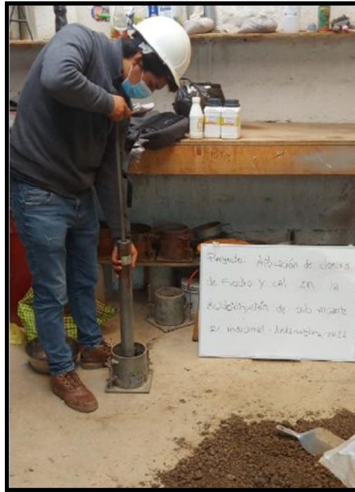
Fotografía N° 05: Proceso de compactación, ensayo proctor modificado
