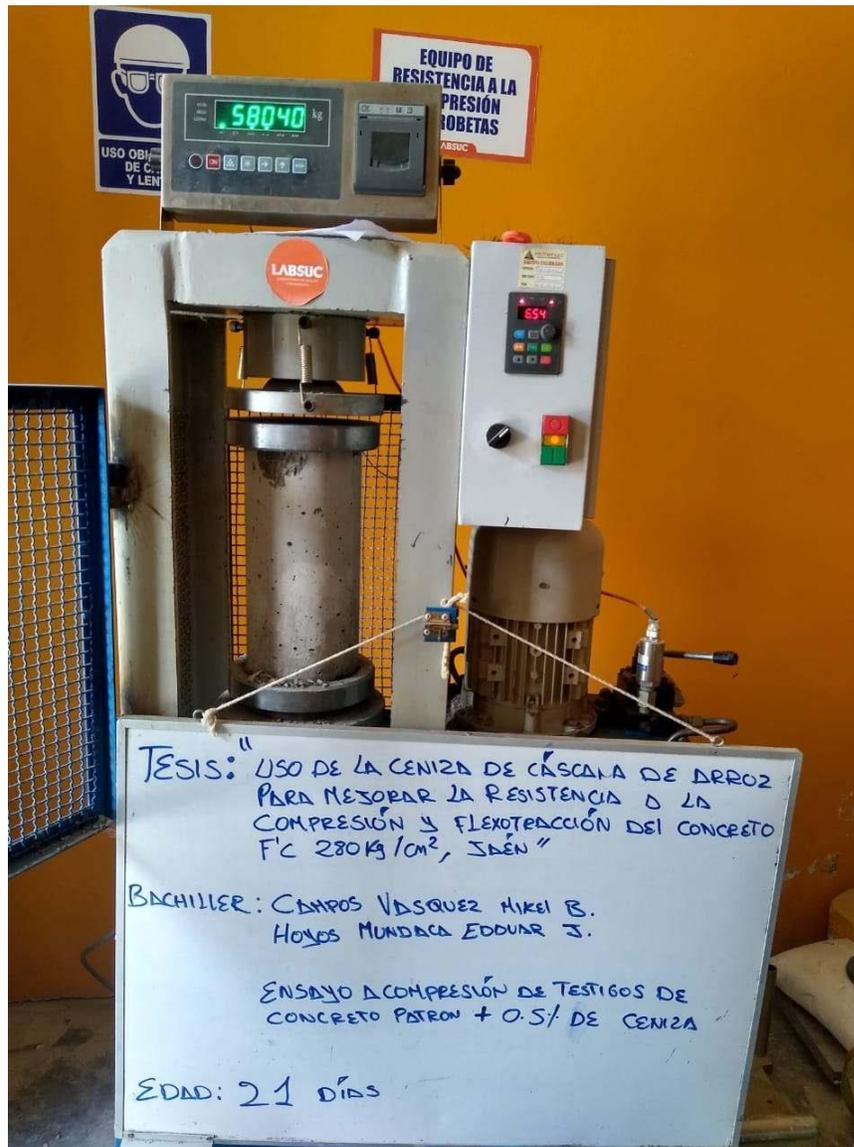
**FOTOGRAFIA 08:** Ensayo a compresión de testigos de concreto bajo la norma ASTM C39 de la muestra de concreto patrón adicionando el 0.5 % de ceniza a los 21 días del Proyecto Tesis: "Uso De Ceniza De Cascara De Arroz Para Mejorar La Resistencia A La Compresión Y Flexotracción Del Concreto F´C 280 Kg/Cm2"
