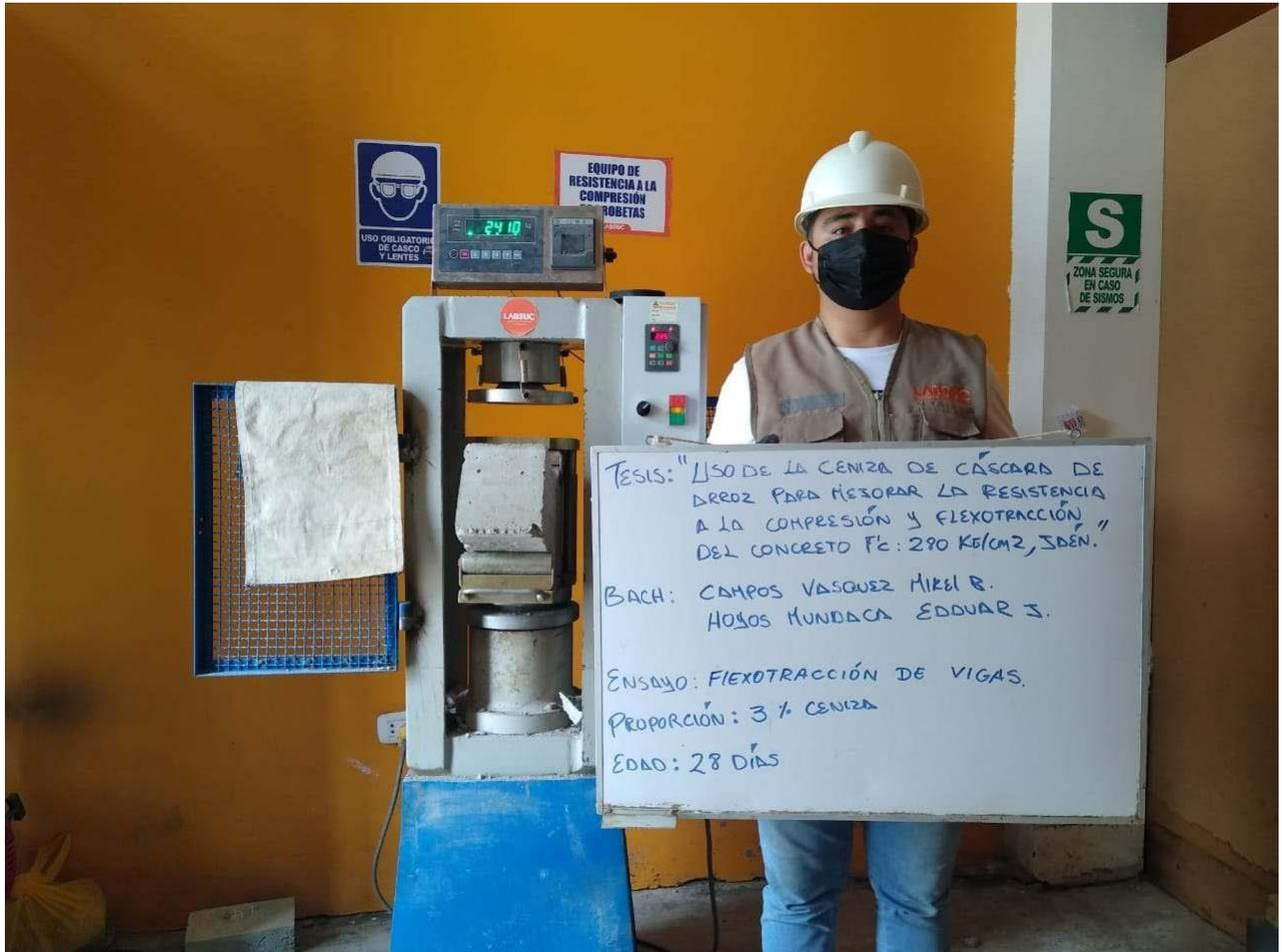
**FOTOGRAFIA 45:** Ensayo a Resistencia A La Flexión Del Concreto Endurecido ASTM C78 de la muestra de concreto patrón adicionando el 3 % de ceniza a los 28 días del Proyecto Tesis: "Uso De Ceniza De Cascara De Arroz Para Mejorar La Resistencia A La Compresión Y Flexotracción Del Concreto F´C 280 Kg/Cm2"
