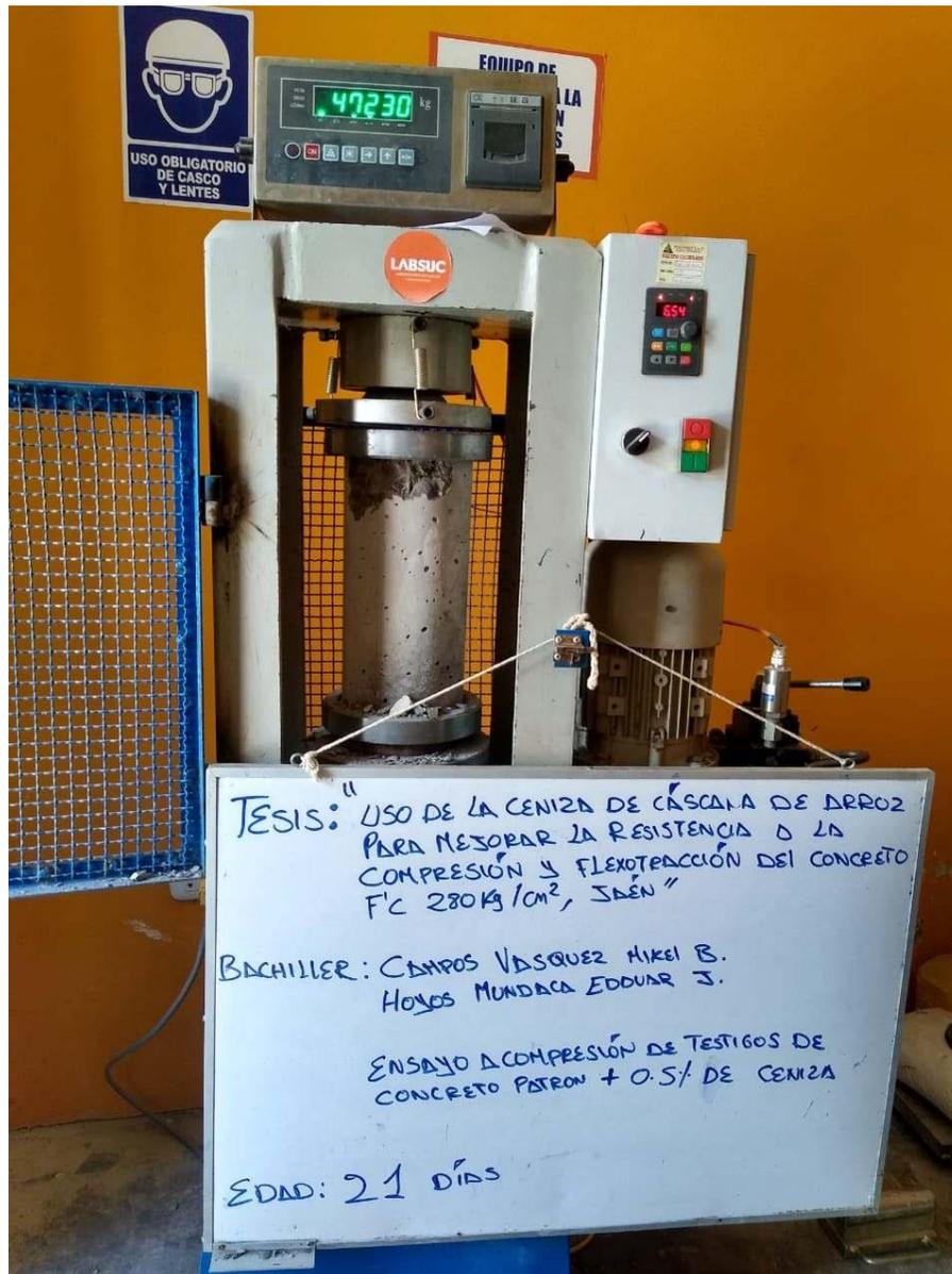
**FOTOGRAFIA 10:** Ensayo a compresión de testigos de concreto bajo la norma ASTM C39 de la muestra de concreto patrón adicionando el 0.5 % de ceniza a los 21 días del Proyecto Tesis: "Uso De Ceniza De Cascara De Arroz Para Mejorar La Resistencia A La Compresión Y Flexotracción Del Concreto F´C 280 Kg/Cm2"
