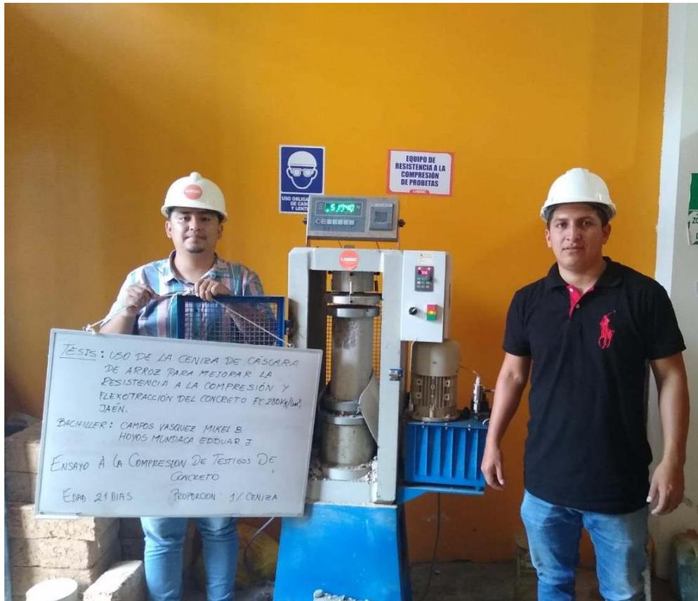
**FOTOGRAFIA 15:** Ensayo a compresión de testigos de concreto bajo la norma ASTM C39 de la muestra de concreto patrón adicionando el 1 % de ceniza a los 21 días del Proyecto Tesis: "Uso De Ceniza De Cascara De Arroz Para Mejorar La Resistencia A La Compresión Y Flexotracción Del Concreto F´C 280 Kg/Cm2"
