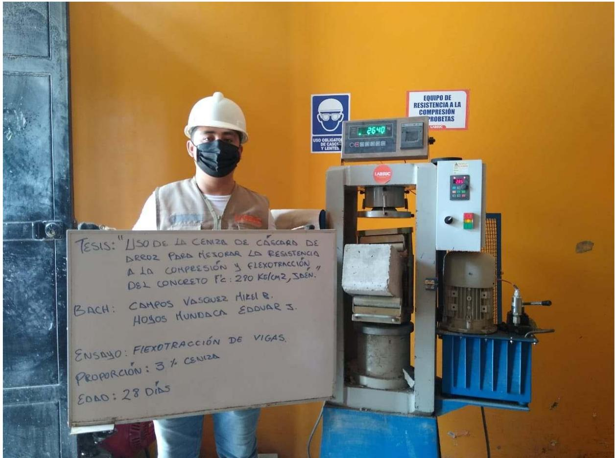
**FOTOGRAFIA 48:** Ensayo a Resistencia A La Flexión Del Concreto Endurecido ASTM C78 de la muestra de concreto patrón adicionando el 3 % de ceniza a los 28 días del Proyecto Tesis: "Uso De Ceniza De Cascara De Arroz Para Mejorar La Resistencia A La Compresión Y Flexotracción Del Concreto F´C 280 Kg/Cm2"
