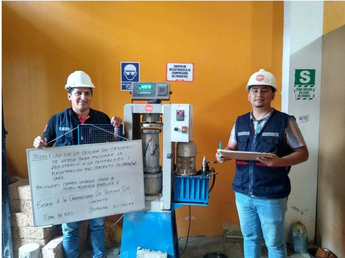
**FOTOGRAFIA 22:** Ensayo a compresión de testigos de concreto bajo la norma ASTM C39 de la muestra de concreto patrón adicionando el 3 % de ceniza a los 14 días del Proyecto Tesis: “Uso De Ceniza De Cascara De Arroz Para Mejorar La Resistencia A La Compresión Y Flexotracción Del Concreto F´C 280 Kg/Cm2”
