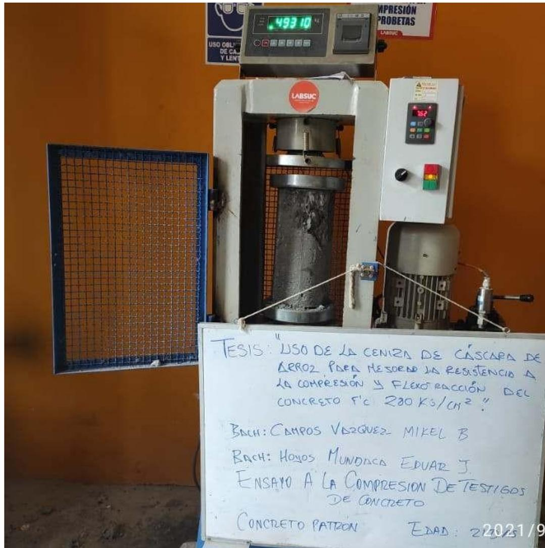
**FOTOGRAFIA 02:** Ensayo a compresión de testigos de concreto bajo la norma ASTM C39 de la muestra de concreto patrón a los 21 días del Proyecto Tesis: "Uso De Ceniza De Cascara De Arroz Para Mejorar La Resistencia A La Compresión Y Flexotracción Del Concreto F´C 280 Kg/Cm2"
