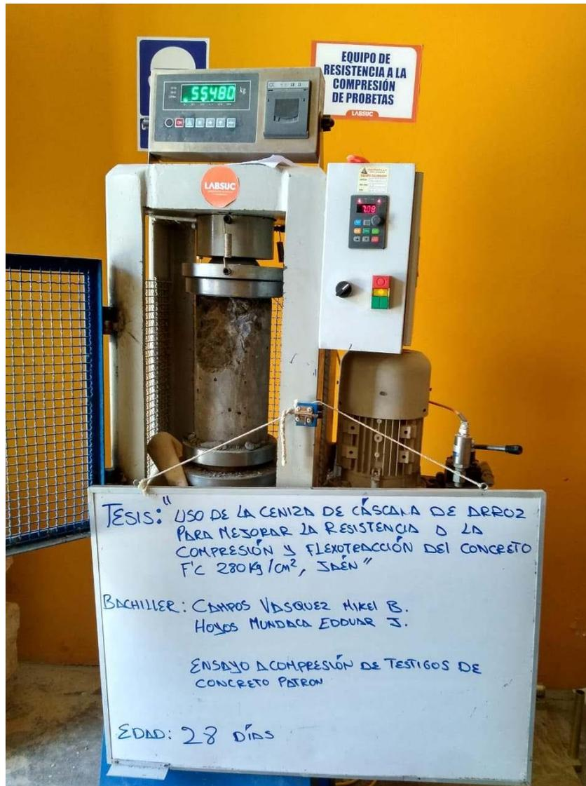
**FOTOGRAFIA 03:** Ensayo a compresión de testigos de concreto bajo la norma ASTM C39 de la muestra de concreto patrón a los 28 días del Proyecto Tesis: "Uso De Ceniza De Cascara De Arroz Para Mejorar La Resistencia A La Compresión Y Flexotracción Del Concreto F´C 280 Kg/Cm2"
