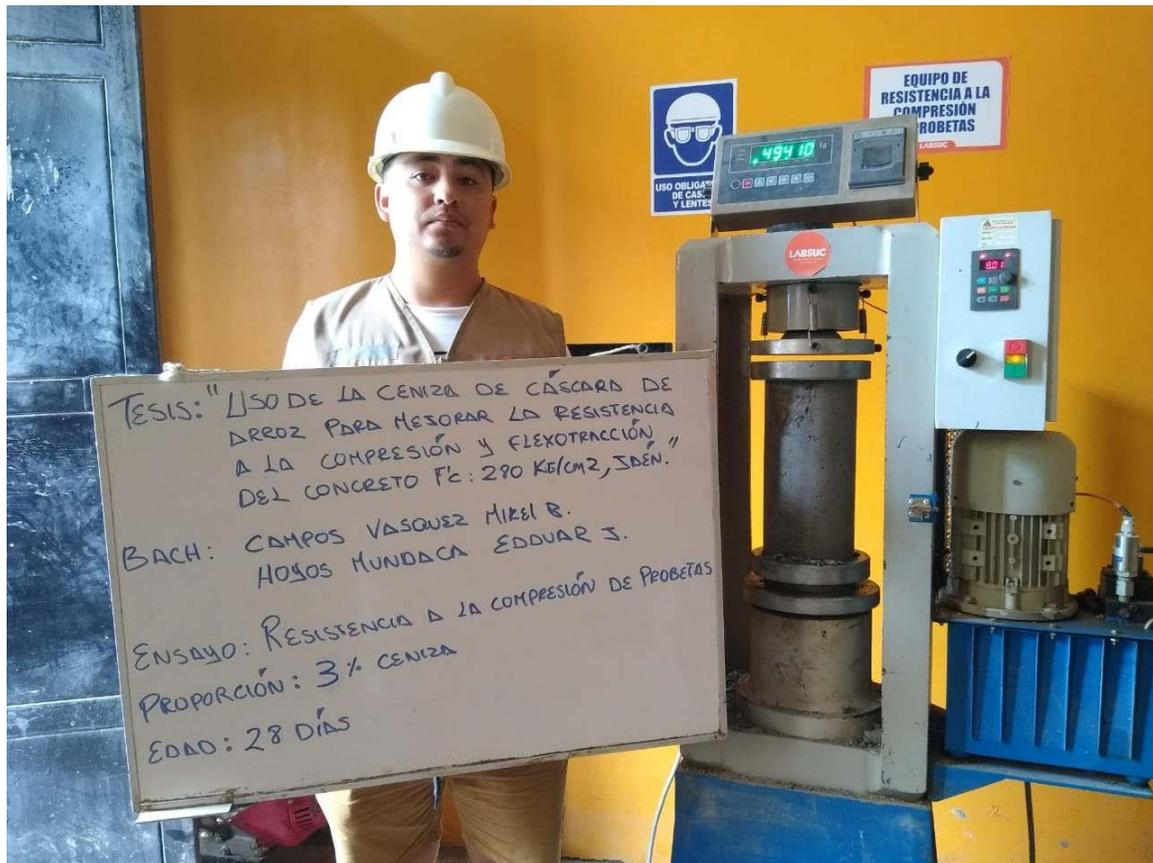
**FOTOGRAFIA 29:** Ensayo a compresión de testigos de concreto bajo la norma ASTM C39 de la muestra de concreto patrón adicionando el 3 % de ceniza a los 28 días del Proyecto Tesis: "Uso De Ceniza De Cascara De Arroz Para Mejorar La Resistencia A La Compresión Y Flexotracción Del Concreto F' C 280 Kg/Cm2"
