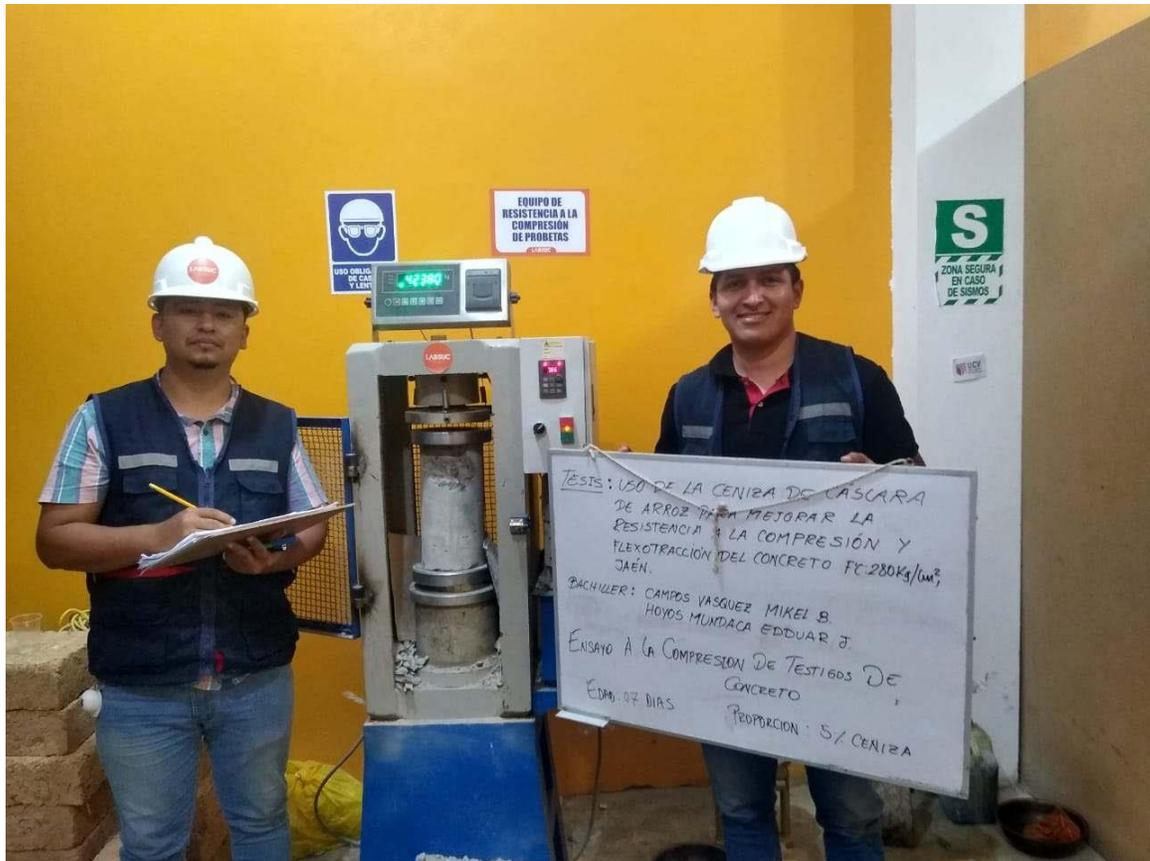
**FOTOGRAFIA 30:** Ensayo a compresión de testigos de concreto bajo la norma ASTM C39 de la muestra de concreto patrón adicionando el 5 % de ceniza a los 7 días del Proyecto Tesis: "Uso De Ceniza De Cascara De Arroz Para Mejorar La Resistencia A La Compresión Y Flexotracción Del Concreto F´C 280 Kg/Cm2"
