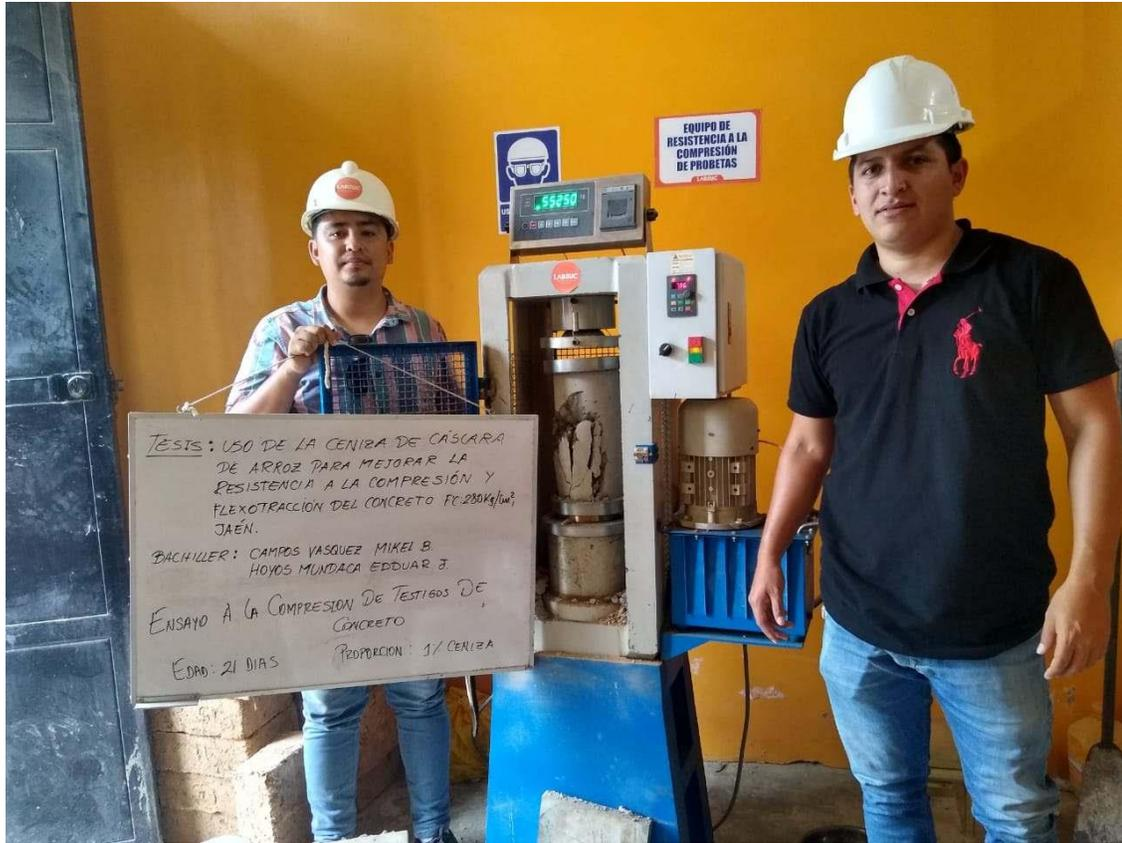
**FOTOGRAFIA 16:** Ensayo a compresión de testigos de concreto bajo la norma ASTM C39 de la muestra de concreto patrón adicionando el 1 % de ceniza a los 21 días del Proyecto Tesis: "Uso De Ceniza De Cascara De Arroz Para Mejorar La Resistencia A La Compresión Y Flexotracción Del Concreto F´C 280 Kg/Cm2"
