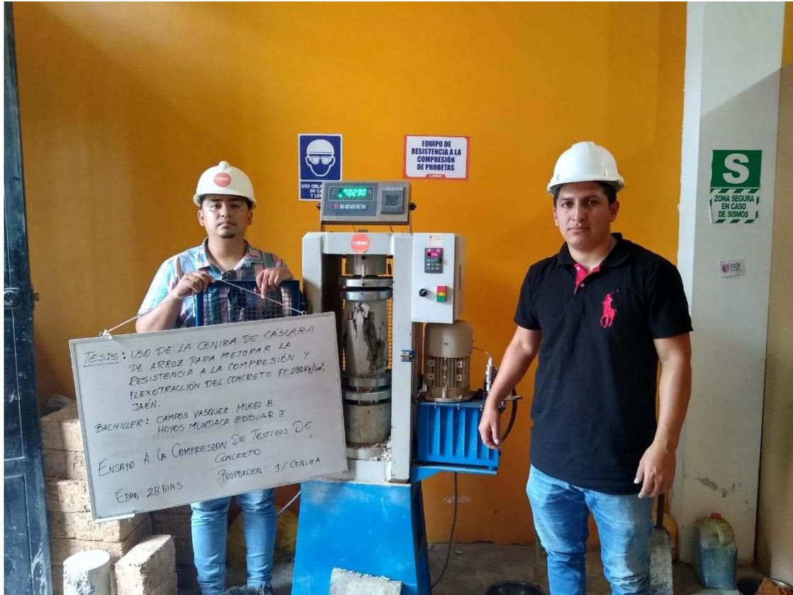
**FOTOGRAFIA 18:** Ensayo a compresión de testigos de concreto bajo la norma ASTM C39 de la muestra de concreto patrón adicionando el 1 % de ceniza a los 28 días del Proyecto Tesis: "Uso De Ceniza De Cascara De Arroz Para Mejorar La Resistencia A La Compresión Y Flexotracción Del Concreto F´C 280 Kg/Cm2"
