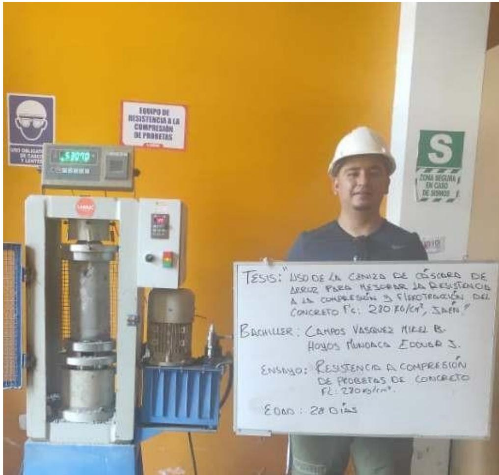
**FOTOGRAFIA 04:** Ensayo a compresión de testigos de concreto bajo la norma ASTM C39 de la muestra de concreto patrón a los 28 días del Proyecto Tesis: "Uso De Ceniza De Cascara De Arroz Para Mejorar La Resistencia A La Compresión Y Flexotracción Del Concreto F' C 280 Kg/Cm<sup>2</sup>"
