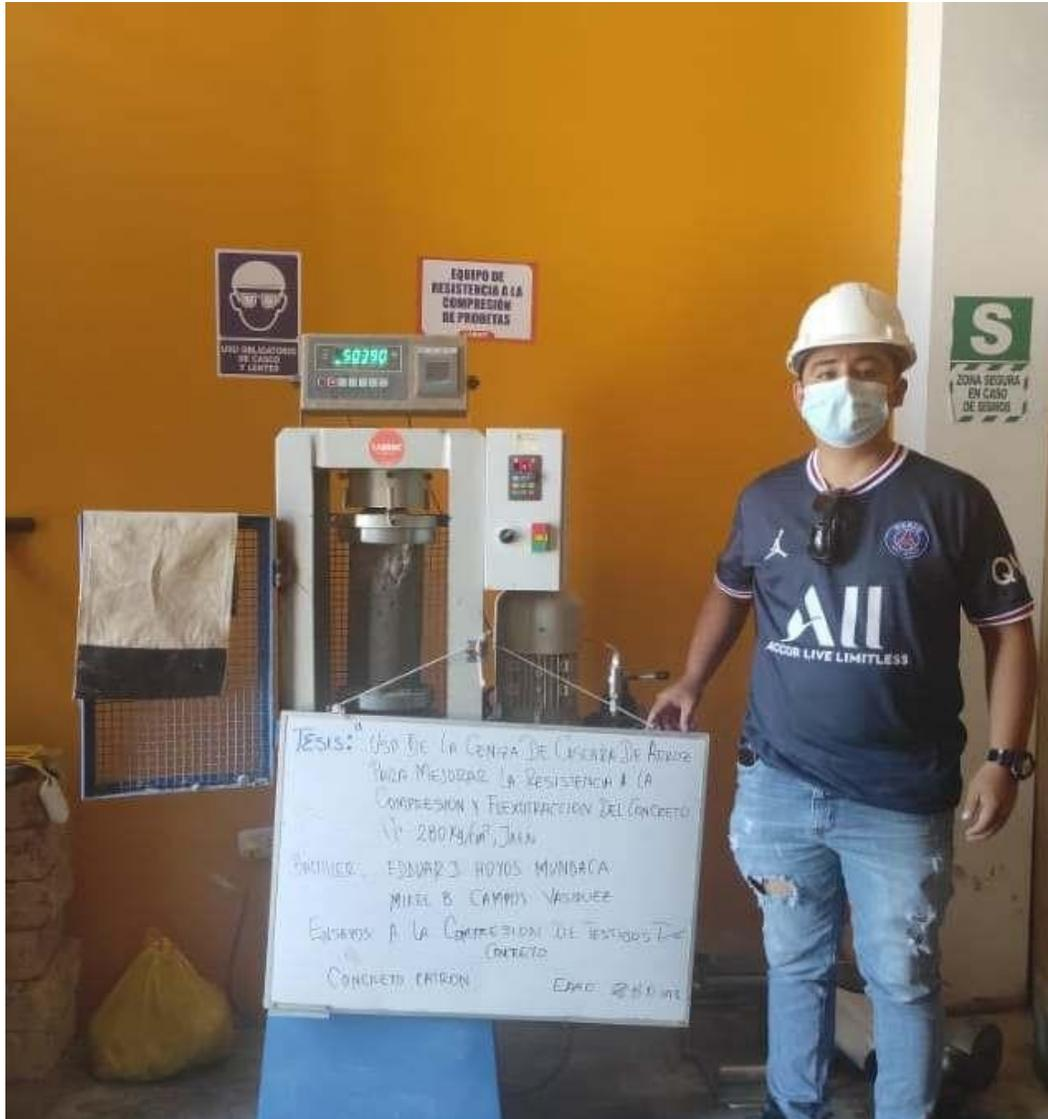
**FOTOGRAFIA 05:** Ensayo a compresión de testigos de concreto bajo la norma ASTM C39 de la muestra de concreto patrón a los 28 días del Proyecto Tesis: "Uso De Ceniza De Cascara De Arroz Para Mejorar La Resistencia A La Compresión Y Flexotracción Del Concreto F´C 280 Kg/Cm2"
