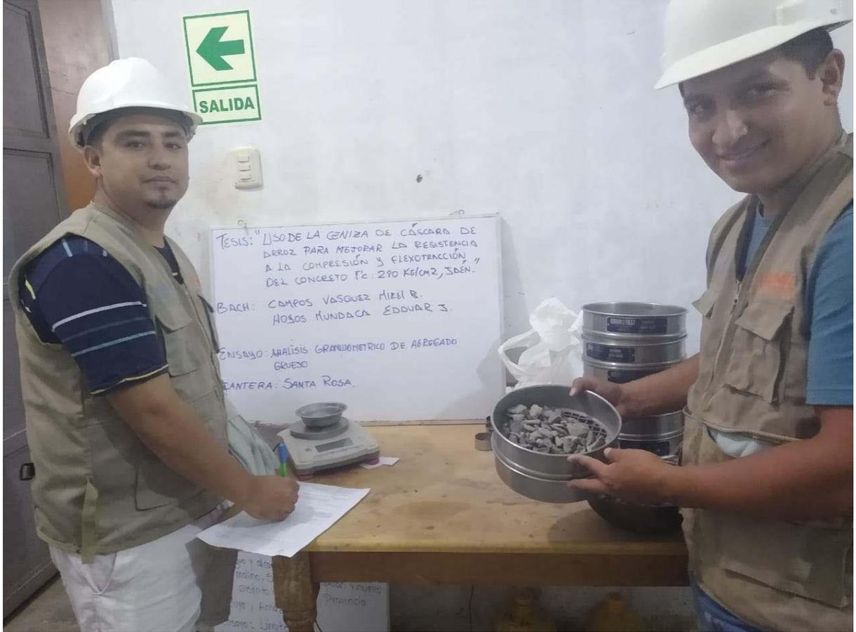
**FOTOGRAFIA 06:** Muestra la ejecución del ensayo de análisis granulométrico del agregado grueso de la cantera Santa Rosa del Proyecto: "Uso De Ceniza De Cascara De Arroz Para Mejorar La Resistencia A La Compresión Y Flexotracción Del Concreto F' C 280 Kg/Cm<sup>2</sup>"
