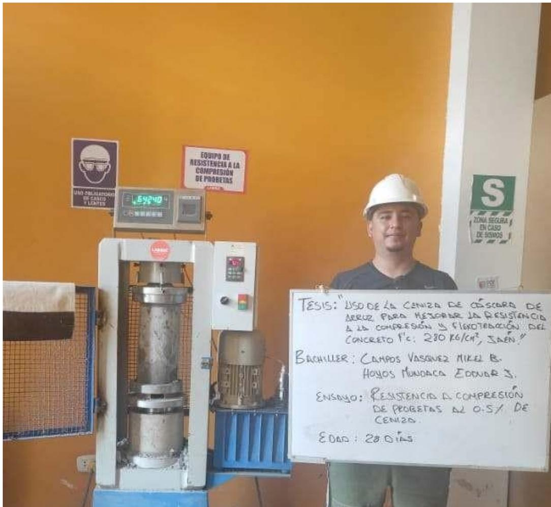
**FOTOGRAFIA 11:** Ensayo a compresión de testigos de concreto bajo la norma ASTM C39 de la muestra de concreto patrón adicionando el 0.5 % de ceniza a los 28 días del Proyecto Tesis: “Uso De Ceniza De Cascara De Arroz Para Mejorar La Resistencia A La Compresión Y Flexotracción Del Concreto F´C 280 Kg/Cm2”
