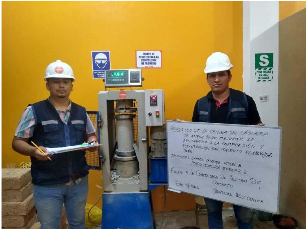
**FOTOGRAFIA 06:** Ensayo a compresión de testigos de concreto bajo la norma ASTM C39 de la muestra de concreto patrón adicionando el 0.5 % de ceniza a los 14 días del Proyecto Tesis: “Uso De Ceniza De Cascara De Arroz Para Mejorar La Resistencia A La Compresión Y Flexotracción Del Concreto F´C 280 Kg/Cm2”
