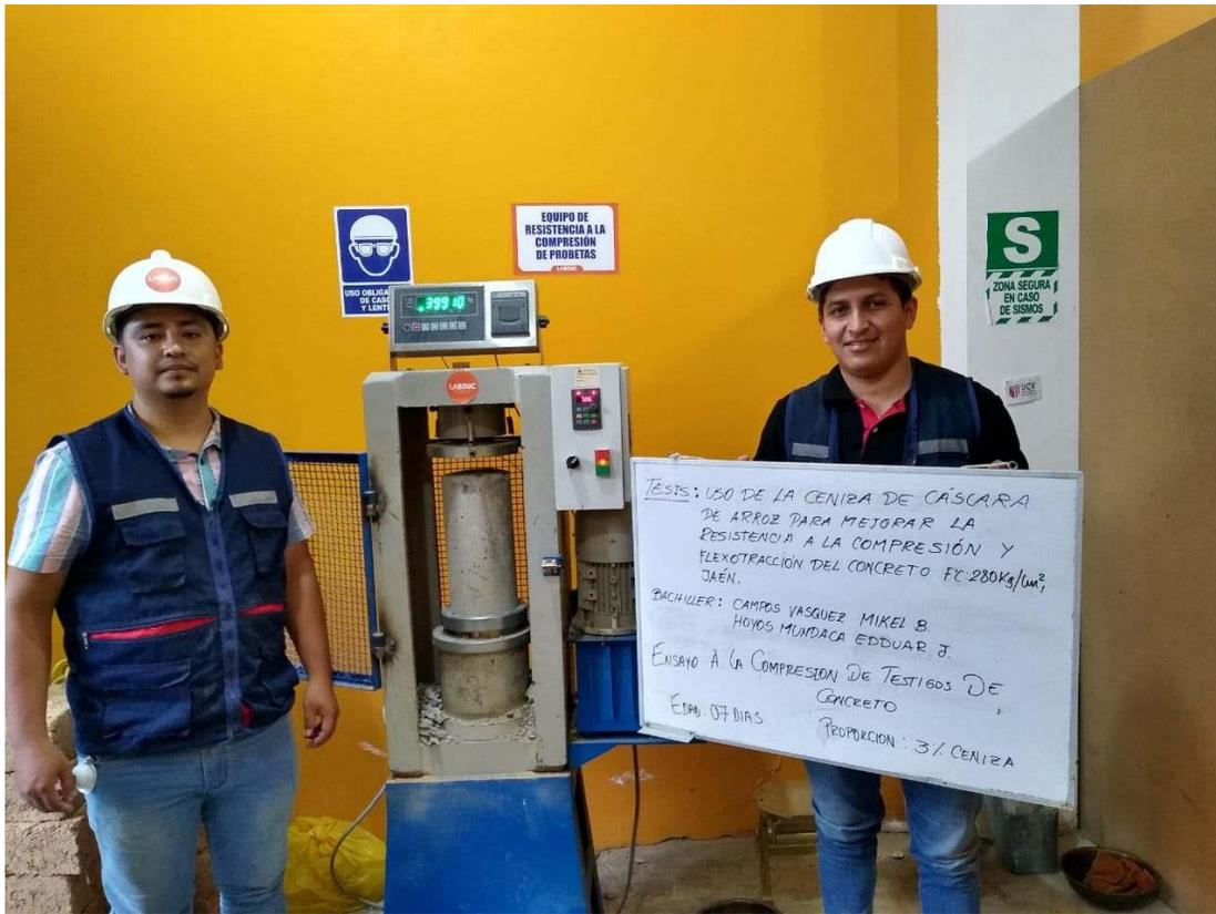
**FOTOGRAFIA 21:** Ensayo a compresión de testigos de concreto bajo la norma ASTM C39 de la muestra de concreto patrón adicionando el 3 % de ceniza a los 7 días del Proyecto Tesis: “Uso De Ceniza De Cascara De Arroz Para Mejorar La Resistencia A La Compresión Y Flexotracción Del Concreto F’ C 280 Kg/Cm<sup>2</sup>”
