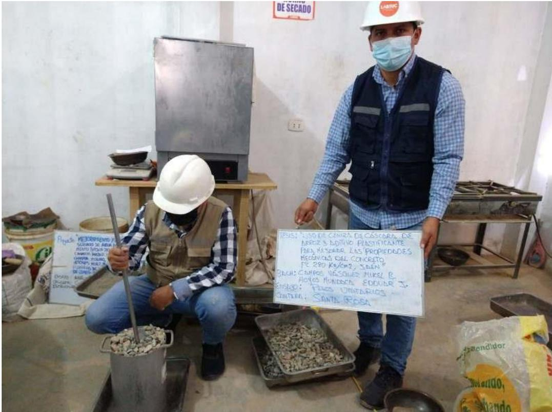
**FOTOGRAFIA 10:** Muestra la ejecución del ensayo de pesos unitarios del agregado grueso de la cantera Santa Rosa del Proyecto: "Uso De Ceniza De Cascara De Arroz Para Mejorar La Resistencia A La Compresión Y Flexotracción Del Concreto F´C 280 Kg/Cm2"
