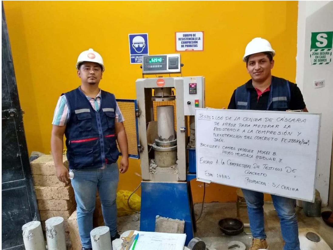
**FOTOGRAFIA 33:** Ensayo a compresión de testigos de concreto bajo la norma ASTM C39 de la muestra de concreto patrón adicionando el 5 % de ceniza a los 14 días del Proyecto Tesis: “Uso De Ceniza De Cascara De Arroz Para Mejorar La Resistencia A La Compresión Y Flexotracción Del Concreto F’C 280 Kg/Cm2”
