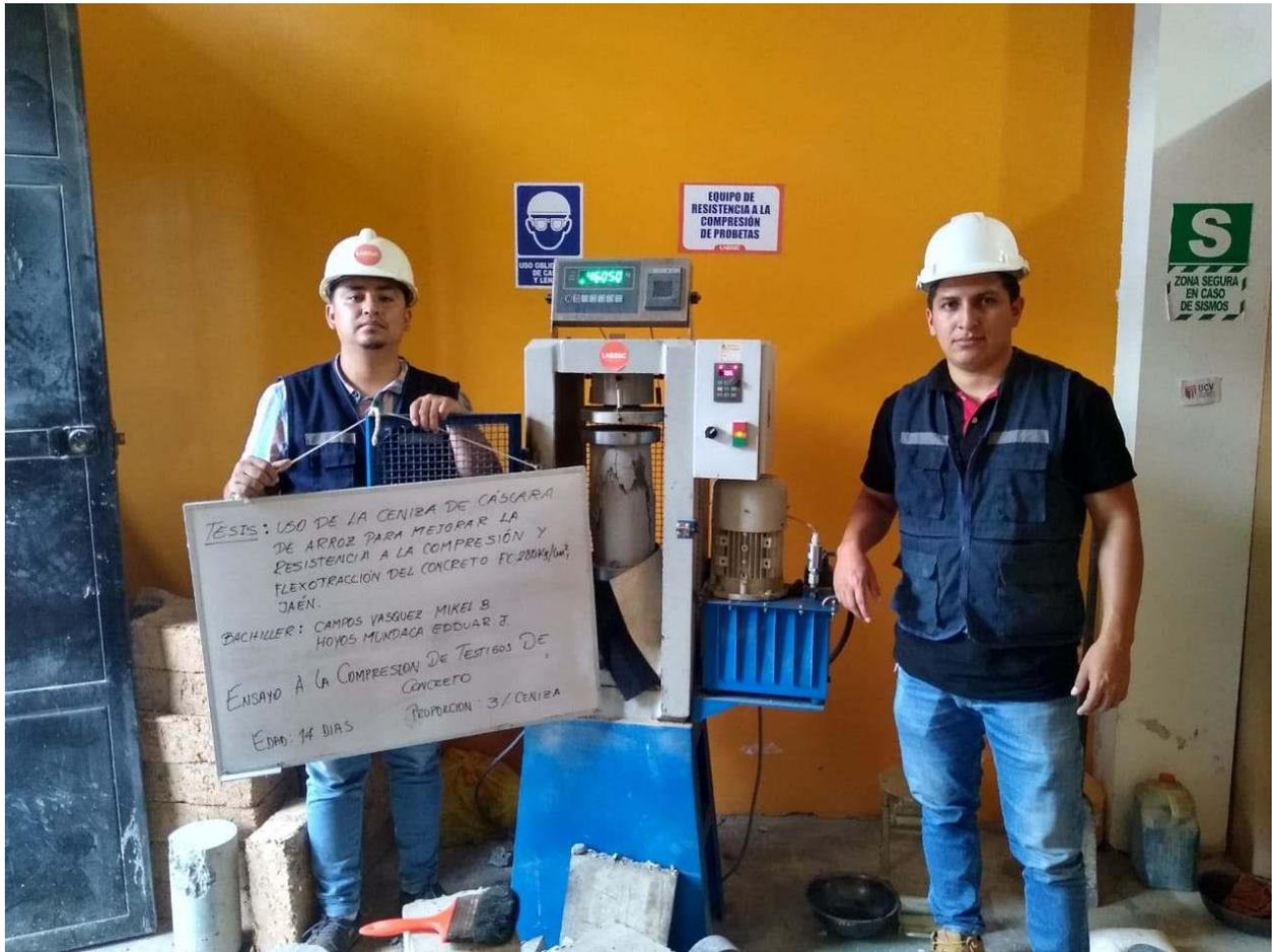
**FOTOGRAFIA 23:** Ensayo a compresión de testigos de concreto bajo la norma ASTM C39 de la muestra de concreto patrón adicionando el 3 % de ceniza a los 14 días del Proyecto Tesis: “Uso De Ceniza De Cascara De Arroz Para Mejorar La Resistencia A La Compresión Y Flexotracción Del Concreto F´C 280 Kg/Cm2”
