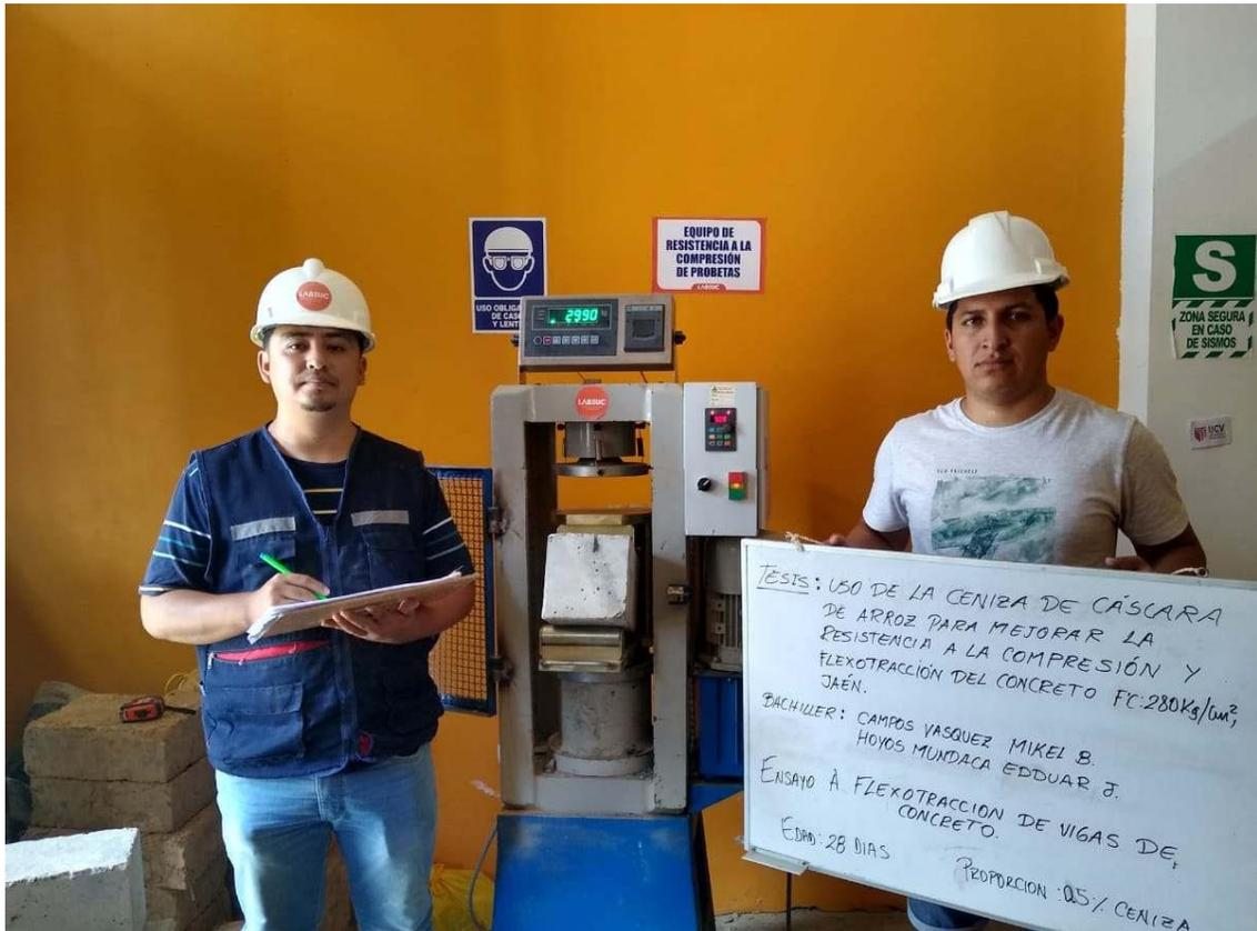
**FOTOGRAFIA 42:** Ensayo a Resistencia A La Flexión Del Concreto Endurecido ASTM C78 de la muestra de concreto patrón adicionando el 0.5 % de ceniza a los 28 días del Proyecto Tesis: "Uso De Ceniza De Cascara De Arroz Para Mejorar La Resistencia A La Compresión Y Flexotracción Del Concreto F´C 280 Kg/Cm2"
