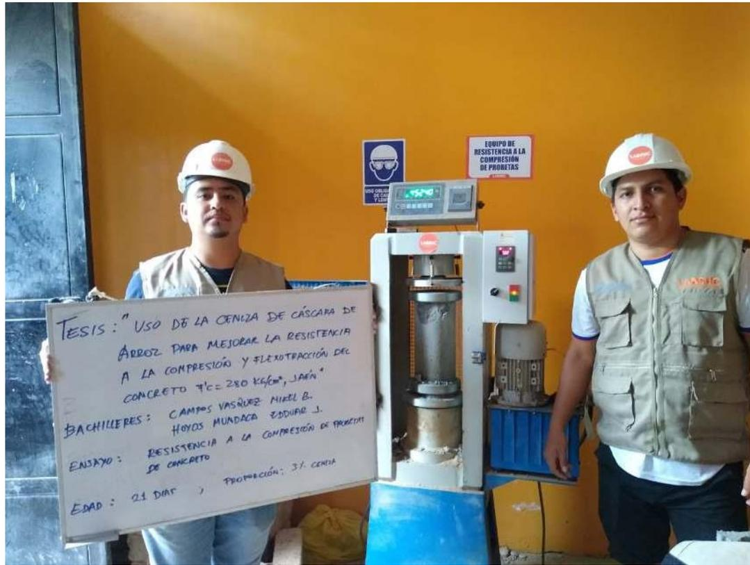
**FOTOGRAFIA 27:** Ensayo a compresión de testigos de concreto bajo la norma ASTM C39 de la muestra de concreto patrón adicionando el 3 % de ceniza a los 21 días del Proyecto Tesis: "Uso De Ceniza De Cascara De Arroz Para Mejorar La Resistencia A La Compresión Y Flexotracción Del Concreto F´C 280 Kg/Cm2"
