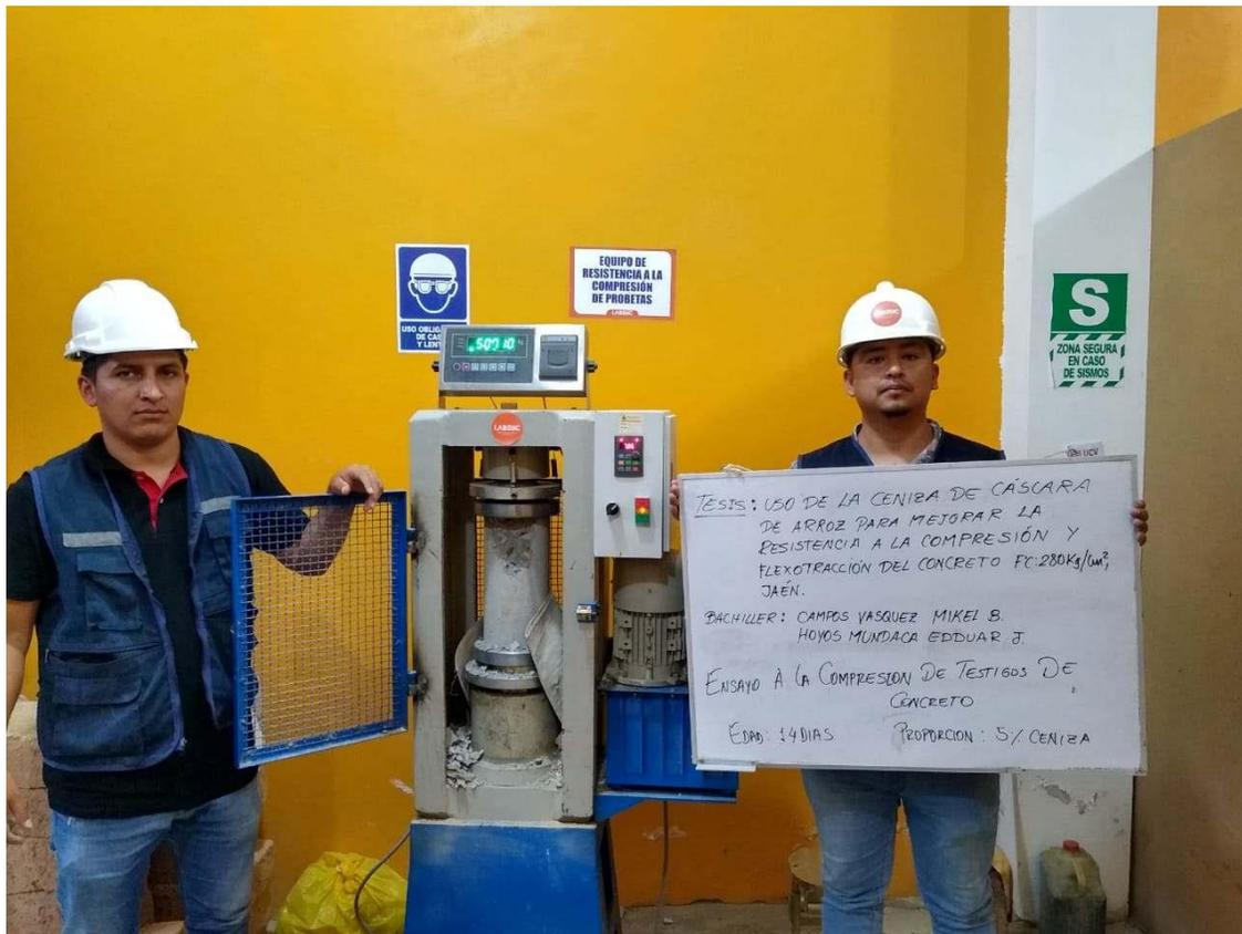
**FOTOGRAFIA 35:** Ensayo a compresión de testigos de concreto bajo la norma ASTM C39 de la muestra de concreto patrón adicionando el 5 % de ceniza a los 14 días del Proyecto Tesis: "Uso De Ceniza De Cascara De Arroz Para Mejorar La Resistencia A La Compresión Y Flexotracción Del Concreto F' C 280 Kg/Cm2"
