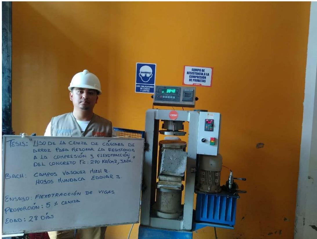
**FOTOGRAFIA 49:** Ensayo a Resistencia A La Flexión Del Concreto Endurecido ASTM C78 de la muestra de concreto patrón adicionando el 5 % de ceniza a los 28 días del Proyecto Tesis: "Uso De Ceniza De Cascara De Arroz Para Mejorar La Resistencia A La Compresión Y Flexotracción Del Concreto F'c 280 Kg/C
