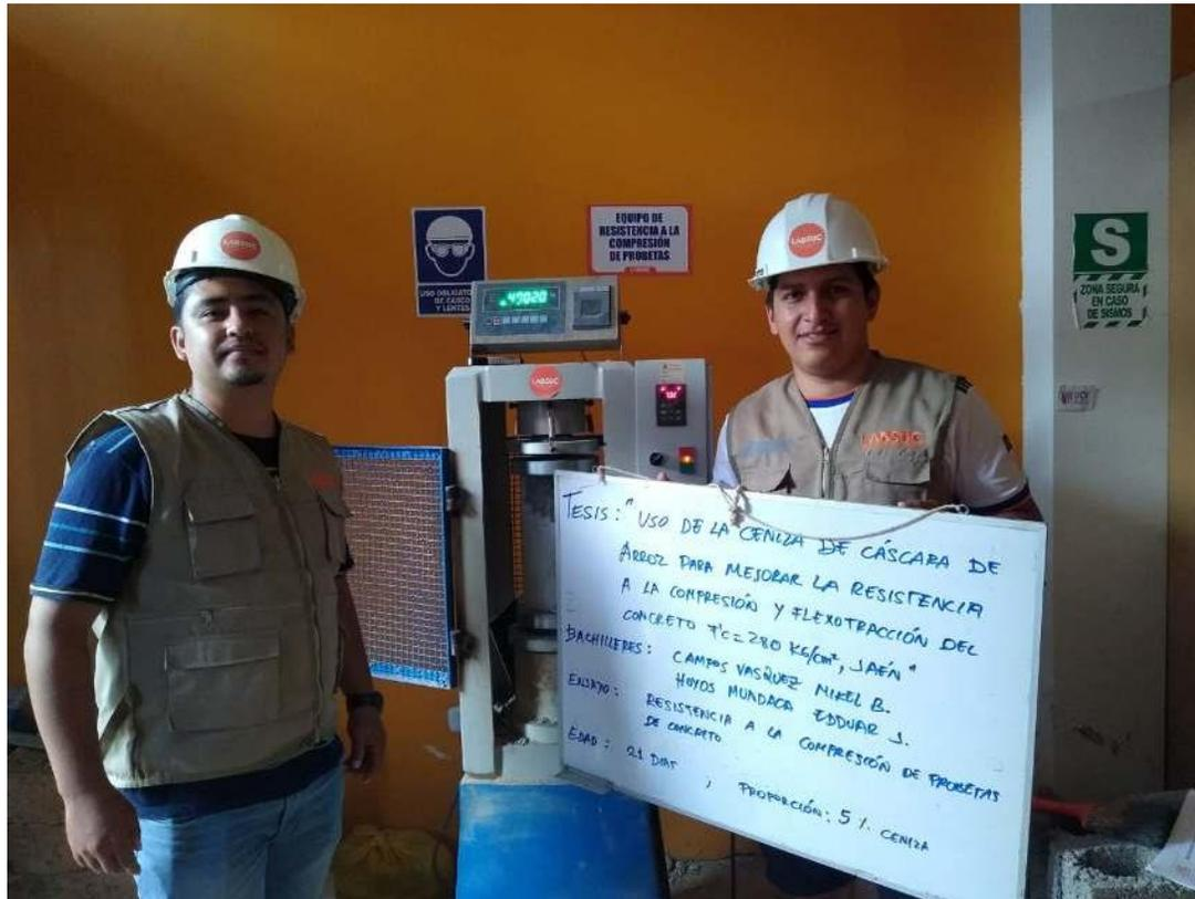
**FOTOGRAFIA 38:** Ensayo a compresión de testigos de concreto bajo la norma ASTM C39 de la muestra de concreto patrón adicionando el 5 % de ceniza a los 21 días del Proyecto Tesis: "Uso De Ceniza De Cascara De Arroz Para Mejorar La Resistencia A La Compresión Y Flexotracción Del Concreto F´C 280 Kg/Cm2"
