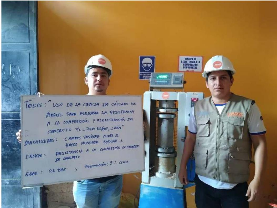
**FOTOGRAFIA 37:** Ensayo a compresión de testigos de concreto bajo la norma ASTM C39 de la muestra de concreto patrón adicionando el 5 % de ceniza a los 21 días del Proyecto Tesis: “Uso De Ceniza De Cascara De Arroz Para Mejorar La Resistencia A La Compresión Y Flexotracción Del Concreto F´C 280 Kg/Cm2”
