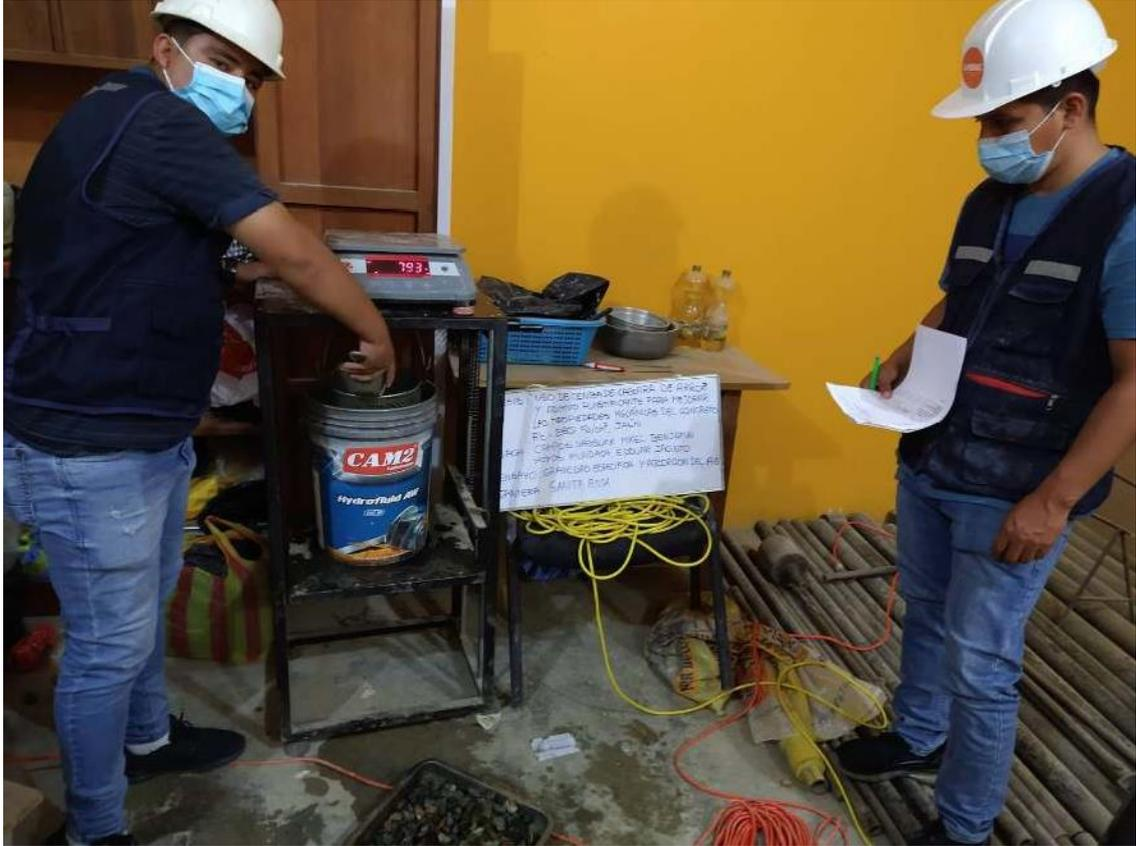
**FOTOGRAFIA 09:** Muestra la ejecución del ensayo de gravedad y peso específico del agregado grueso de la cantera Santa Rosa del Proyecto: "Uso De Ceniza De Cascara De Arroz Para Mejorar La Resistencia A La Compresión Y Flexotracción Del Concreto F' C 280 Kg/Cm<sup>2</sup>"
