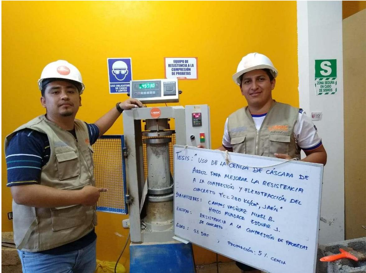
**FOTOGRAFIA 36:** Ensayo a compresión de testigos de concreto bajo la norma ASTM C39 de la muestra de concreto patrón adicionando el 5 % de ceniza a los 21 días del Proyecto Tesis: "Uso De Ceniza De Cascara De Arroz Para Mejorar La Resistencia A La Compresión Y Flexotracción Del Concreto F´C 280 Kg/Cm2"
