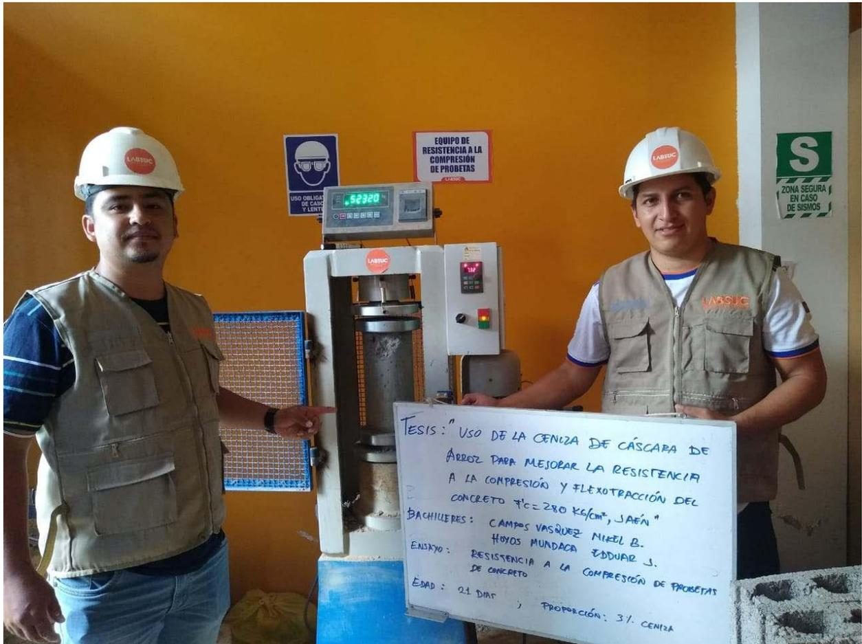
**FOTOGRAFIA 26:** Ensayo a compresión de testigos de concreto bajo la norma ASTM C39 de la muestra de concreto patrón adicionando el 3 % de ceniza a los 21 días del Proyecto Tesis: "Uso De Ceniza De Cascara De Arroz Para Mejorar La Resistencia A La Compresión Y Flexotracción Del Concreto F´C 280 Kg/Cm2"
