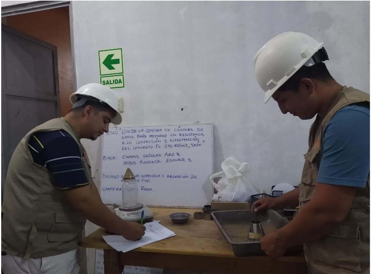
**FOTOGRAFIA 08:** Muestra la ejecución del ensayo de gravedad y peso específico del agregado fino de la cantera Santa Rosa del Proyecto: "Uso De Ceniza De Cascara De Arroz Para Mejorar La Resistencia A La Compresión Y Flexotracción Del Concreto F´C 280 Kg/Cm2"
