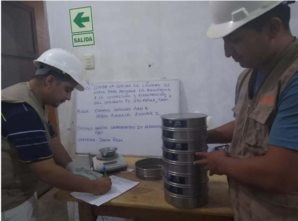
**FOTOGRAFIA 07:** Muestra la ejecución del ensayo de análisis granulométrico del agregado fino de la cantera Santa Rosa del Proyecto: "Uso De Ceniza De Cascara De Arroz Para Mejorar La Resistencia A La Compresión Y Flexotracción Del Concreto F´C 280 Kg/Cm<sup>2</sup>"
