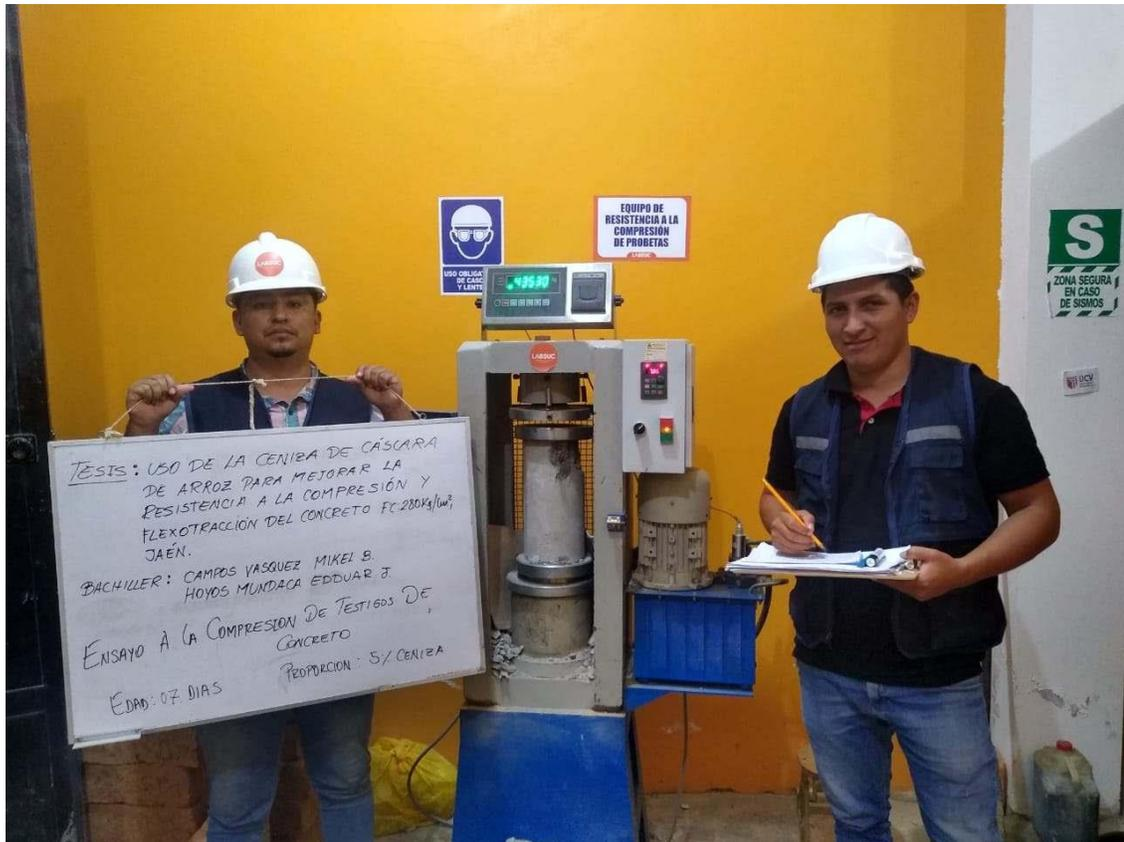
**FOTOGRAFIA 31:** Ensayo a compresión de testigos de concreto bajo la norma ASTM C39 de la muestra de concreto patrón adicionando el 5 % de ceniza a los 7 días del Proyecto Tesis: “Uso De Ceniza De Cascara De Arroz Para Mejorar La Resistencia A La Compresión Y Flexotracción Del Concreto F´C 280 Kg/Cm2”
