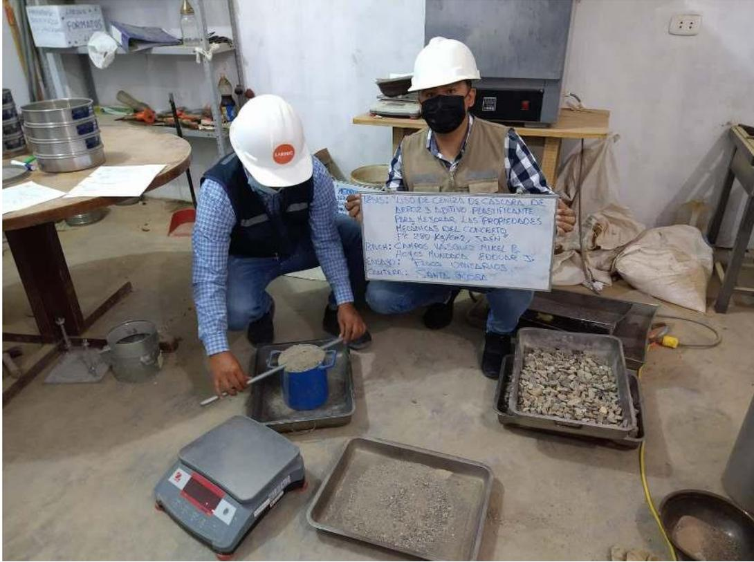
**FOTOGRAFIA 11:** Muestra la ejecución del ensayo de pesos unitarios del agregado fino de la cantera Santa Rosa del Proyecto: "Uso De Ceniza De Cascara De Arroz Para Mejorar La Resistencia A La Compresión Y Flexotracción Del Concreto F' C 280 Kg/Cm<sup>2</sup>"
