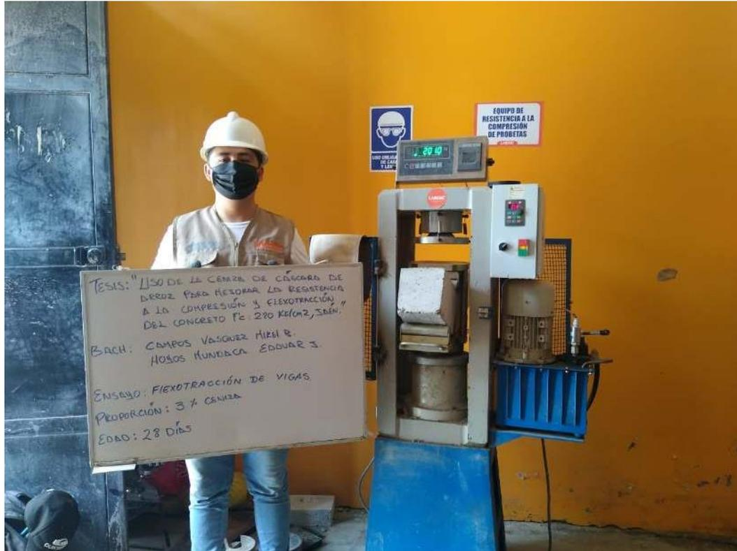
**FOTOGRAFIA 47:** Ensayo a Resistencia A La Flexión Del Concreto Endurecido ASTM C78 de la muestra de concreto patrón adicionando el 3 % de ceniza a los 28 días del Proyecto Tesis: "Uso De Ceniza De Cascara De Arroz Para Mejorar La Resistencia A La Compresión Y Flexotracción Del Concreto F´C 280 Kg/Cm2"
