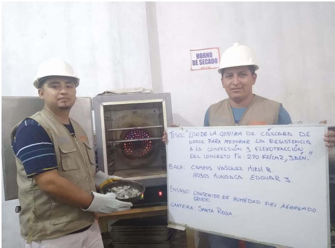
**FOTOGRAFIA 05:** Muestra la ejecución del ensayo del contenido de humedad del agregado grueso de la cantera Santa Rosa del Proyecto: "Uso De Ceniza De Cascara De Arroz Para Mejorar La Resistencia A La Compresión Y Flexotracción Del Concreto F´C 280 Kg/Cm2"
