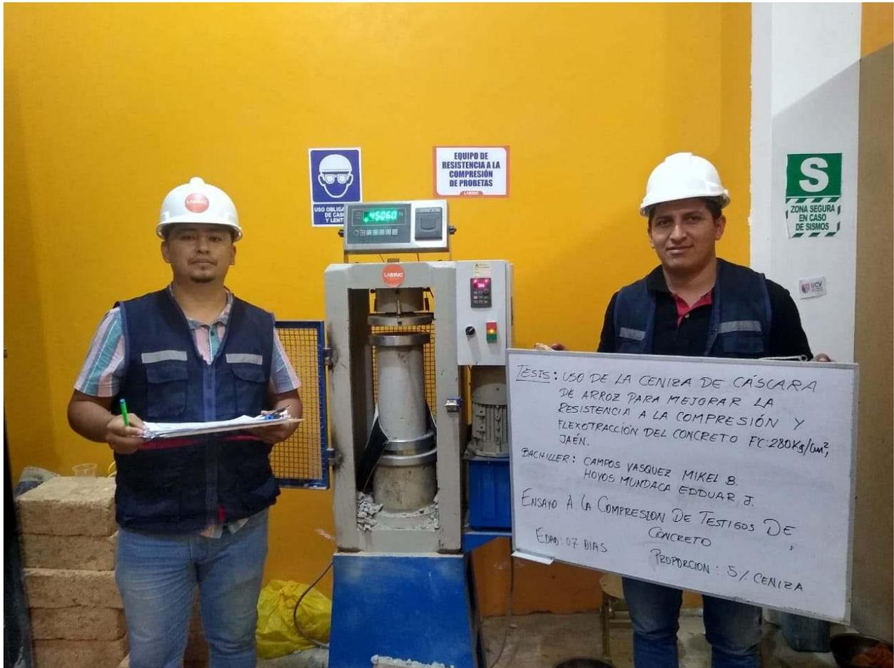
**FOTOGRAFIA 32:** Ensayo a compresión de testigos de concreto bajo la norma ASTM C39 de la muestra de concreto patrón adicionando el 5 % de ceniza a los 7 días del Proyecto Tesis: “Uso De Ceniza De Cascara De Arroz Para Mejorar La Resistencia A La Compresión Y Flexotracción Del Concreto F´C 280 Kg/Cm2”
