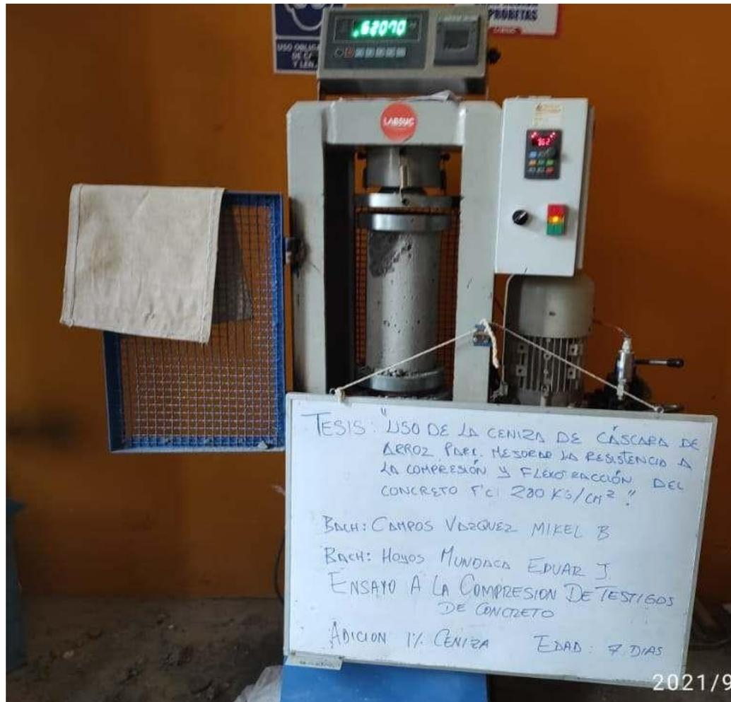
**FOTOGRAFIA 13:** Ensayo a compresión de testigos de concreto bajo la norma ASTM C39 de la muestra de concreto patrón adicionando el 1 % de ceniza a los 7 días del Proyecto Tesis: "Uso De Ceniza De Cascara De Arroz Para Mejorar La Resistencia A La Compresión Y Flexotracción Del Concreto F´C 280 Kg/Cm2"
