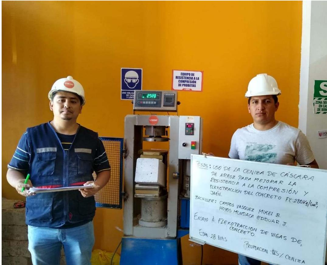
**FOTOGRAFIA 44:** Ensayo a Resistencia A La Flexión Del Concreto Endurecido ASTM C78 de la muestra de concreto patrón adicionando el 0.5 % de ceniza a los 28 días del Proyecto Tesis: "Uso De Ceniza De Cascara De Arroz Para Mejorar La Resistencia A La Compresión Y Flexotracción Del Concreto F´C 280 Kg/Cm2"
