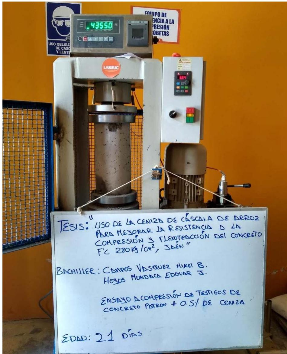
**FOTOGRAFIA 09:** Ensayo a compresión de testigos de concreto bajo la norma ASTM C39 de la muestra de concreto patrón adicionando el 0.5 % de ceniza a los 21 días del Proyecto Tesis: "Uso De Ceniza De Cascara De Arroz Para Mejorar La Resistencia A La Compresión Y Flexotracción Del Concreto F´C 280 Kg/Cm2"
