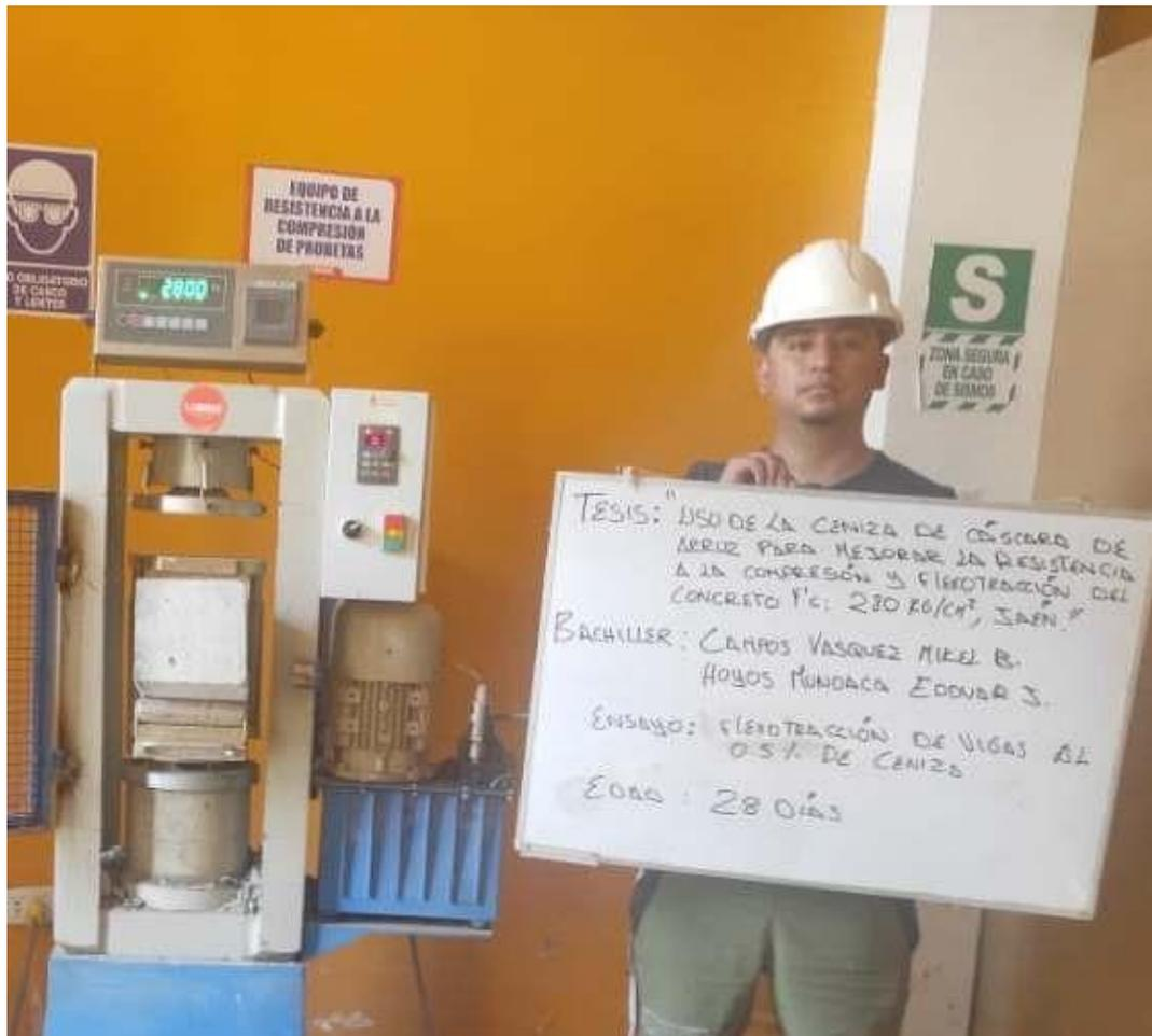
**FOTOGRAFIA 43:** Ensayo a Resistencia A La Flexión Del Concreto Endurecido ASTM C78 de la muestra de concreto patrón adicionando el 0.5 % de ceniza a los 28 días del Proyecto Tesis: “Uso De Ceniza De Cascara De Arroz Para Mejorar La Resistencia A La Compresión Y Flexotracción Del Concreto F´C 280 Kg/Cm2”
