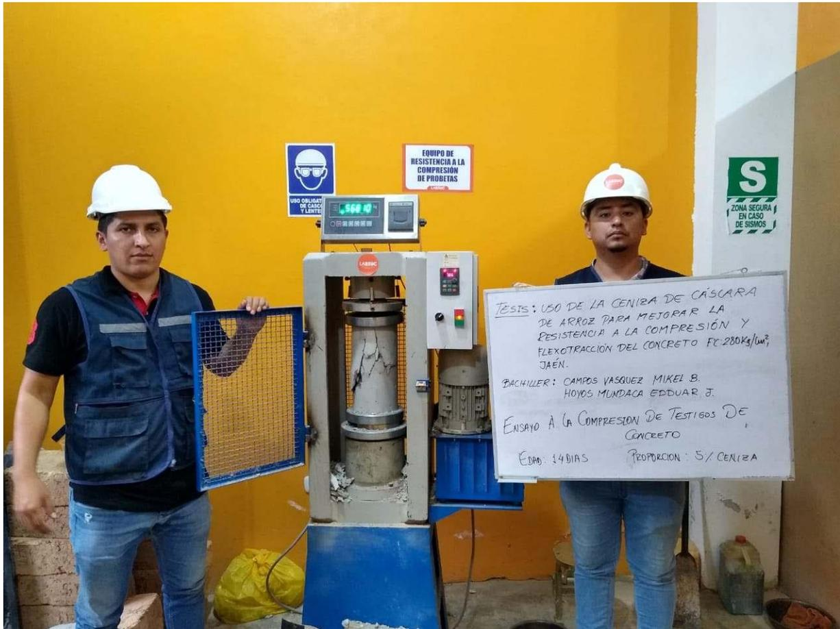
**FOTOGRAFIA 34:** Ensayo a compresión de testigos de concreto bajo la norma ASTM C39 de la muestra de concreto patrón adicionando el 5 % de ceniza a los 14 días del Proyecto Tesis: “Uso De Ceniza De Cascara De Arroz Para Mejorar La Resistencia A La Compresión Y Flexotracción Del Concreto F´C 280 Kg/Cm2”
