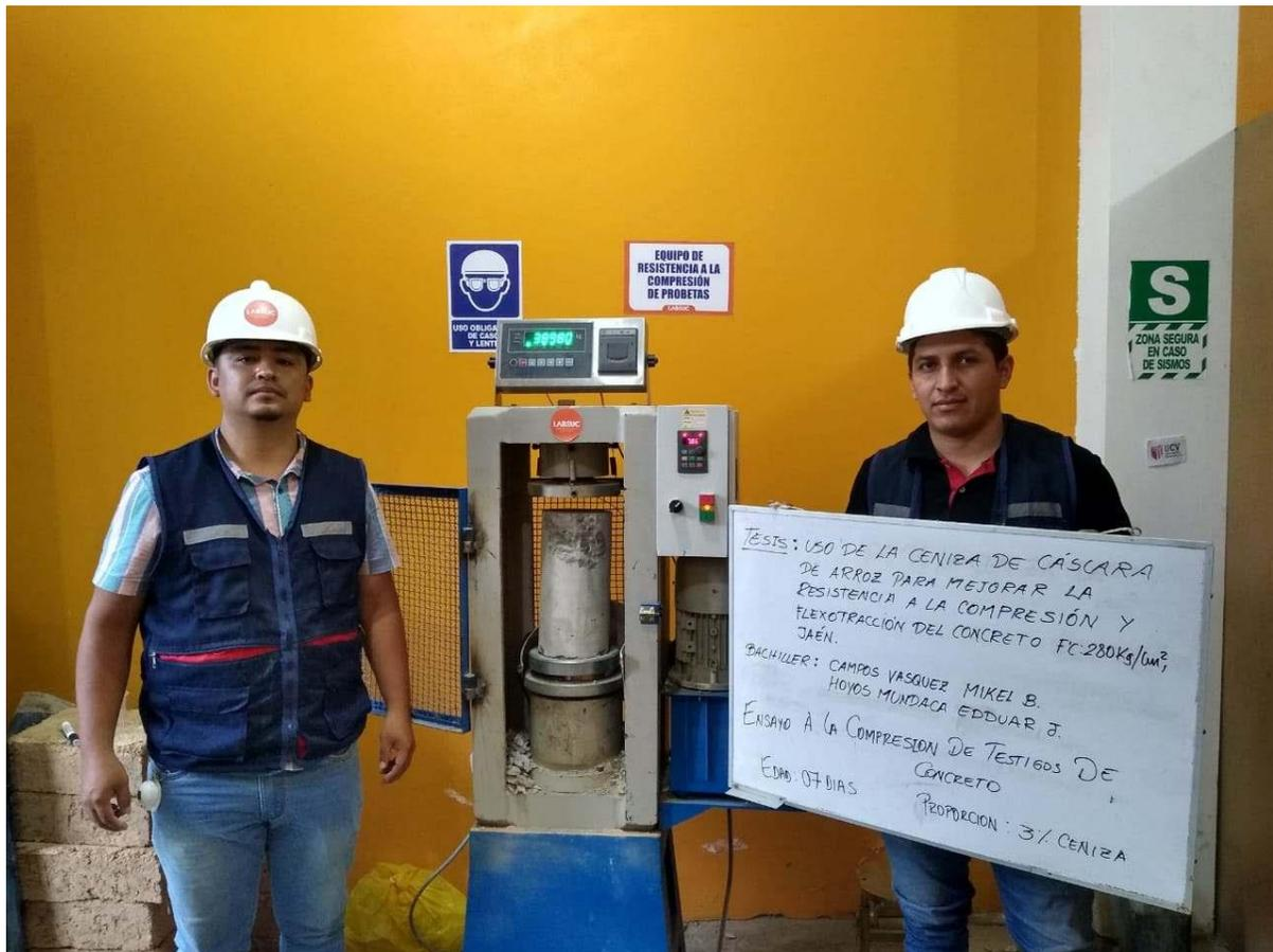
**FOTOGRAFIA 20:** Ensayo a compresión de testigos de concreto bajo la norma ASTM C39 de la muestra de concreto patrón adicionando el 3 % de ceniza a los 7 días del Proyecto Tesis: “Uso De Ceniza De Cascara De Arroz Para Mejorar La Resistencia A La Compresión Y Flexotracción Del Concreto F´C 280 Kg/Cm2”
