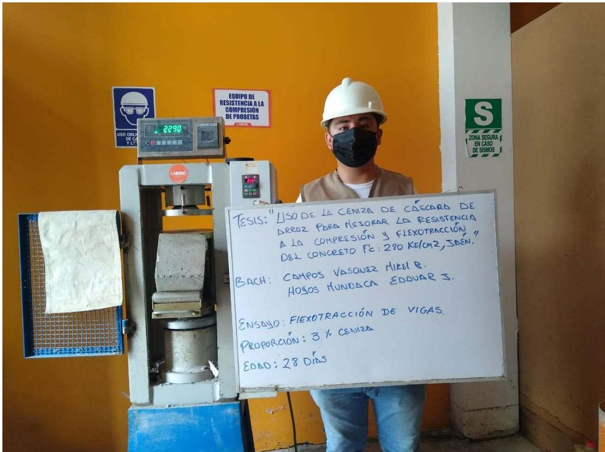
**FOTOGRAFIA 46:** Ensayo a Resistencia A La Flexión Del Concreto Endurecido ASTM C78 de la muestra de concreto patrón adicionando el 3 % de ceniza a los 28 días del Proyecto Tesis: "Uso De Ceniza De Cascara De Arroz Para Mejorar La Resistencia A La Compresión Y Flexotracción Del Concreto F' C 280 Kg/Cm2"
