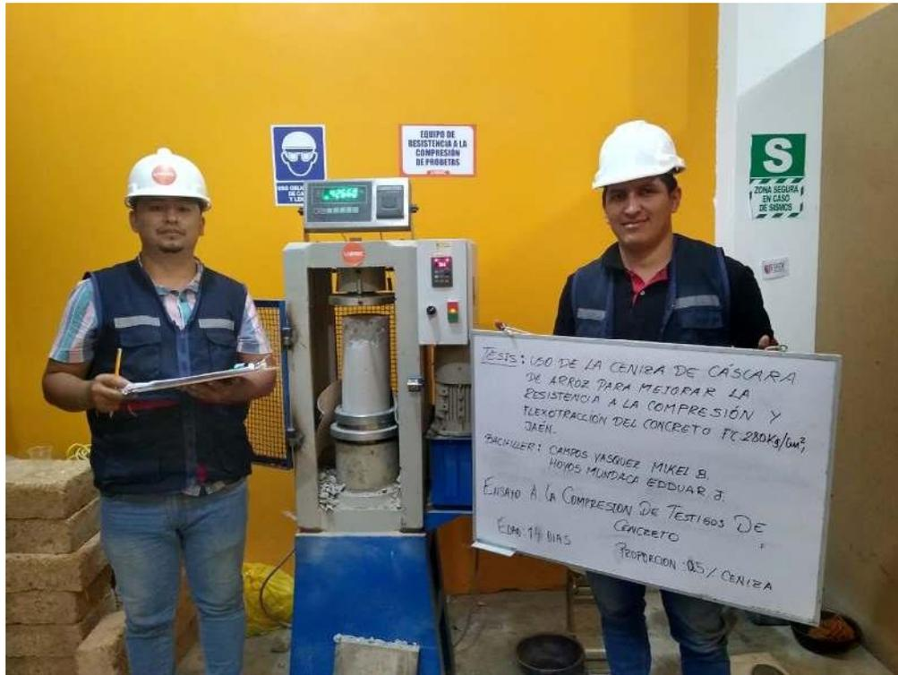
**FOTOGRAFIA 07:** Ensayo a compresión de testigos de concreto bajo la norma ASTM C39 de la muestra de concreto patrón adicionando el 0.5 % de ceniza a los 14 días del Proyecto Tesis: "Uso De Ceniza De Cascara De Arroz Para Mejorar La Resistencia A La Compresión Y Flexotracción Del Concreto F´C 280 Kg/Cm2"
