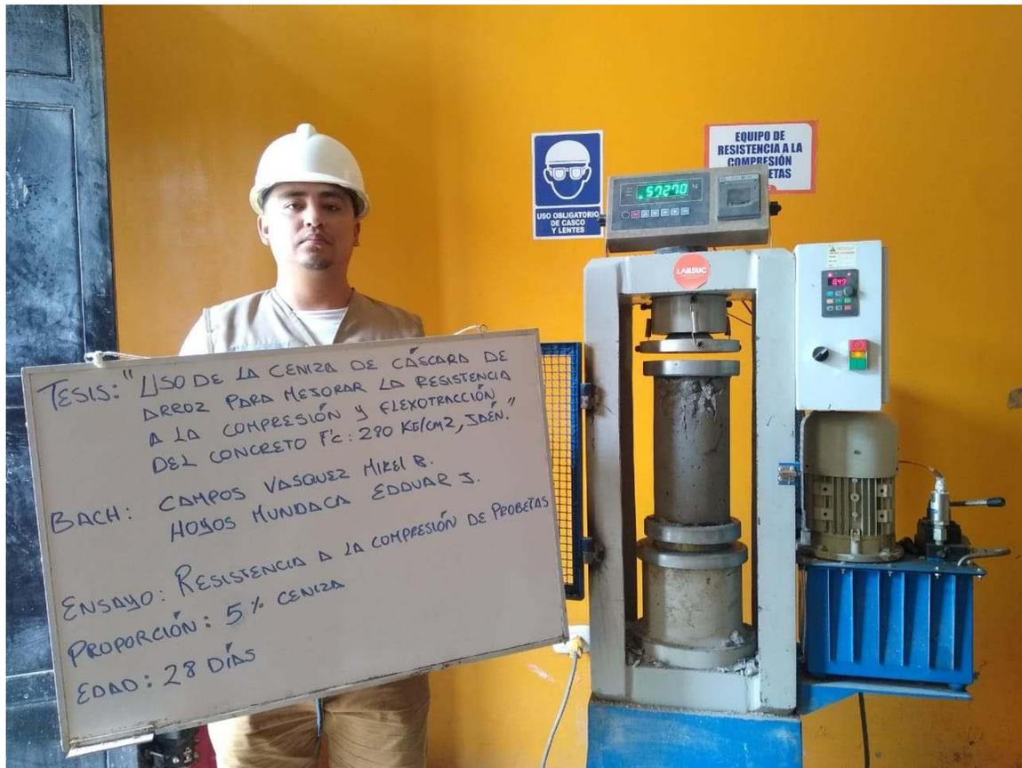
**FOTOGRAFIA 39:** Ensayo a compresión de testigos de concreto bajo la norma ASTM C39 de la muestra de concreto patrón adicionando el 5 % de ceniza a los 28 días del Proyecto Tesis: "Uso De Ceniza De Cascara De Arroz Para Mejorar La Resistencia A La Compresión Y Flexotracción Del Concreto F'C 280 Kg/Cm2"
