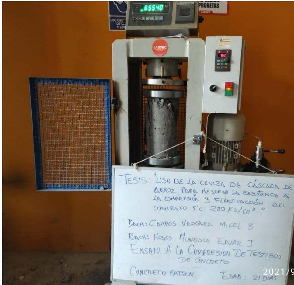
**FOTOGRAFIA 01:** Ensayo a compresión de testigos de concreto bajo la norma ASTM C39 de la muestra de concreto patrón a los 21 días del Proyecto Tesis: "Uso De Ceniza De Cascara De Arroz Para Mejorar La Resistencia A La Compresión Y Flexotracción Del Concreto F´C 280 Kg/Cm2"
