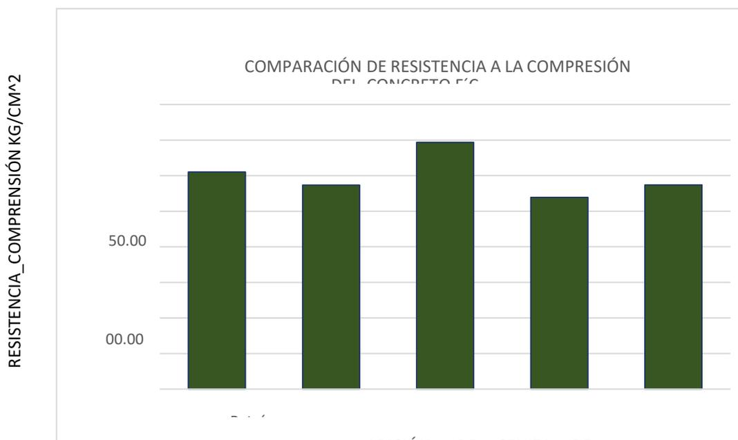
Interpretación. Según la figura 1 se refleja los resultados de los distintos promedios de los experimentos realizados, donde se puede apreciar que el porcentaje de 1.00% de adición de ceniza tiene mayor promedio respecto a la resistencia a la compresión.
