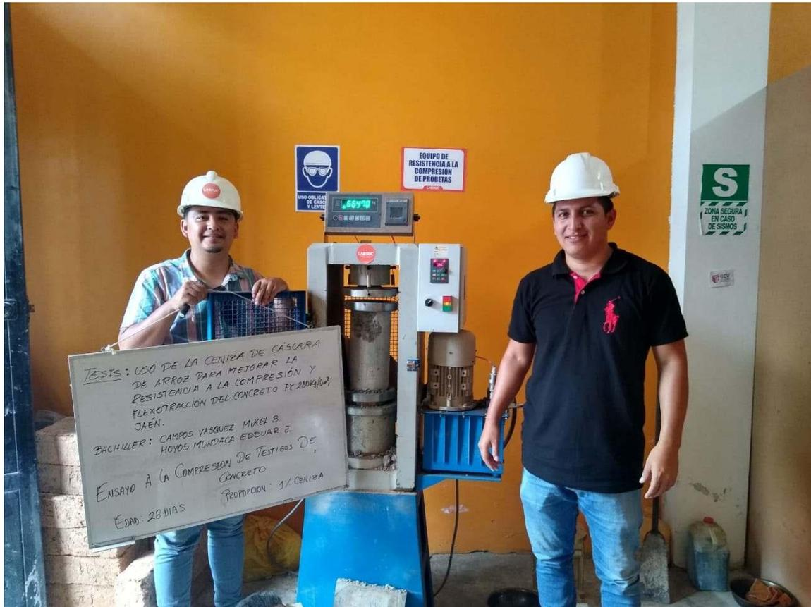
**FOTOGRAFIA 17:** Ensayo a compresión de testigos de concreto bajo la norma ASTM C39 de la muestra de concreto patrón adicionando el 1 % de ceniza a los 28 días del Proyecto Tesis: "Uso De Ceniza De Cascara De Arroz Para Mejorar La Resistencia A La Compresión Y Flexotracción Del Concreto F´C 280 Kg/Cm2"
