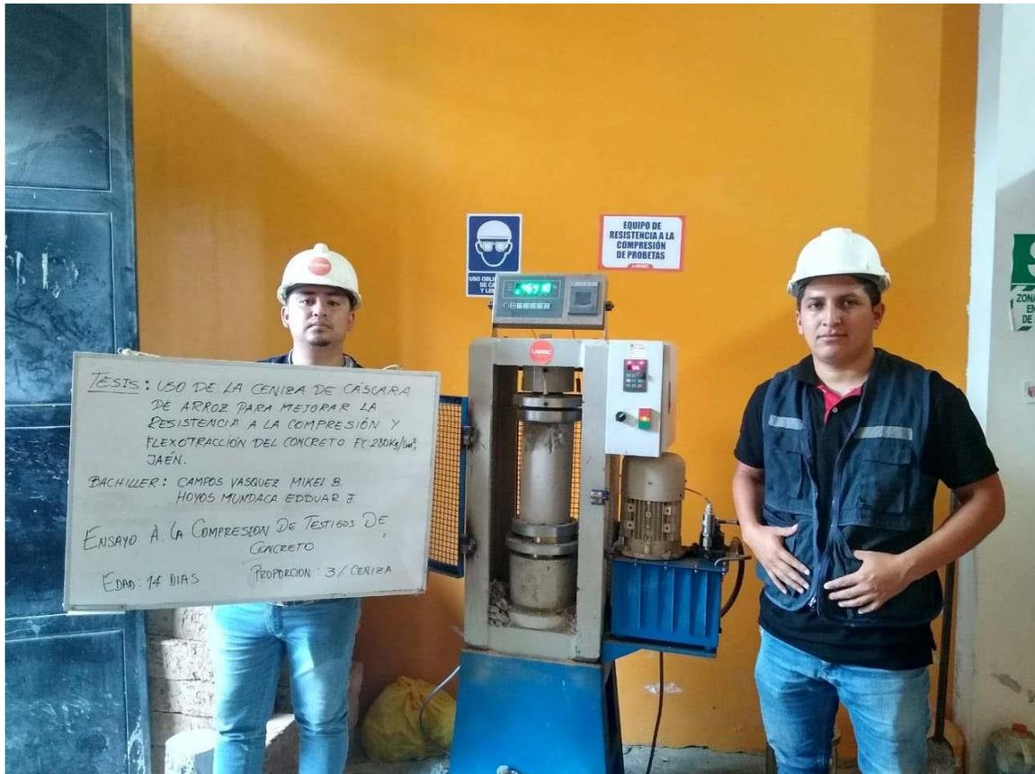
**FOTOGRAFIA 24:** Ensayo a compresión de testigos de concreto bajo la norma ASTM C39 de la muestra de concreto patrón adicionando el 3 % de ceniza a los 14 días del Proyecto Tesis: "Uso De Ceniza De Cascara De Arroz Para Mejorar La Resistencia A La Compresión Y Flexotracción Del Concreto F´C 280 Kg/Cm2"
