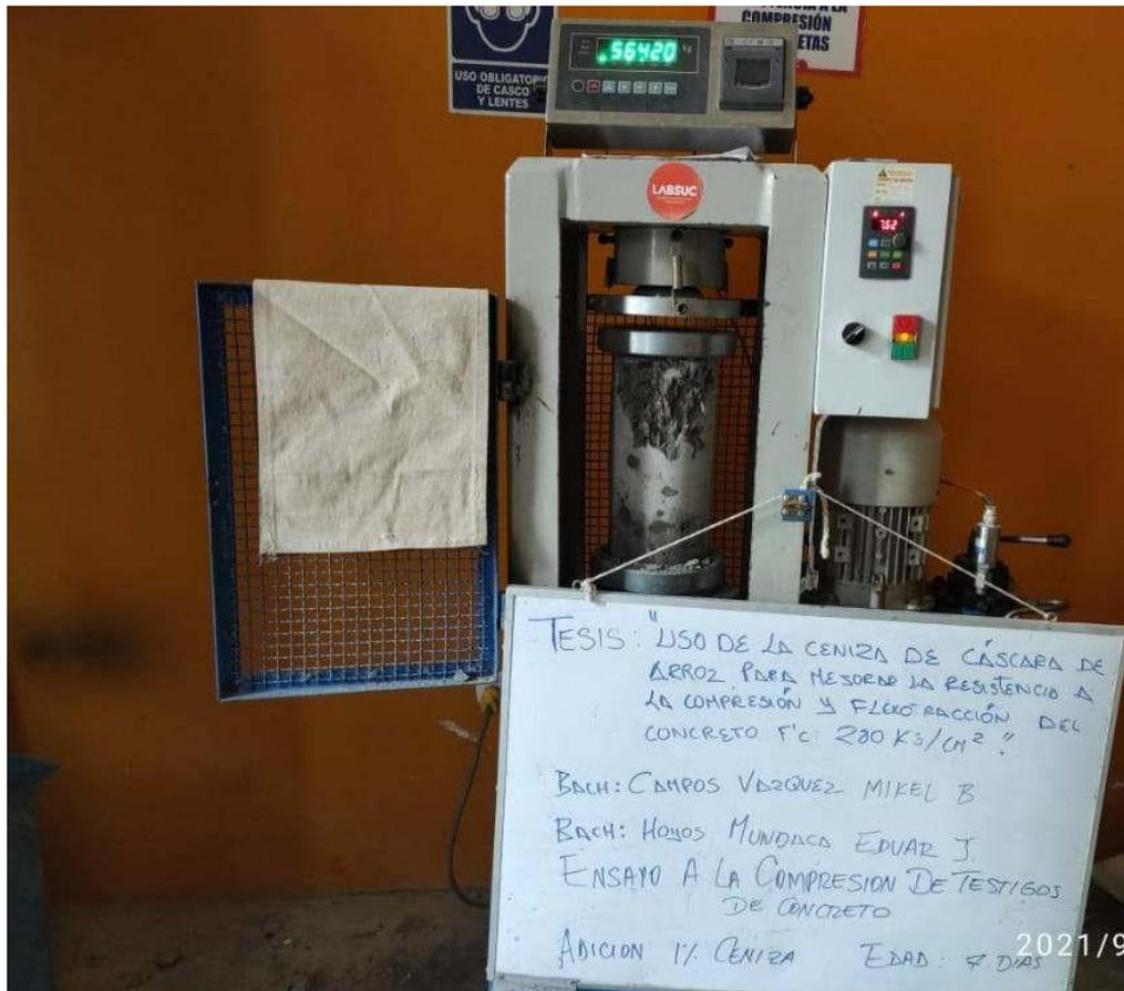
**FOTOGRAFIA 12:** Ensayo a compresión de testigos de concreto bajo la norma ASTM C39 de la muestra de concreto patrón adicionando el 1 % de ceniza a los 7 días del Proyecto Tesis: "Uso De Ceniza De Cascara De Arroz Para Mejorar La Resistencia A La Compresión Y Flexotracción Del Concreto F' C 280 Kg/Cm2"
