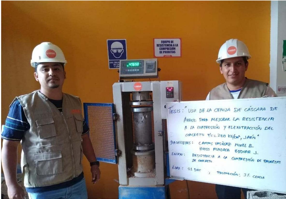
**FOTOGRAFIA 25:** Ensayo a compresión de testigos de concreto bajo la norma ASTM C39 de la muestra de concreto patrón adicionando el 3 % de ceniza a los 21 días del Proyecto Tesis: “Uso De Ceniza De Cascara De Arroz Para Mejorar La Resistencia A La Compresión Y Flexotracción Del Concreto F´C 280 Kg/Cm2”
