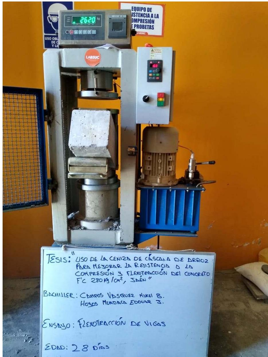
**FOTOGRAFIA 41:** Ensayo a Resistencia A La Flexión Del Concreto Endurecido ASTM C78 de la muestra de concreto patrón a los 28 días del Proyecto Tesis: "Uso De Ceniza De Cascara De Arroz Para Mejorar La Resistencia A La Compresión Y Flexotracción Del Concreto F'c 280 Kg/Cm2"
