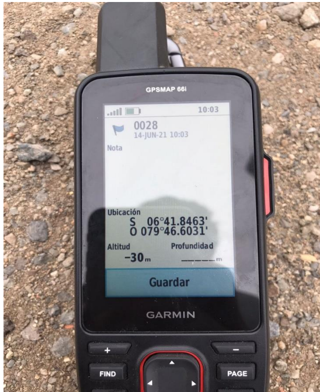
Figura 29. GPS Navegador Garmin MAP 66i. - Antena de alta sensibilidad.
