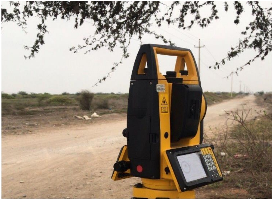
Figura 28. Teodolito Electrónico (Marca South n4)
