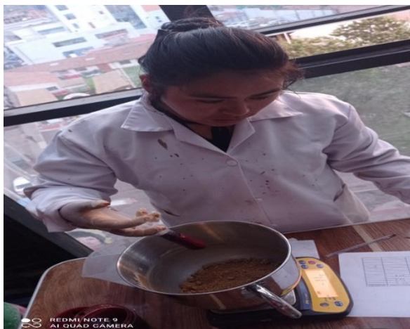
Figura 47. Ensayo de Proctor modificado con adición de sangre.
