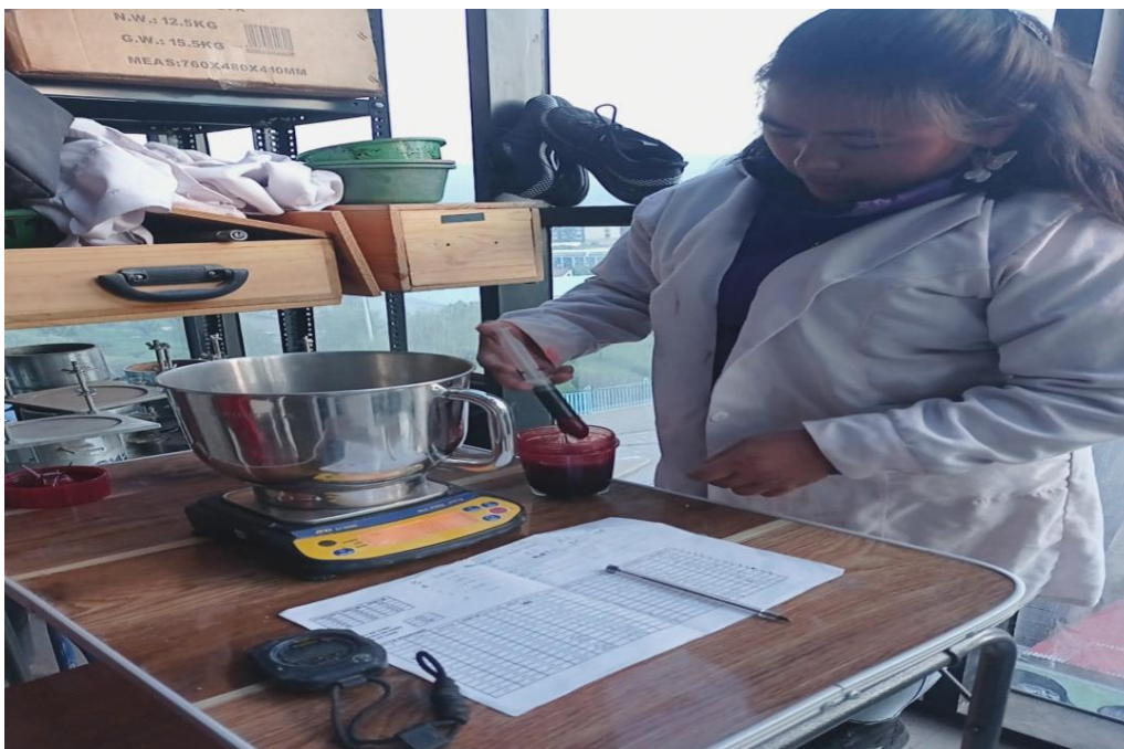
Figura N°25 Adicionando sangre a la muestra de suelo C-02 para en ensayo CBR sangre 0%,1%,2%,3%,4%.
