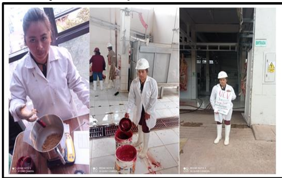
Figura 26. Adición de sangre al suelo limoso obtenido de la muestra C-2
