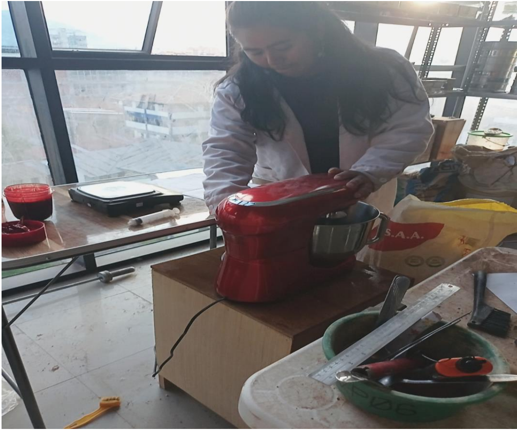
Figura N°26: mezclando la muestra más la adición de la sangre en una batidora
