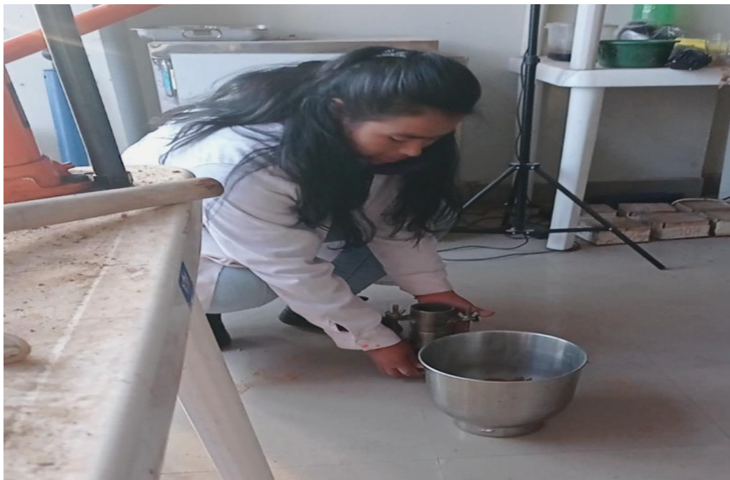
Figura 21: Compactación con pisón a la muestra de suelo C-02 Mas la adición de sangre 0%,1%,2%,3%,4%.
