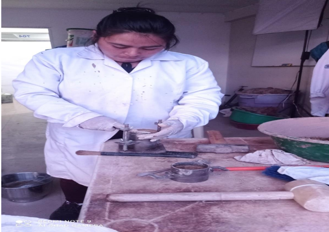
Figura 22: Compactación con pisón a la muestra de suelo C-02 Mas la adición de sangre 0%,1%,2%,3%,4%.
