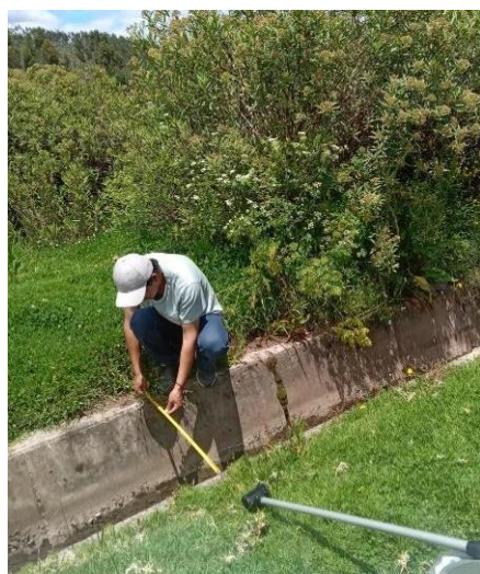
Figura 9: Corroboración de la sección indicada en el proyecto
