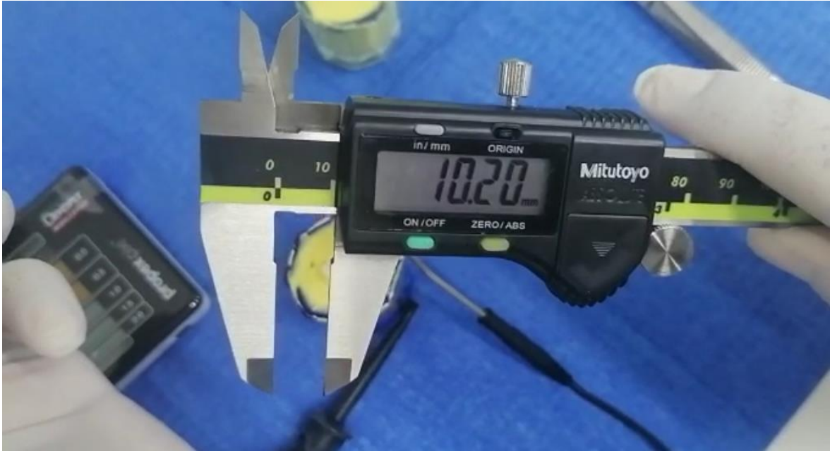
Foto 32. Lectura de la longitud con el calibrador digital Mitutoyo ®.
