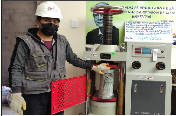
Foto 13. Rotura de las muestras cilíndricas (resistencia en compresión)
