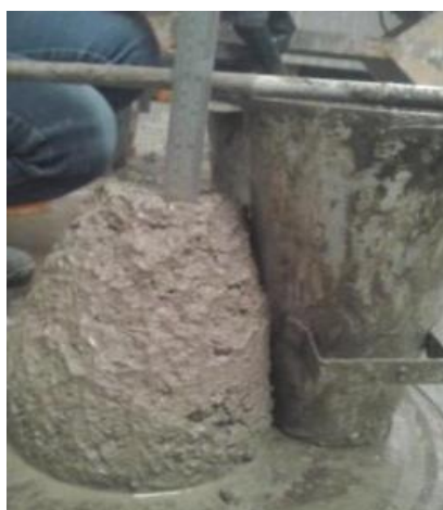
Figura 2. Ensayo de revenimiento (Cono de Abrams)
