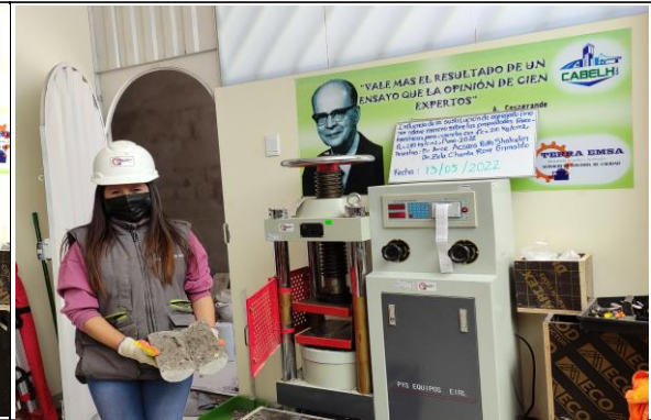
Foto 14. Rotura de las muestras cilíndricas (resistencia en tracción)
