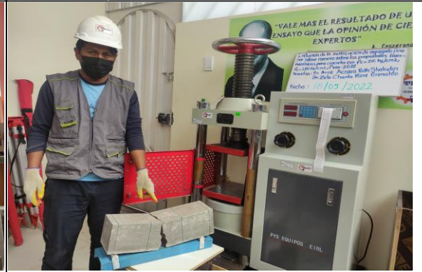
Foto 16. Rotura de vigas de concreto (resistencia en flexión)
