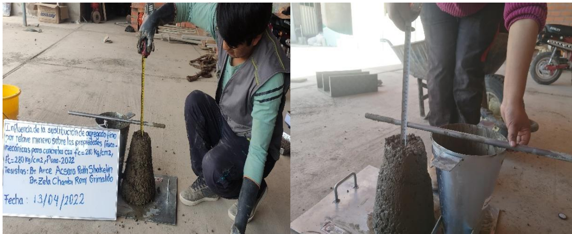
Figura 33. Ensayo de asentamiento y consistencia del concreto
