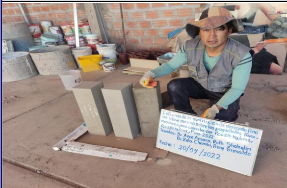
Foto 11. Desmoldado de las vigas de concreto, para ser curadas.
