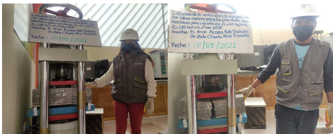
Figura 56. Vigas de concreto ensayadas en flexión
