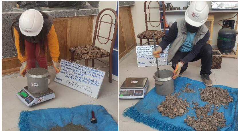
Figura 31. Determinación de peso unitario de los agregados
