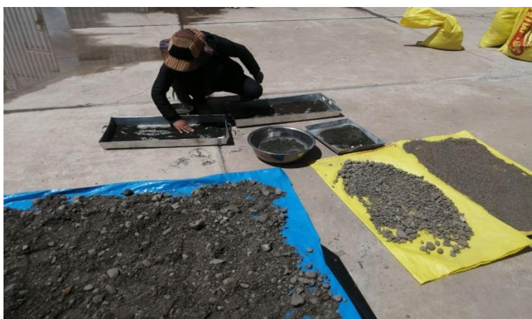
Figura 17. secado y separación de los agregados
