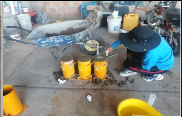
Foto 10. Elavoracion de las briquetas cilíndricas.
