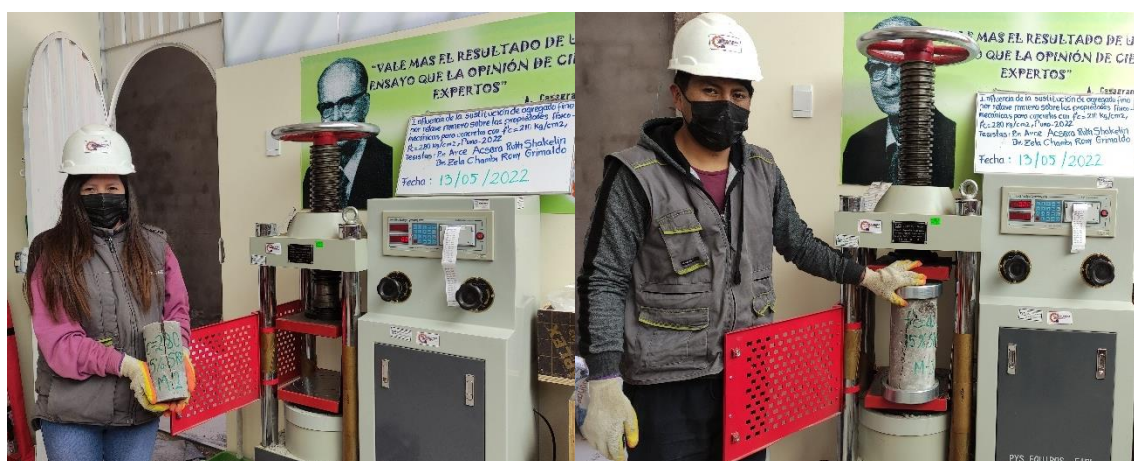
Figura 38. Probetas rotas en resistencia en compresión
