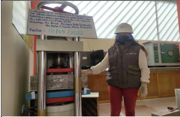
Foto 15. Rotura de vigas de concreto (resistencia en flexión)
