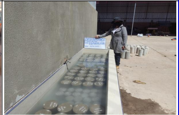
Foto 12. Curado de las muestras de concreto, surmergido en agua.
