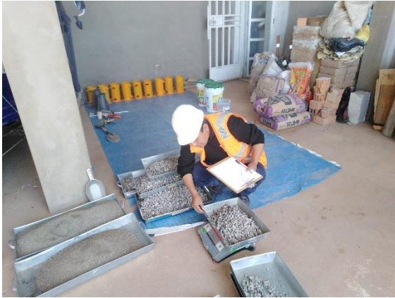
Figura 7. Pesado de material para la mezcla de concreto
