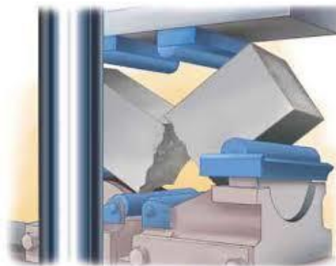
Figura 7. Ensayo a flexión de tipo viga de concreto
