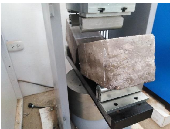
Figura 29. Rotura de la resistencia a la flexión
