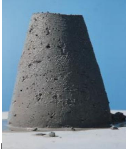
Figura 4. Concreto con consistencia rígida (bajo asentamiento o bajo revenimiento).
