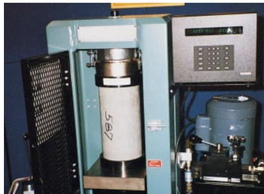
Figura 6. Ensayo a compresión de cilindro de concreto
