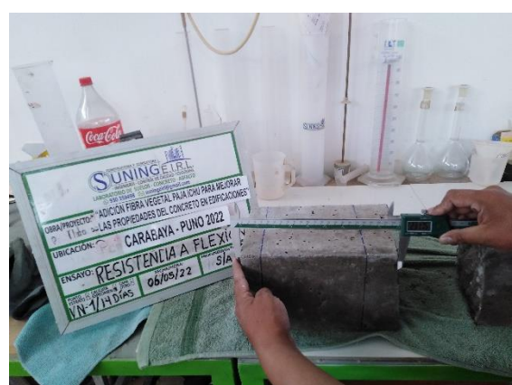
Figura 30. Medición de longitud de rotura de la viga
