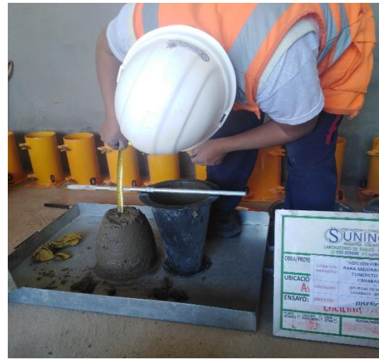
Figura 16. Medición de asentamiento
