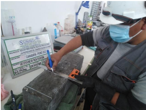
Figura 27. Trazo antes de realizar la rotura a flexión
