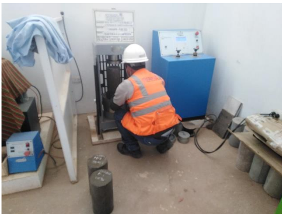
Figura 23. Alineación de probeta cilíndrica
