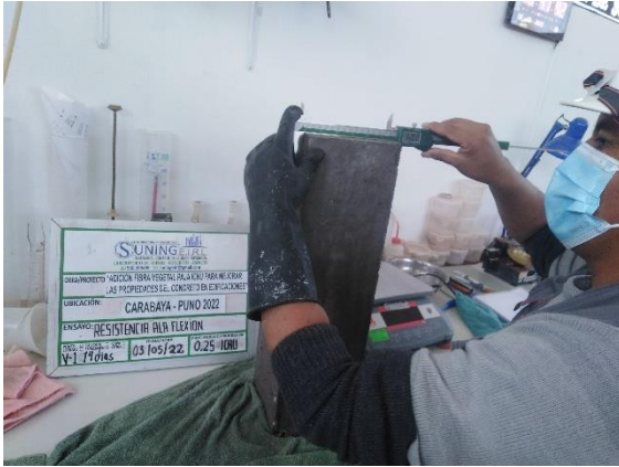
Figura 25. Medición de sección de la viga
