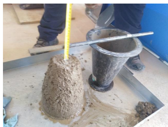
Figura 10. Asentamiento del concreto con adición ichu
