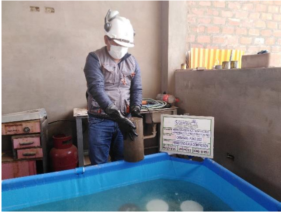
Figura 19. Extrayendo la probeta del curado
