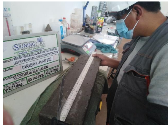
Figura 26. Medición de longitud de la viga
