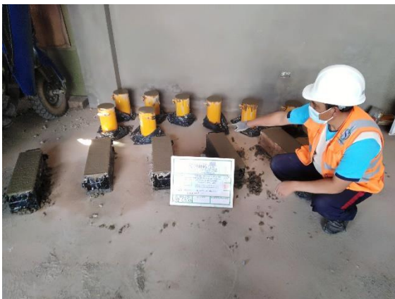
Figura 17. Elaboración de probetas cilíndricas y vigas
