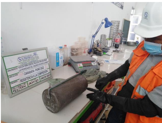
Figura 21. Medición de longitud de la probeta cilíndrica
