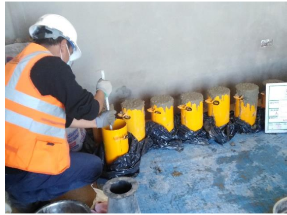
Figura 14. Elaboración de probeta cilíndrica
