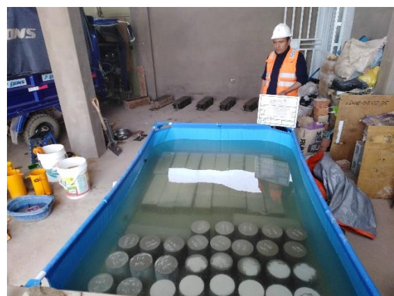
Figura 18. Curado de probetas y vigas
