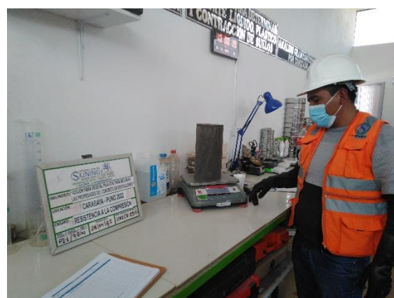
Figura 22. Peso de la probeta cilíndrica
