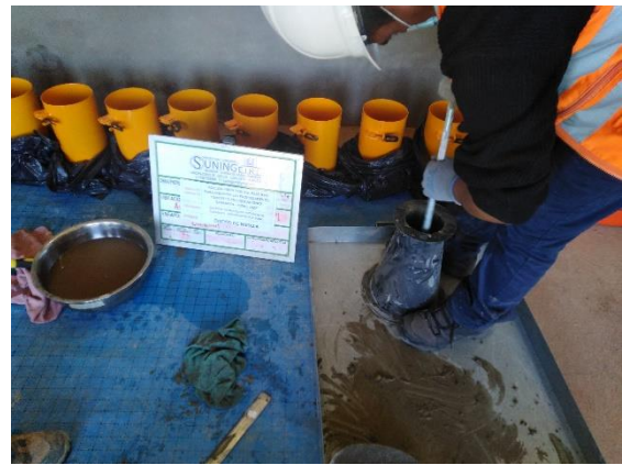
Figura 8. Asentamiento de concreto
