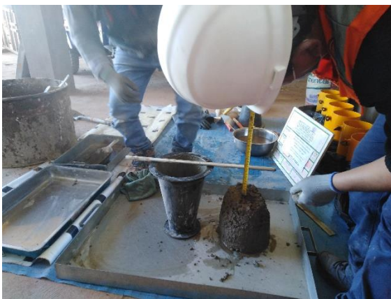
Figura 9. Asentamiento del concreto patrón
