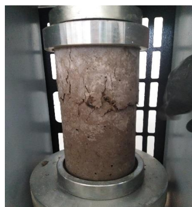
Figura 24. Rotura a la compresión
