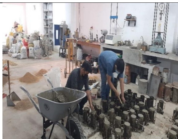
Figura 28. Llenado de moldes y apisonado de mezcla de concreto en tres capas iguales.
