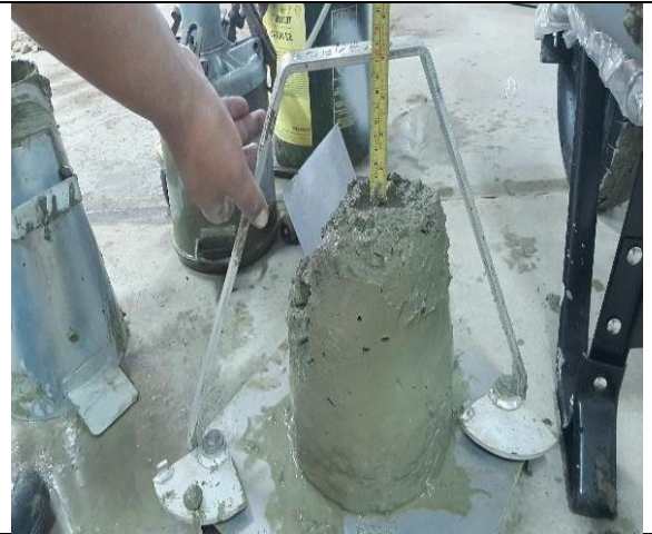
Figura 20. Comprobación de asentamiento del concreto, ensayo de slump método con el cono de abrams.
