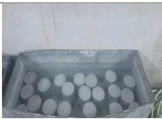
Figura 36. Curado de briquetas de concreto de F'c=280\text{Kg/cm}^2 .
