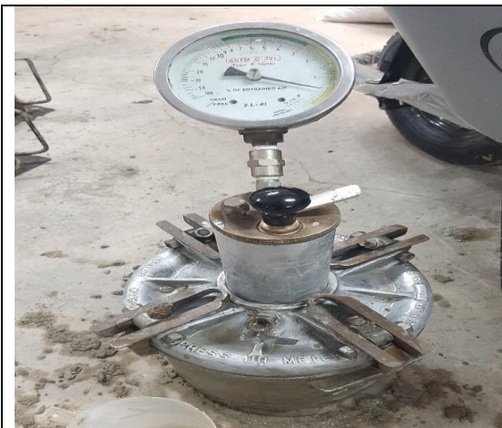
Figura 25. Lectura del ensayo método olla Washington por presión hidrostática (Instrumento de ensayo del contenido de aire).
