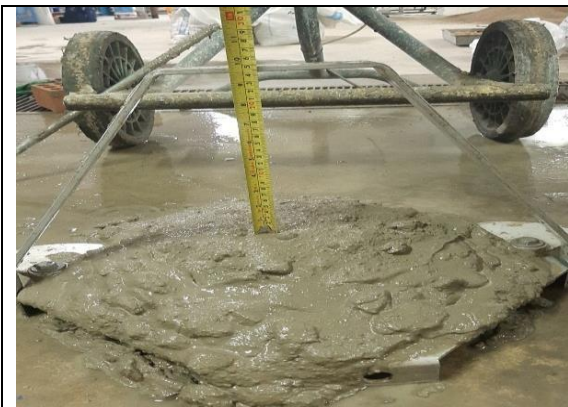
Figura 31. Comprobación de asentamiento del concreto, ensayo de slump método con el cono de abrams
