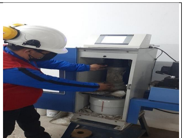
Figura 42. Rotura de briquetas de concreto (patrón vs aditivo) F'c=280\text{Kg/cm}2 patrón vs aditivo.
