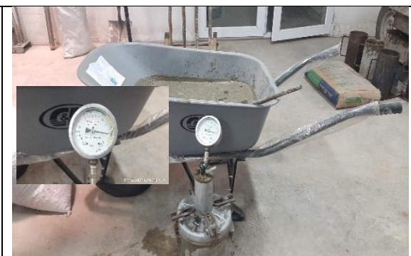
Figura 18. Lectura del ensayo método olla Washington por presión hidrostática (Instrumento de ensayo del contenido de aire).
