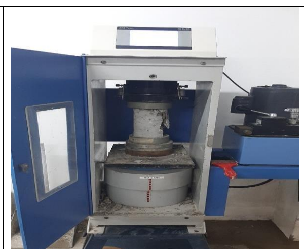
Figura 48. Rotura de briquetas de concreto (patrón vs aditivo) F'c=280\text{Kg/cm}^2 patrón vs aditivo.
