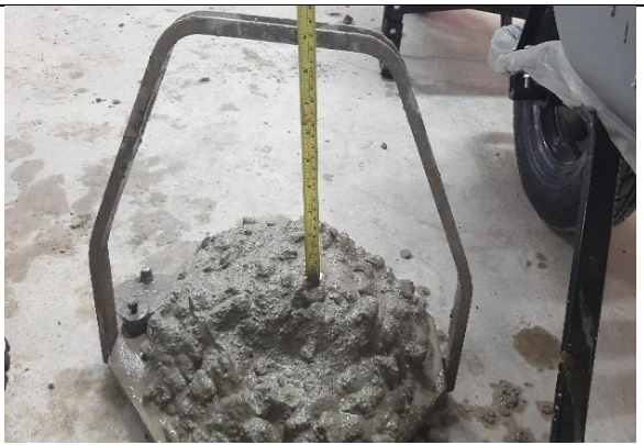
Figura 22. Comprobación de asentamiento del concreto, ensayo de slump método con el cono de abrams.
