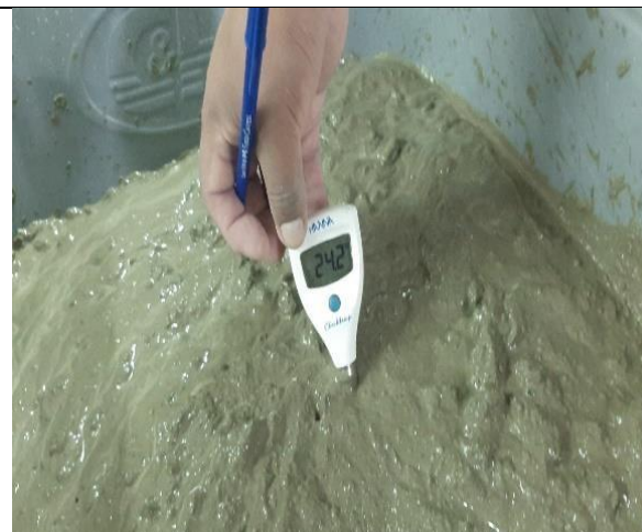
Figura 11. Temperatura del concreto patrón.
