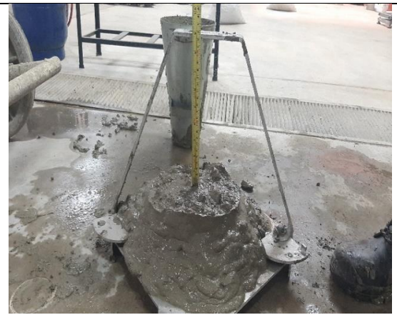
Figura 10. Comprobación de asentamiento del concreto patrón, ensayo de slump método con el cono de abrams.
