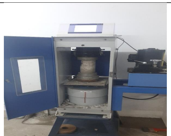
Figura 41. Rotura de briquetas de concreto (patrón vs aditivo) F'c=280\text{Kg/cm}2 patrón vs aditivo.
