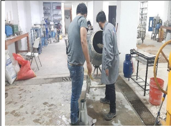
Figura 07. Mezcla del concreto patrón.
