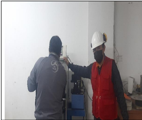
Figura 37. Rotura de briquetas de concreto (patrón vs aditivo) F'c=280\text{Kg/cm}2 patrón vs aditivo.
