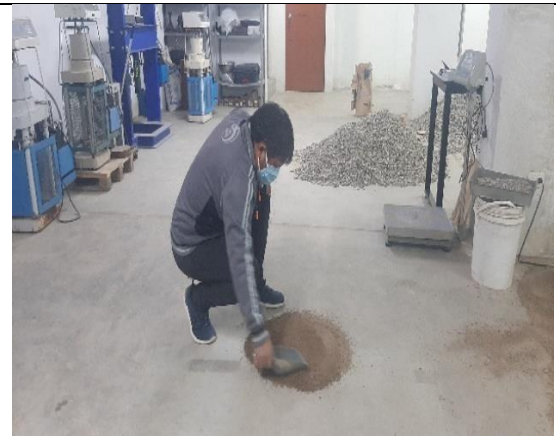
Figura 02. Muestreo y cuarteo de agregado para determinación de propiedades.
