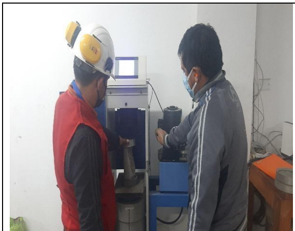
Figura 39. Rotura de briquetas de concreto (patrón vs aditivo) F'c=280\text{Kg/cm}2 patrón vs aditivo.
