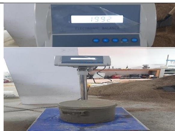
Figura 29. Lectura de peso del ensayo método olla Washington por presión hidrostática (concreto con aditivo PLASTOL 200EXT AL 1.5%).
