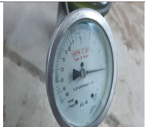
Figura 12. Lectura del ensayo método olla Washington por presión hidrostática (Instrumento de ensayo del contenido de aire).
