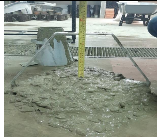
Figura 19. Comprobación de asentamiento del concreto, ensayo de slump método con el cono de abrams.
