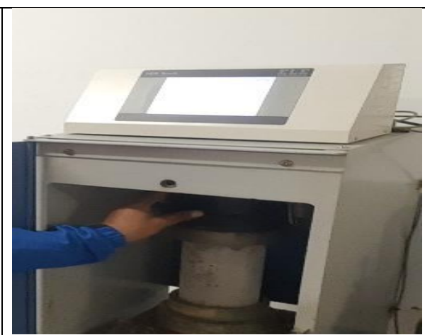
Figura 46. Rotura de briquetas de concreto (patrón vs aditivo) F'c=280\text{Kg/cm}^2 patrón vs aditivo.
