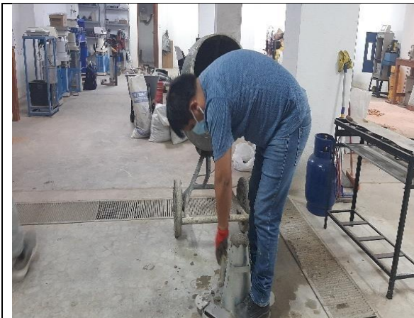
Figura 09. Comprobación de asentamiento del concreto patrón, ensayo de slump método con el cono de abrams.
