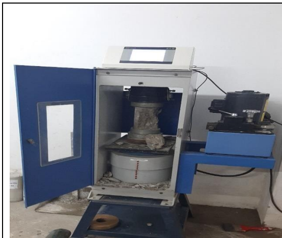
Figura 43. Rotura de briquetas de concreto (patrón vs aditivo) F'c=280\text{Kg/cm}^2 patrón vs aditivo.
