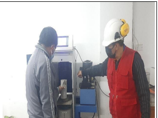
Figura 40. Rotura de briquetas de concreto (patrón vs aditivo) F'c=280\text{Kg/cm}2 patrón vs aditivo.
