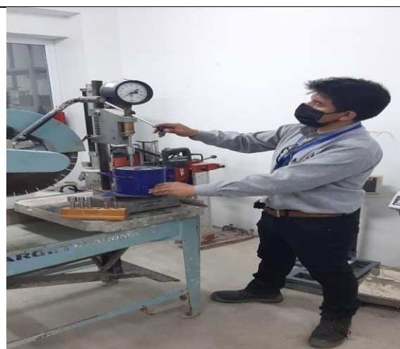
Figura 34. Lectura del penetrómetro de fraguado del concreto
