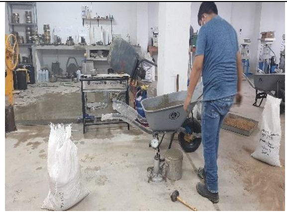
Figura 14. Ensayo método olla Washington por presión hidrostática (Instrumento de ensayo del contenido de aire).
