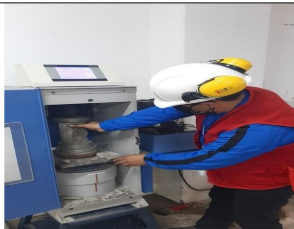
Figura 44. Rotura de briquetas de concreto (patrón vs aditivo) F'c=280\text{Kg/cm}^2 patrón vs aditivo.
