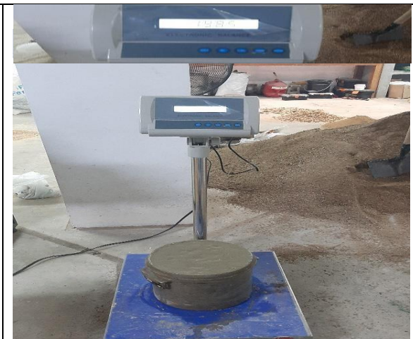
Figura 24. Lectura de peso del ensayo método olla Washington por presión hidrostática (concreto con aditivo PLASTOL 200EXT AL 1.0%).
