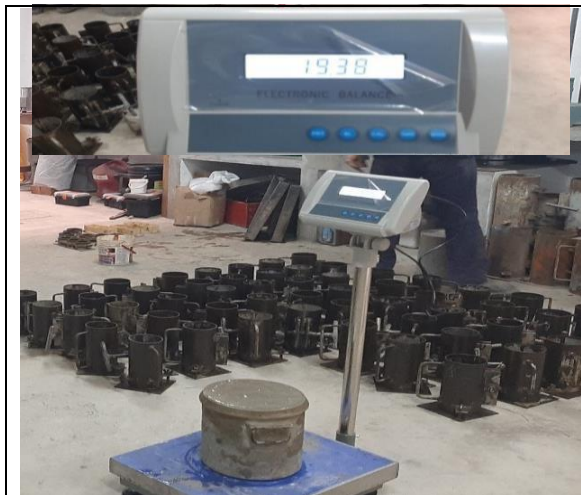
Figura 15. Lectura de peso del ensayo método olla Washington por presión hidrostática (concreto patrón).
