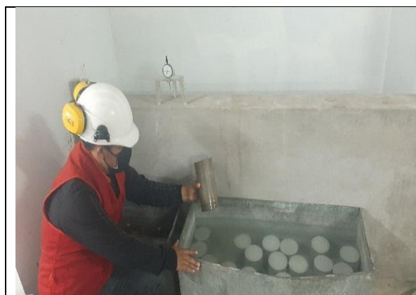
Figura 35. Curado de briquetas de concreto de F'c=280\text{Kg/cm}^2 .
