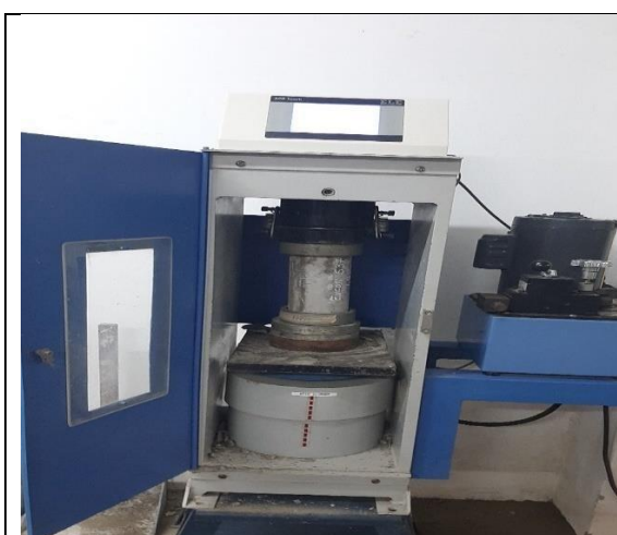
Figura 47. Rotura de briquetas de concreto (patrón vs aditivo) F'c=280\text{Kg/cm}^2 patrón vs aditivo.
