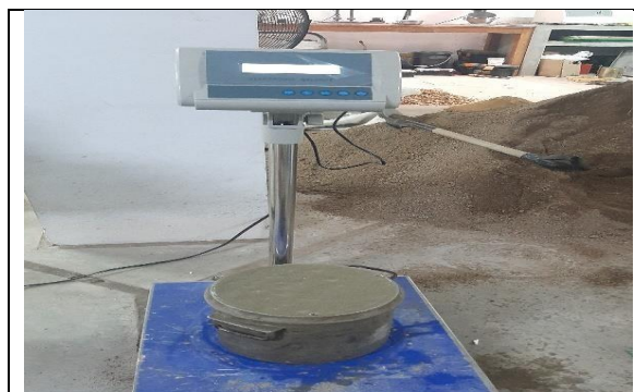
Figura 17. Lectura de peso del ensayo método olla Washington por presión hidrostática (concreto con aditivo PLASTOL 200EXT AL 0.5%).
