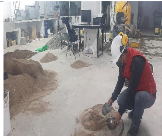
Figura 04. Muestreo y cuarteo de agregado para determinación de propiedades.
