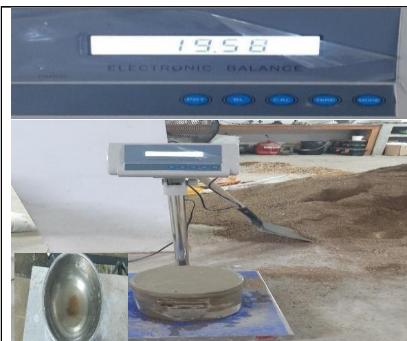
Figura 33. Lectura de peso del ensayo método olla Washington por presión hidrostática (concreto con aditivo EUCON 537 al 1.0%).
