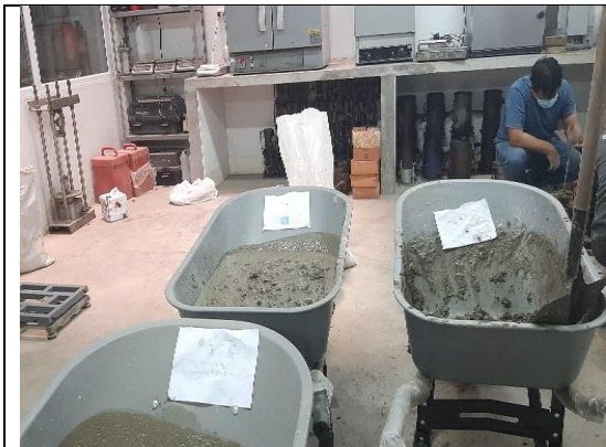
Figura 21. Concreto con aditivo PLASTOL 200EXT a 0.5%, 1.0%.
