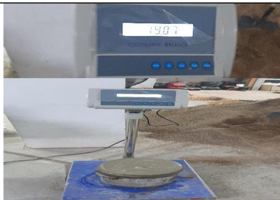
Figura 32. Lectura de peso del ensayo método olla Washington por presión hidrostática (concreto con aditivo EUCON al 0.5%)
