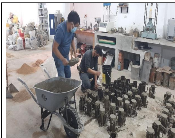
Figura 27. Llenado de moldes y apisonado de mezcla de concreto en tres capas iguales.
