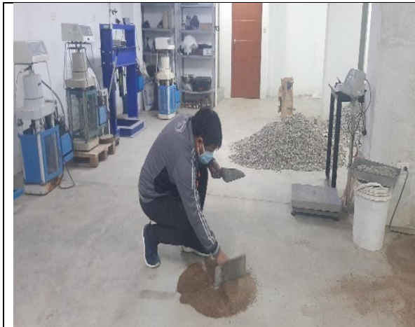
Figura 03. Muestreo y cuarteo de agregado para determinación de propiedades.
