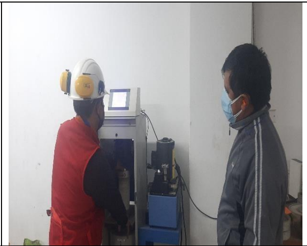
Figura 38. Rotura de briquetas de concreto (patrón vs aditivo) F'c=280\text{Kg/cm}2 patrón vs aditivo.
