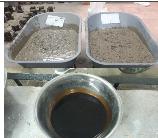
Figura 23. Concreto con aditivo PLASTOL 200EXT a 1.0%, 1.5%.
