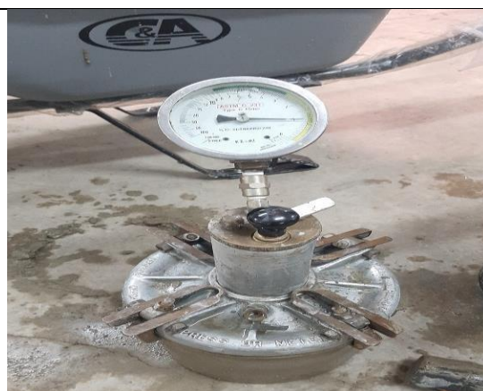
Figura 30. Lectura del ensayo método olla Washington por presión hidrostática (Instrumento de ensayo del contenido de aire).
