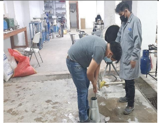
Figura 08 ensayo de slump método con el cono de abrams.
