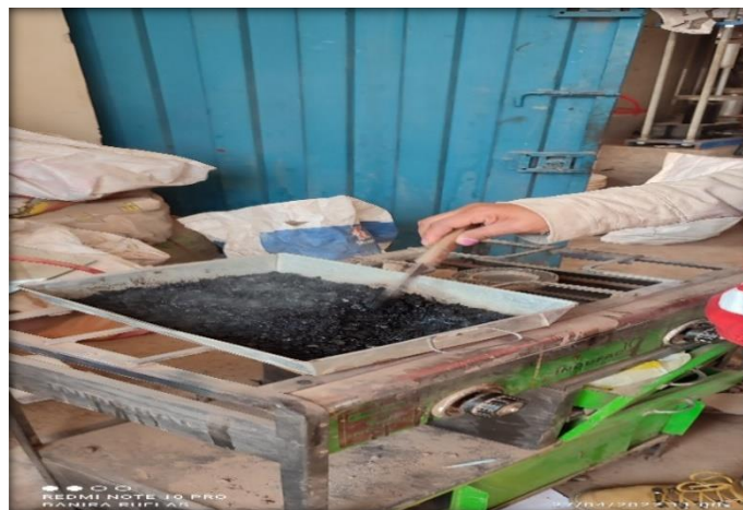
Figura 31. Colocado del CA al agregado
