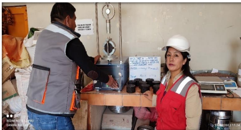
Figura 33. Ensayo Marshall convencional
