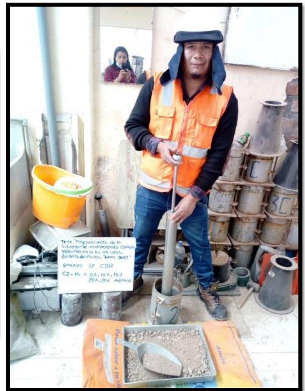
**Fotografía 19:** Ensayo de CBR con adición cenizas volantes 10%, 15%, 20% y 25% de calicata C-01 y C-02.
