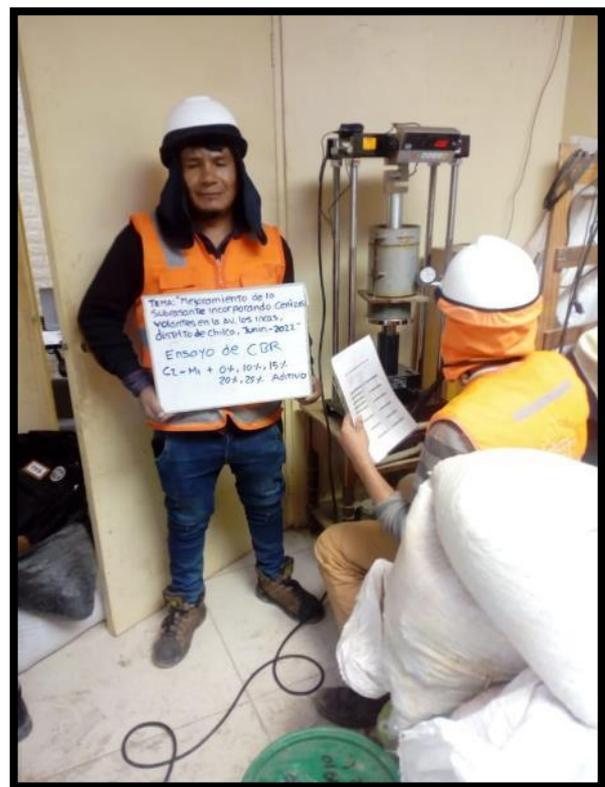
**Fotografía 20:** Ensayo de CBR con adición cenizas volantes 10%, 15%, 20% y 25% de calicata C-01 y C-02.
