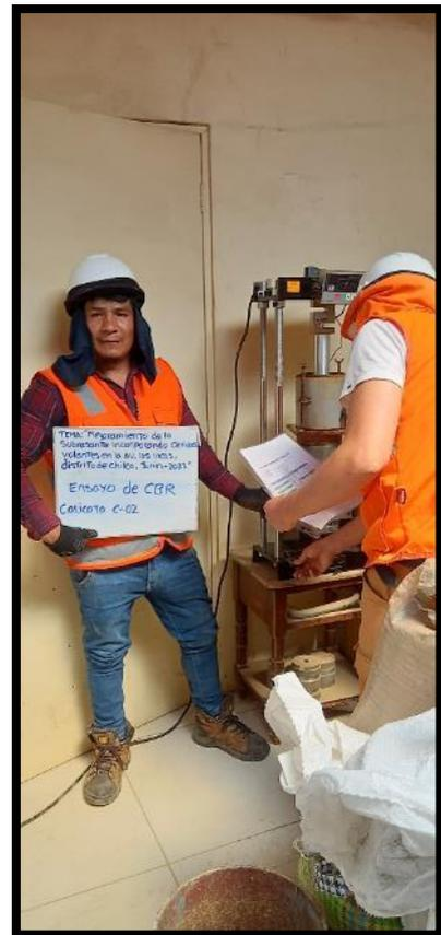
**Fotografía 14:** Ensayo de CBR Calicata C-01 y C-02
