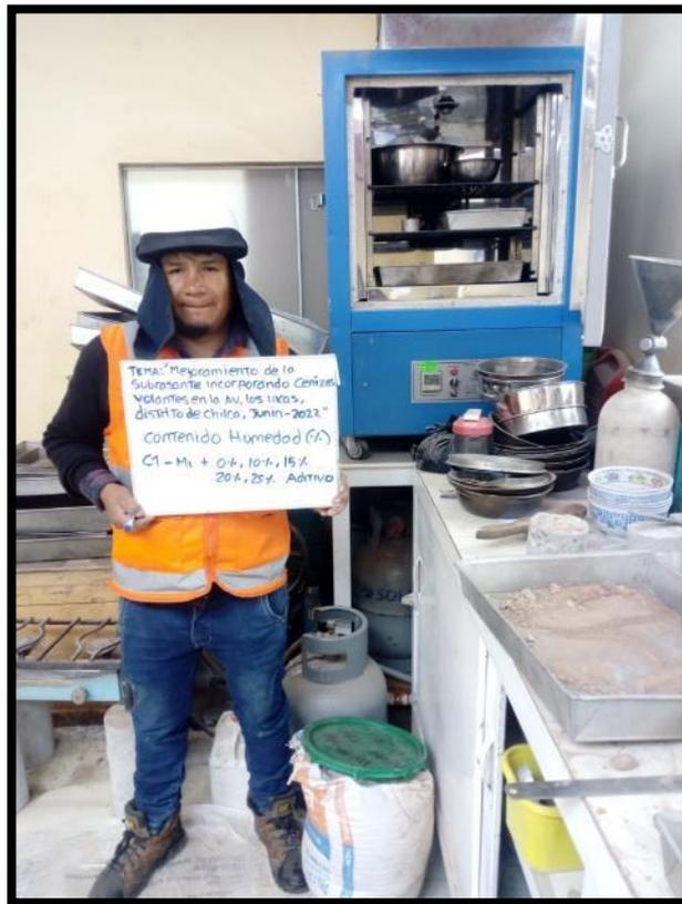
**Fotografía 17:** Contenido humedad con adición cenizas volantes 10%, 15%, 20% y 25% Calicata C-01 y C-02.
