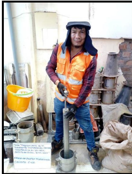
**Fotografía 11:** Ensayo Proctor Modificado Calicata C-01 y C-02
