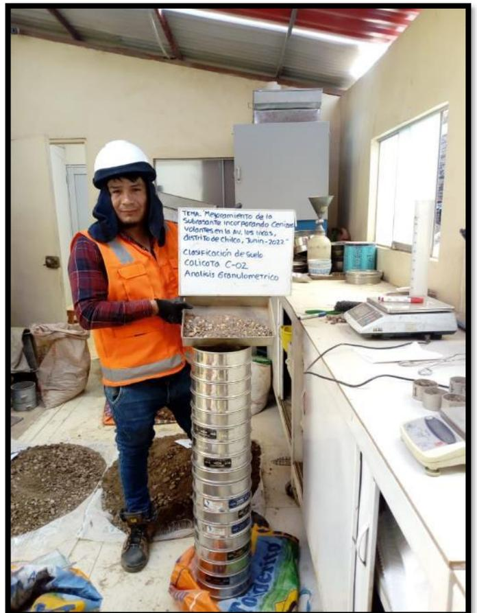
**Fotografía 8: Análisis Granulométrico Calicata C-01 y C-02**
