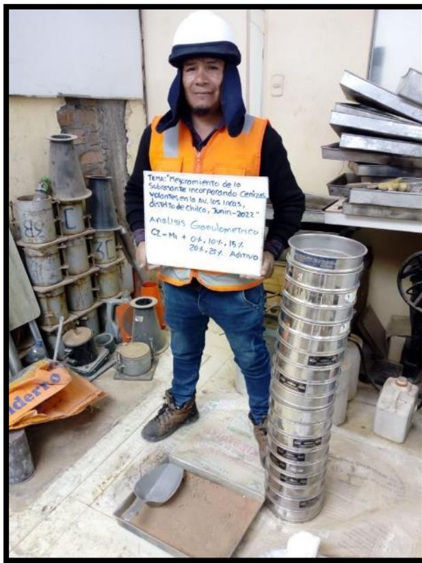
**Fotografía 15:** Análisis Granulométrico con adición cenizas volantes 10%, 15%, 20% y 25 de calicata C-01 y C-02.
