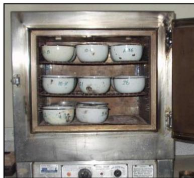
*Figura 5. Contenido de Humedad: Horno de secado a 110 °C.*
