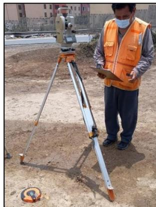
*Figura 11.* Topógrafo, teodolito y cinta métrica.
