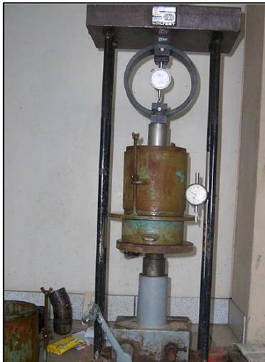
*Figura 6.* Prensa para Ensayo CBR (California Bearing Ratio).
