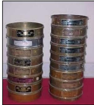
*Figura 4. Análisis granulométrico: Tamices.*
