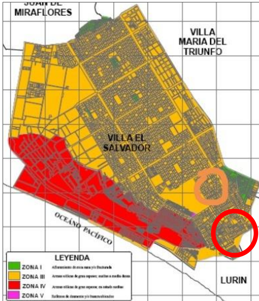
Figura 1 Mapa de microzonificación sísmica del distrito de Villa El Salvador y ubicación del caso.
