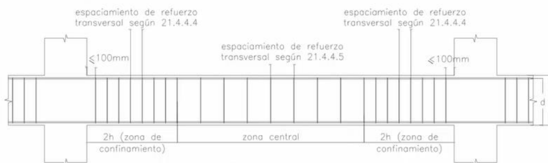
Fig. 21.4.4 Requerimientos de estribos en vigas.
