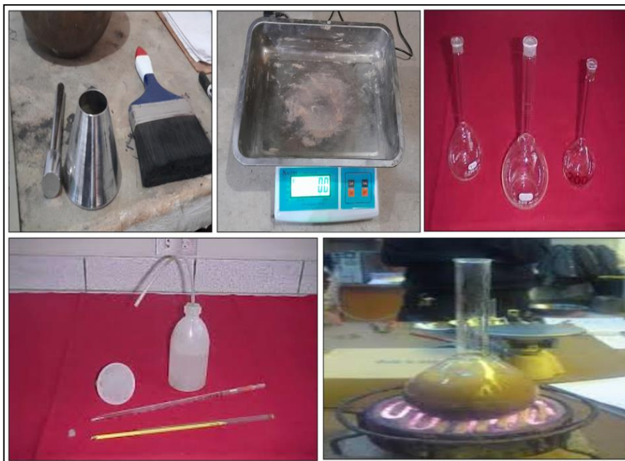
Figura 8. Instrumentos y equipos para el Peso Específico.
