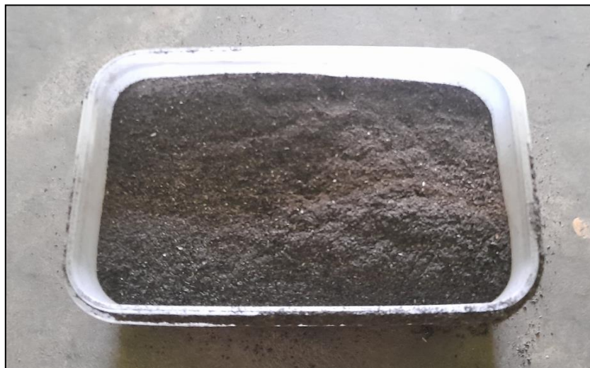
Figura 16. Obtención de cenizas de hojas de bambú.
