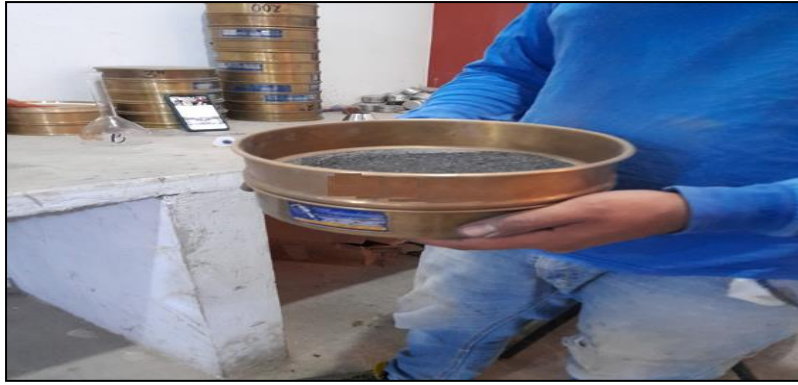
Figura 17. Tamizado de cenizas de hojas de bambú por tamiz N° 200.
