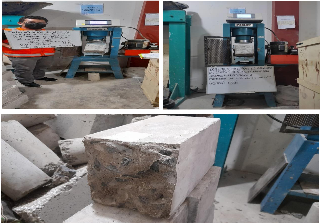
Figura 41. Ensayo de resistencia a flexión de muestras tipo viga
