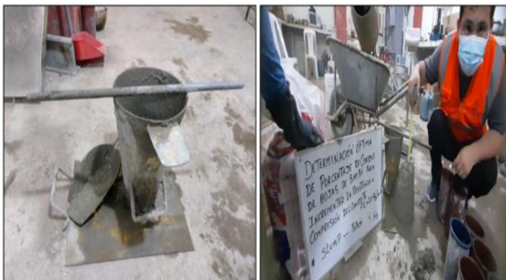
Figura 22. Medición de asentamiento de la mezcla de concreto en laboratorio (Slump)
