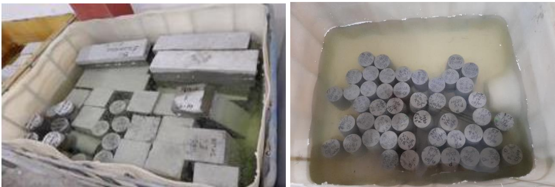
Figura 39. Curado de probetas cilíndricas y tipo viga
