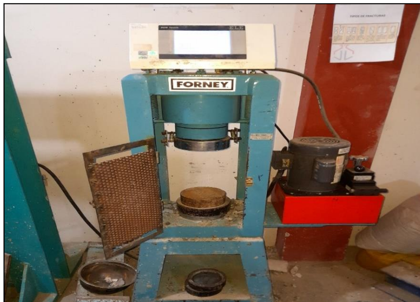
Figura 10. Equipo para ensayo de resistencia a la compresión
