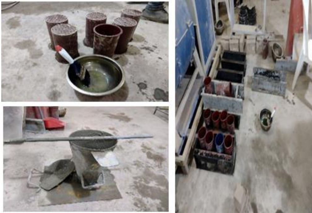
Figura 36. Instrumentos para el ensayo de asentamiento y moldes para probetas cilíndricas y tipo viga
