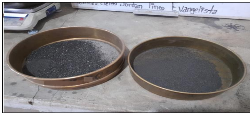
Figura 18. Tamizado de cenizas de hoja de bambú.
