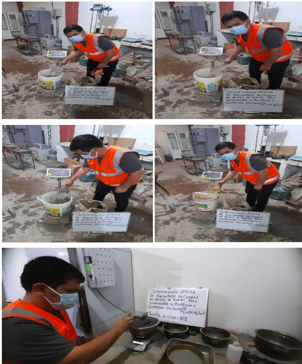
Figura 34. Pesaje de los agregados, agua y cenizas de hoja de bambú
