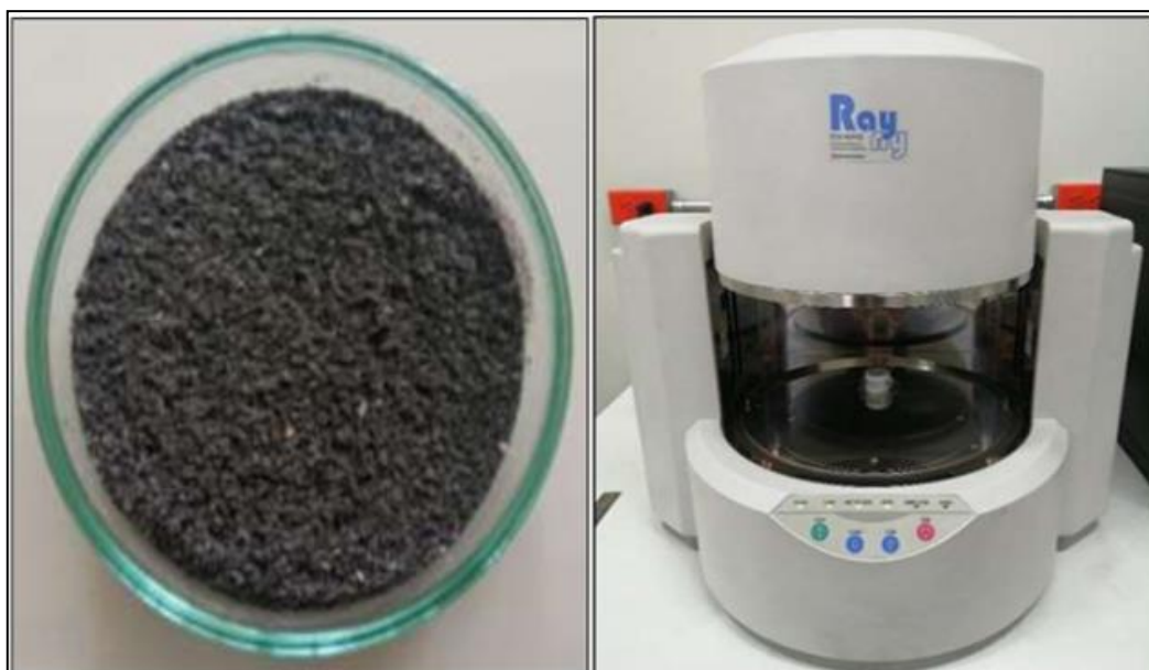
Figura 21. Muestra de ceniza de hoja de bambú y equipo para análisis de composición química.
