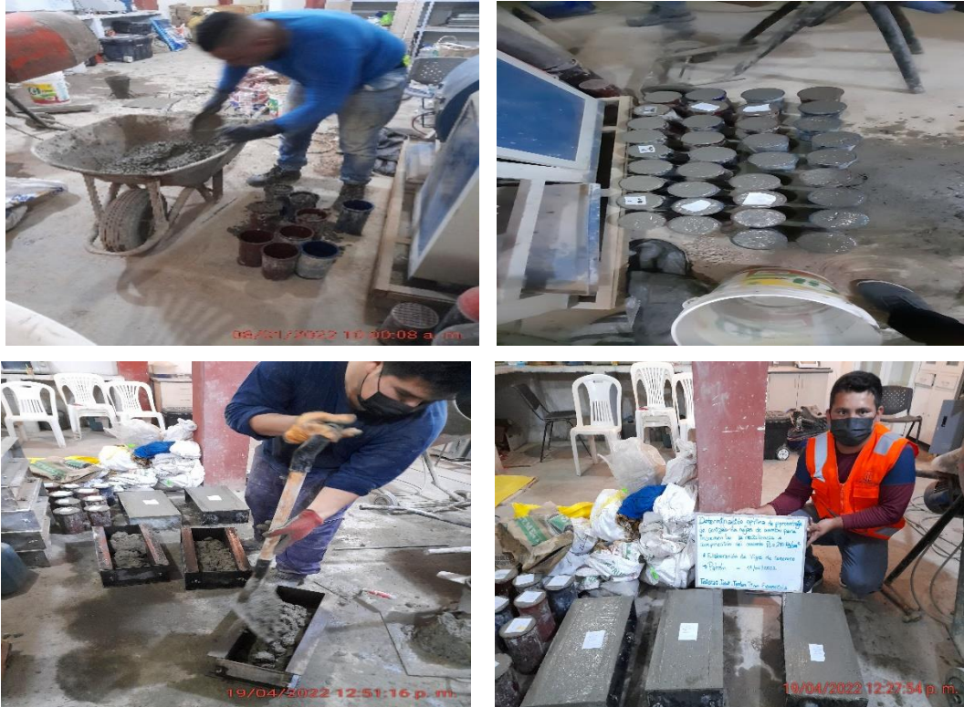
Figura 38. Muestreo de probetas cilíndricas y tipo viga
