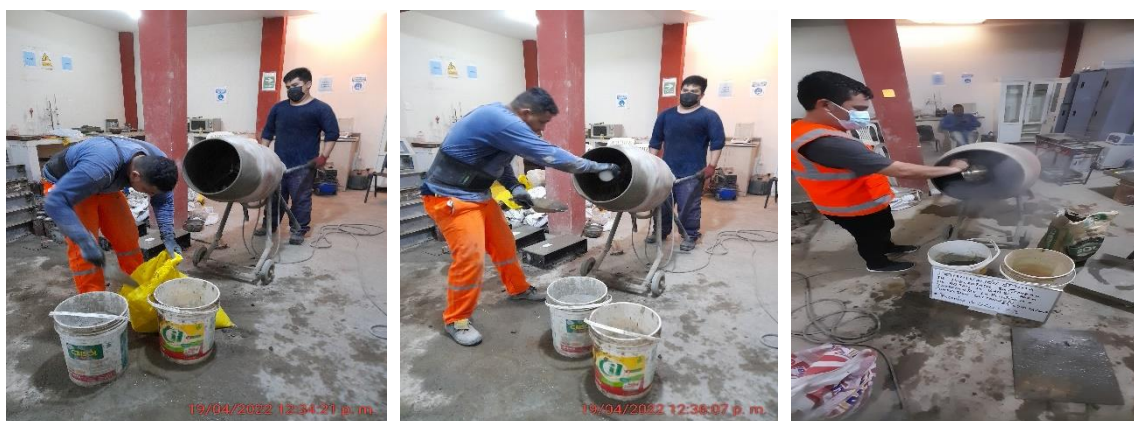
Figura 35. Elaboración de concreto para muestreo
