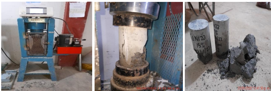
Figura 40. Ensayo de resistencia a compresión de muestras cilíndricas
