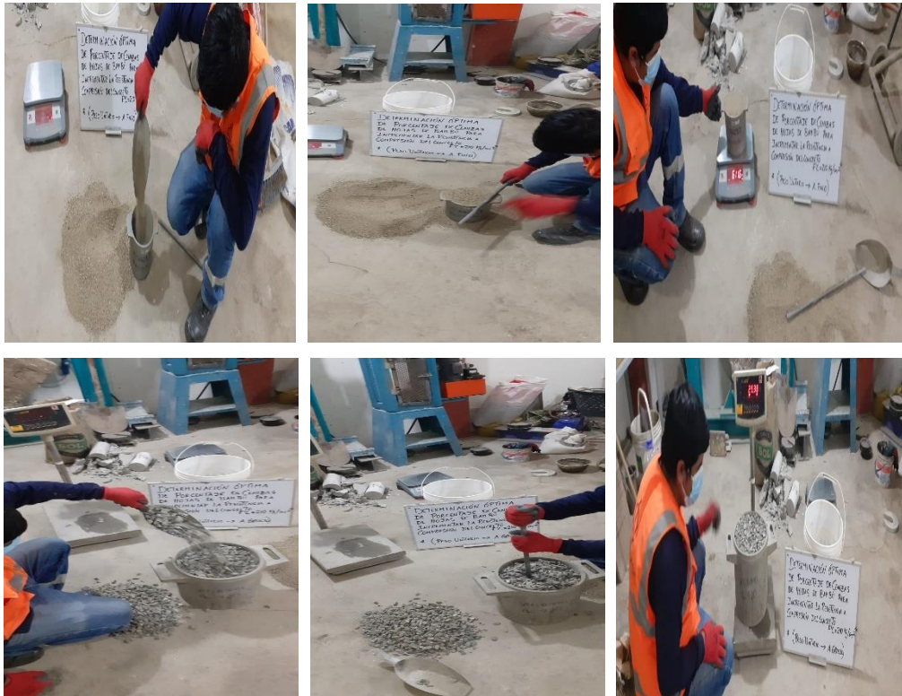
Figura 32. Pesado del agregado (fino y grueso) suelto y compactado
