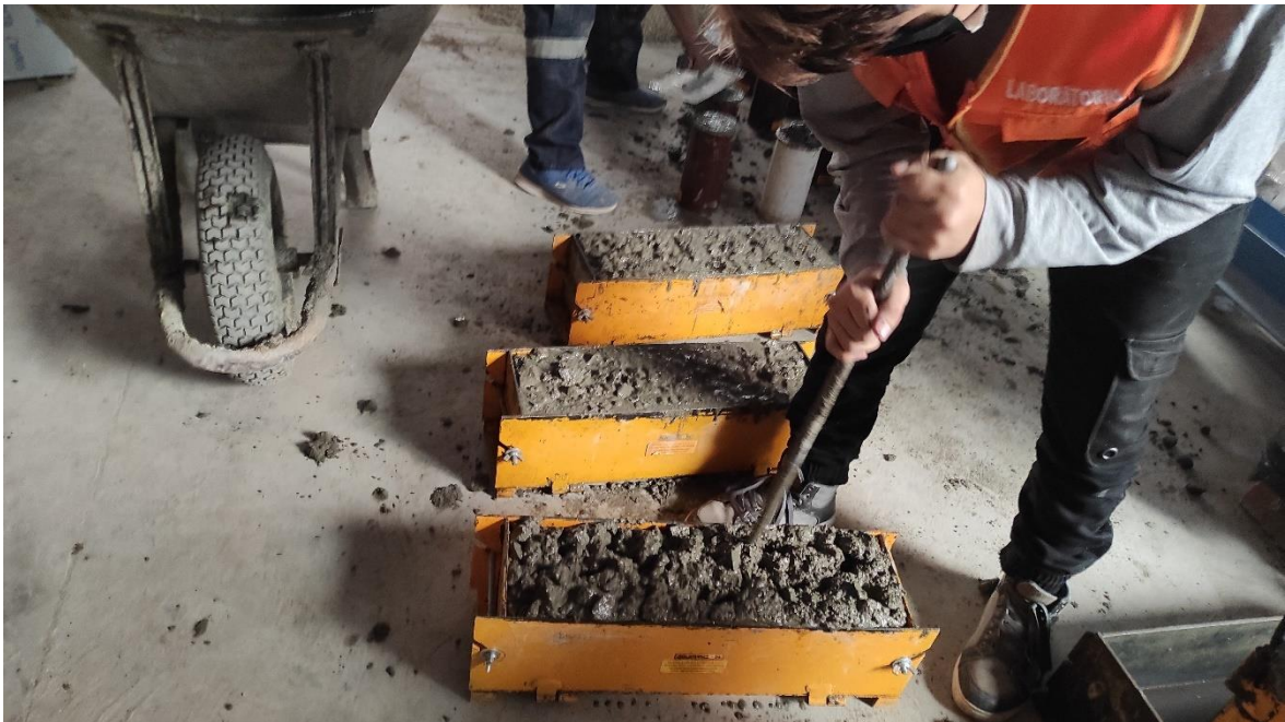
Foto N°4. Vaciado en probetas prismáticas
