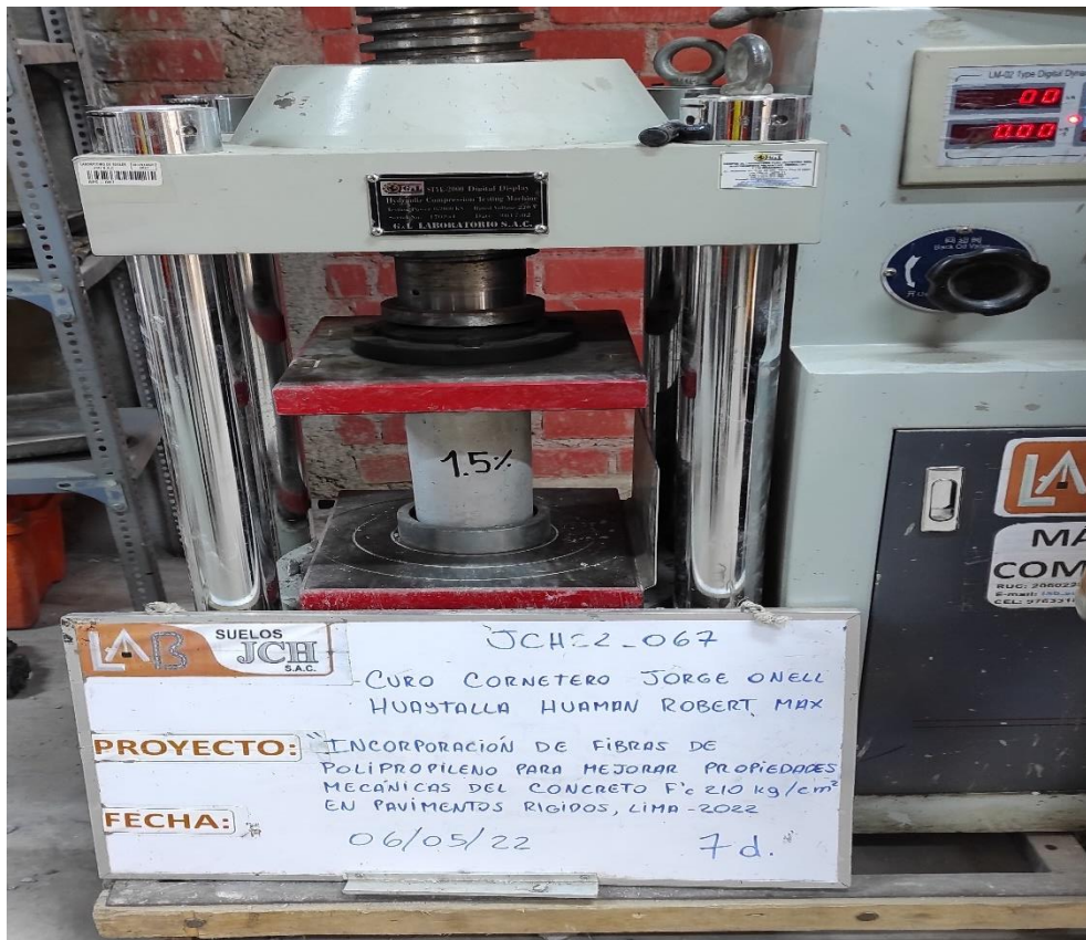
Foto N°9. Ensayo de resistencia a la compresión 7 días
