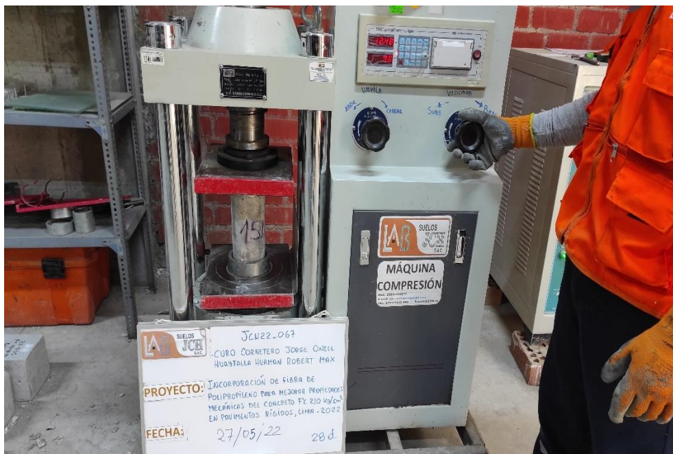
Foto N°10. Ensayo de resistencia a la compresión 28 días
