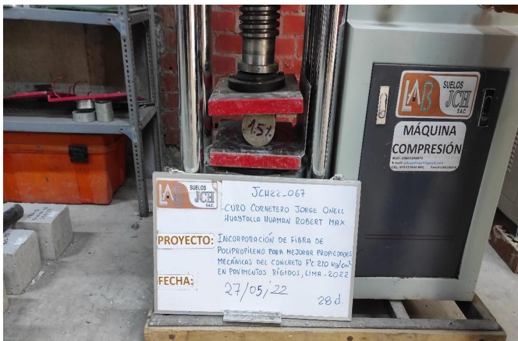
Foto N°12. Ensayo de resistencia a la tracción 28 días
