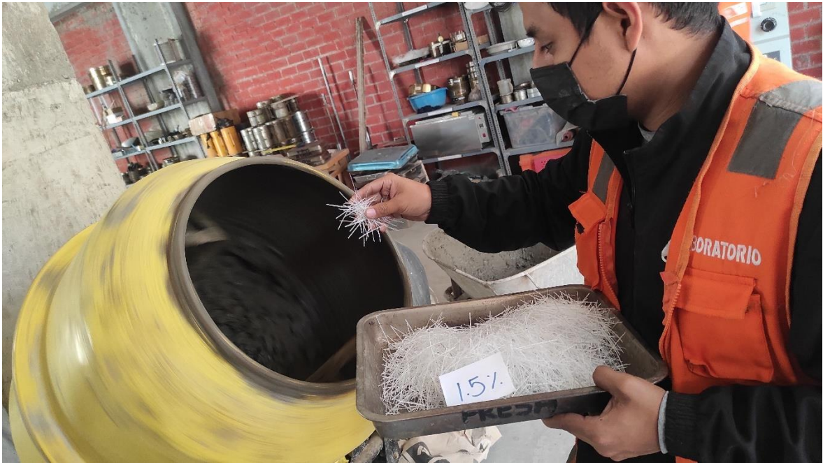
Foto N°1. Vaciado de polipropileno en la mezcla
