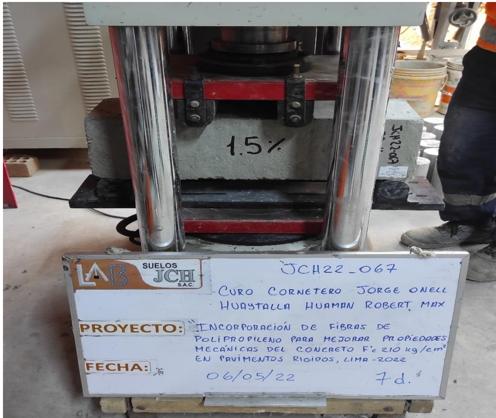
Foto N° 13. Ensayo de resistencia a la flexión 7 días
