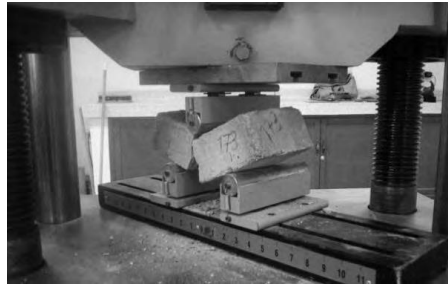
Figura 3. Ensayo de resistencia a la flexión a las vigas. Tomado de «researchgate.net», por Nelson Afanador.
