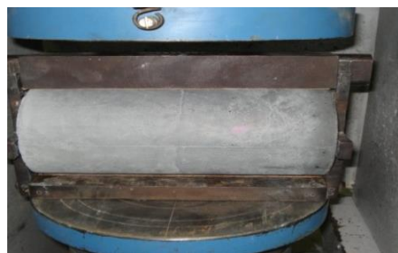
Figura 2. Ensayo de resistencia a la tracción por compresión diametral. Tomado de «researchgate.net», por Hugo E. Eguez.
