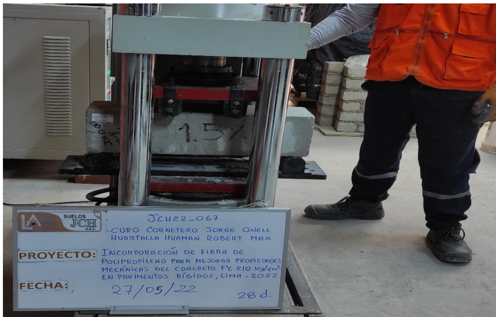
Foto N° 14. Ensayo de resistencia a la flexión 28 días
