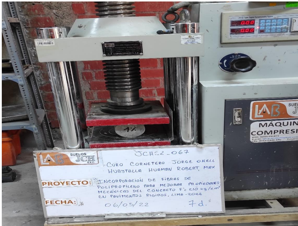
Foto N°11. Ensayo de resistencia a la tracción 7 días
