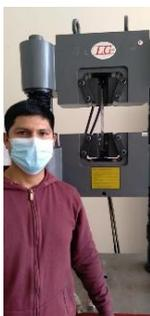
**Figura 8.** Ensayos compresión radial del Asbesto de Cemento
