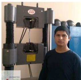
**Figura 9.** Ensayos de tracción polietileno de alta densidad HDPE
