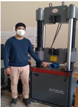
**Figura 4.** Ensayos tracción
