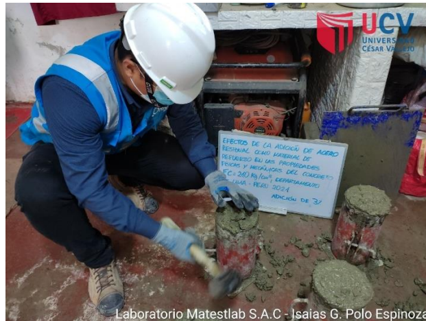
Figura 44: Golpeo con martillo de goma para evitar vacíos de aire
