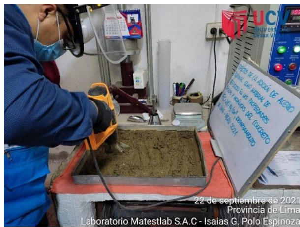
Figura 28: Secado de la muestra de agregado fino
