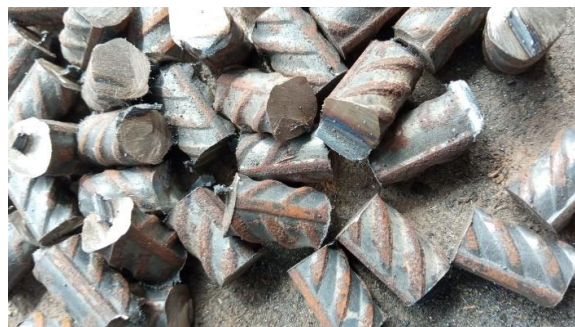
Figura 15: Dados de acero de 3/8" de 1.5cm de longitud
