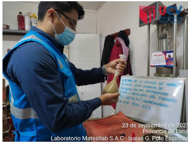
Figura 30: Adición de la muestra llenada con agua en la fiola
