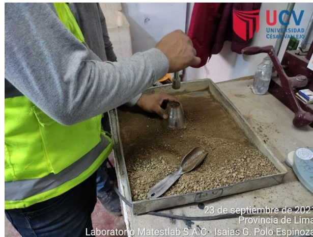
Figura 29: Ensayo del estado saturado superficialmente seco (S.S.S.)
