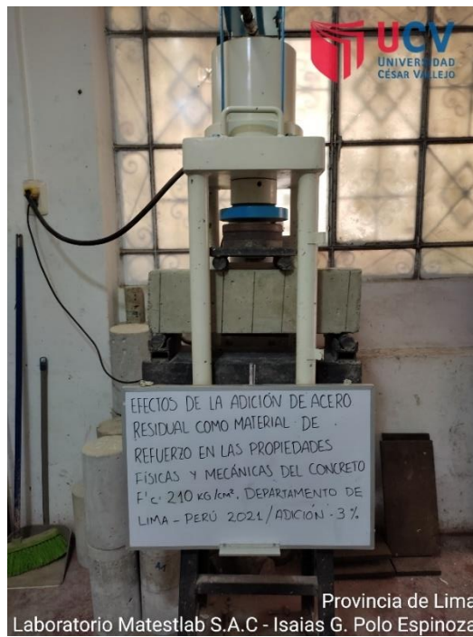
Figura 56: Ensayo de roturas para la resistencia a flexión
