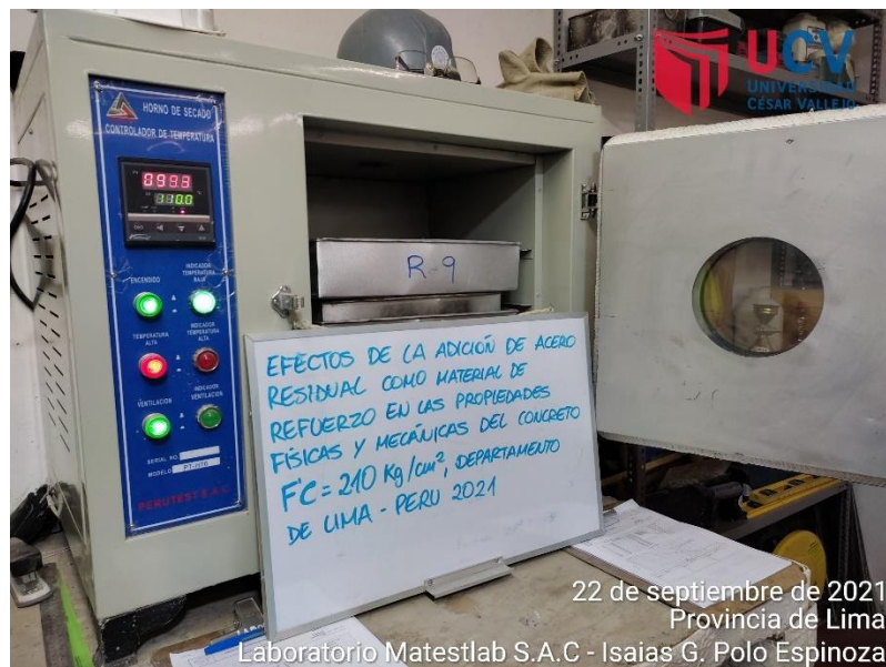
Figura 16: Horno digital PT-H76 196L 0° A 300°C
