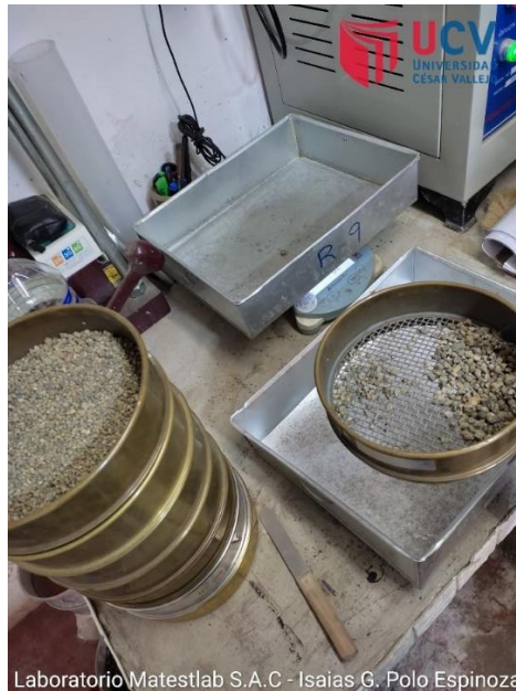
Figura 18: Módulo de fineza para el agregado fino
