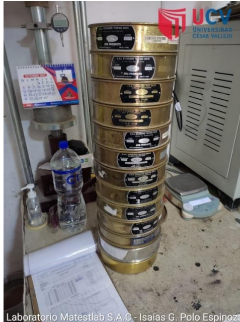
Figura 17: Juego de tamices para el ensayo de granulometría
