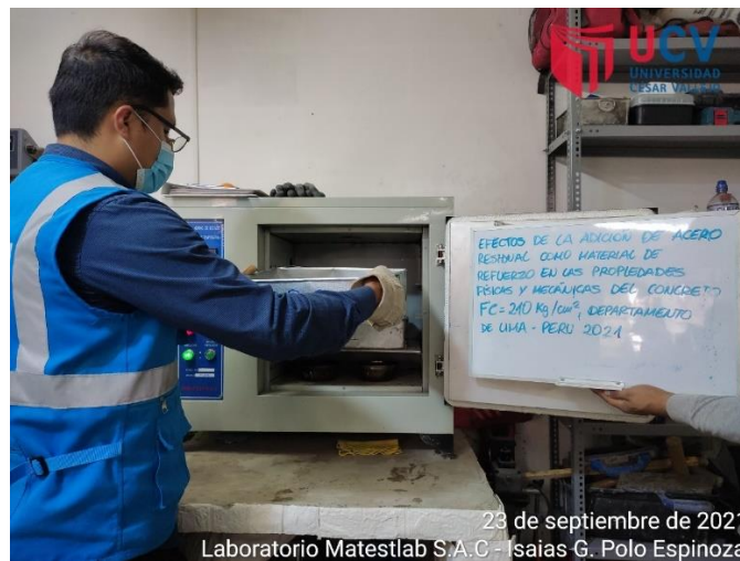
Figura 36: Colocación de la muestra de agregado grueso al horno
