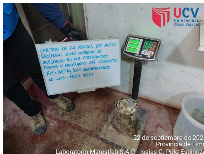
Figura 26: Peso unitario compactado del agregado grueso
