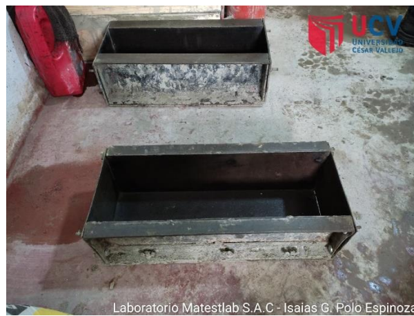
Figura 42: Molde tipo viga con dimensiones de 50cm longitud y sección de 15cm x 15cm
