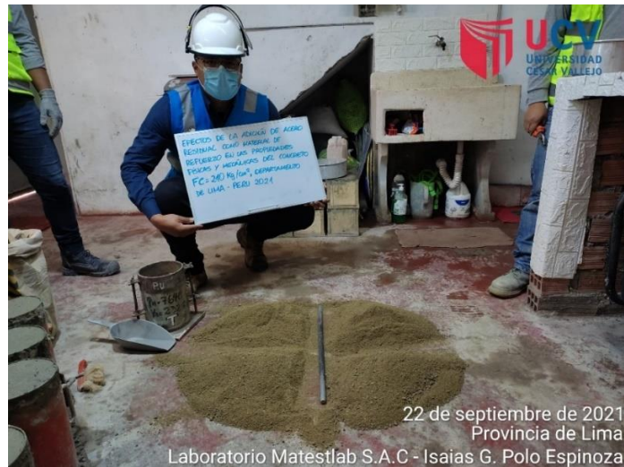
Figura 21: Cuarteo del agregado fino
