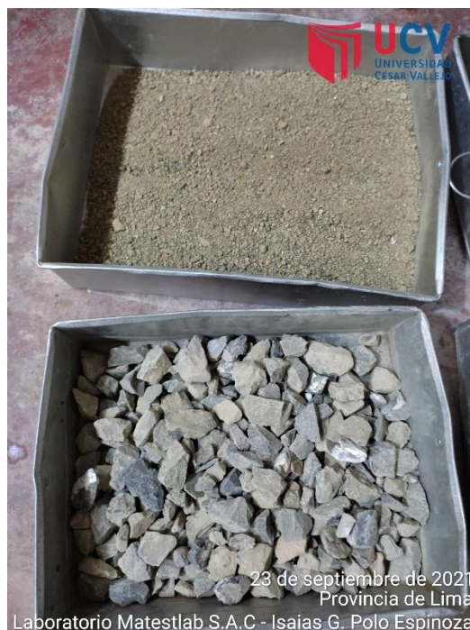
Figura 20: Muestras secas luego de 24 horas en el horno a 100°C
