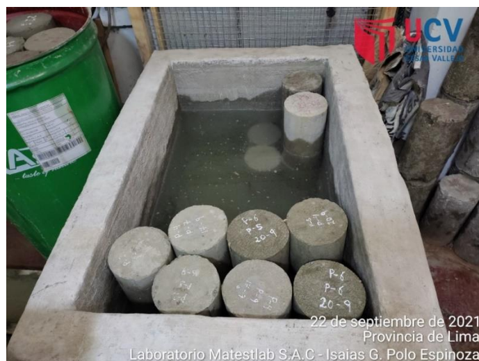
Figura 47: Curado de probetas en piscina
