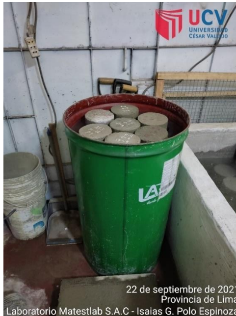
Figura 48: Curado de probetas en cilindros
