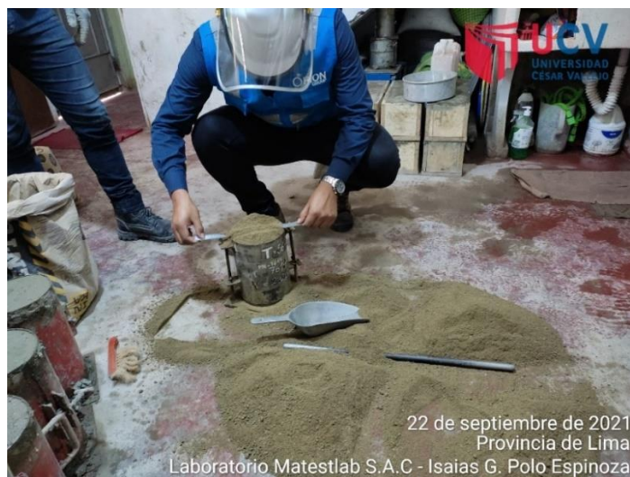
Figura 22: Peso unitario suelto del agregado fino
