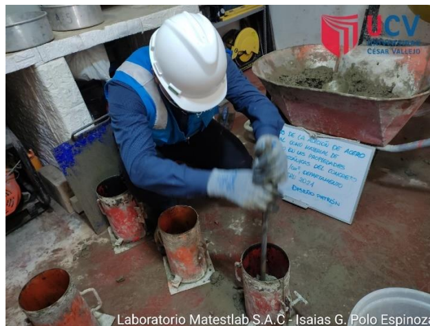
Figura 43: Compactación de 25 golpes por capa
