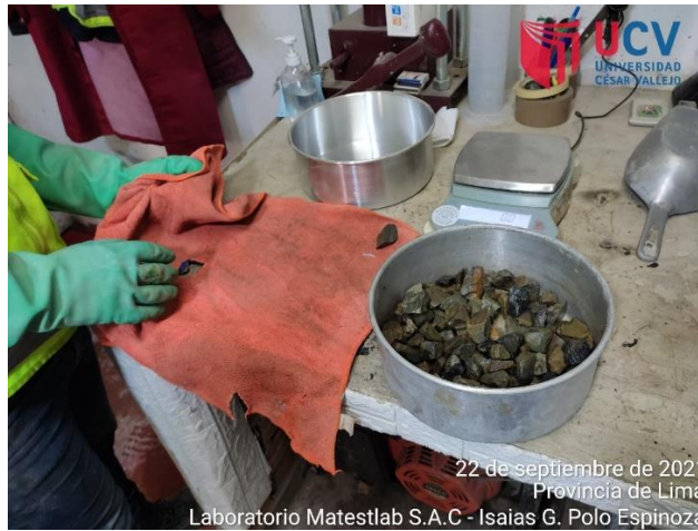
Figura 34: Secado de la muestra de agregado grueso con frañela
