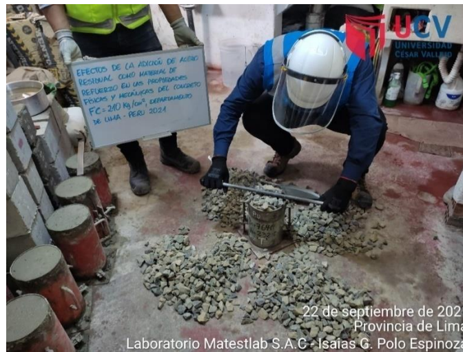
Figura 25: Peso unitario suelto del agregado grueso
