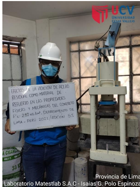
Figura 57: Probeta con adición del 5% de acero residual
