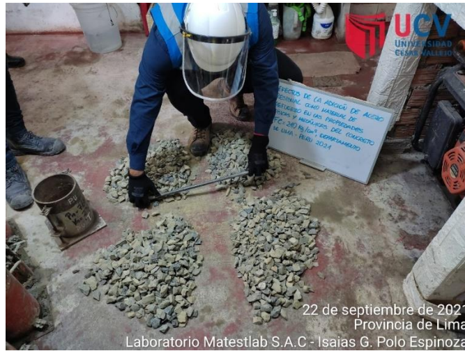
Figura 24: Cuarteo del agregado grueso
