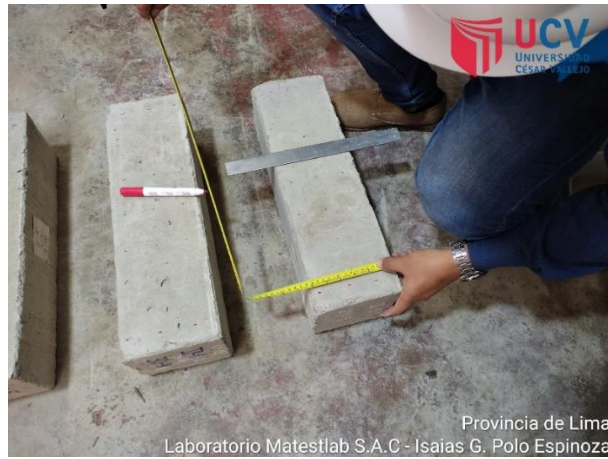
Figura 55: Medidas en las probetas de ensayo a flexión
