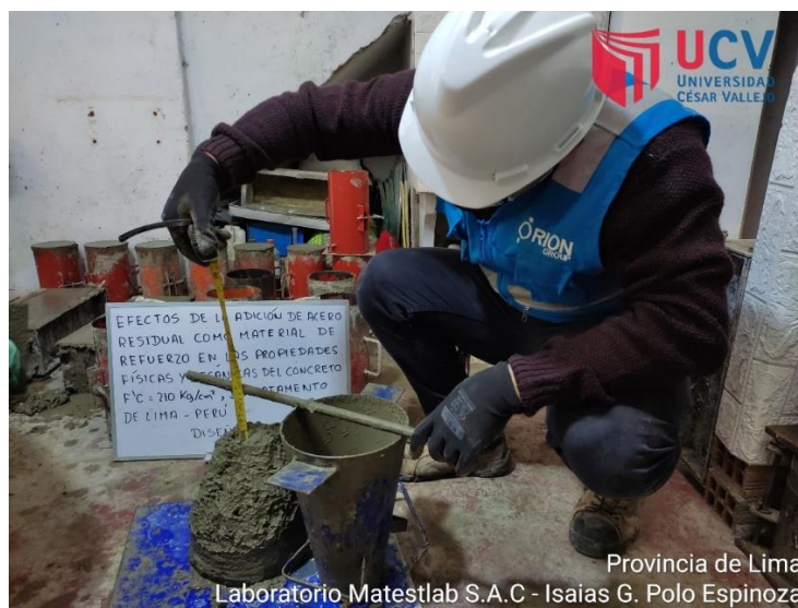
Figura 39: Ensayo de asentamiento en las instalaciones del laboratorio Mateslab
