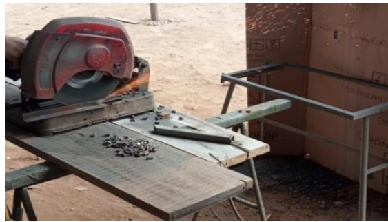
Figura 14: Mesa de corte para el acero de 3/8"
