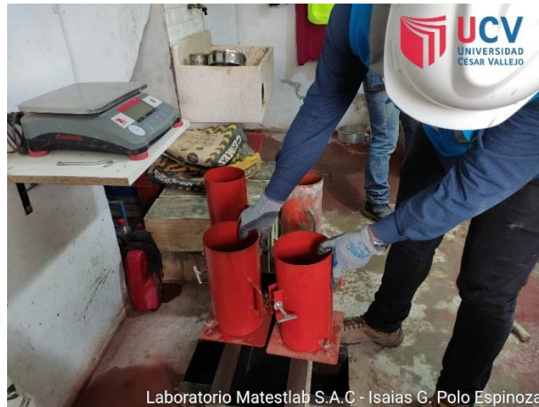
Figura 41: Molde cilíndrico de 15cm x 30cm (6" x 12")
