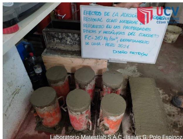
Figura 46: Tanda de probetas cilíndricas y molde tipo viga
