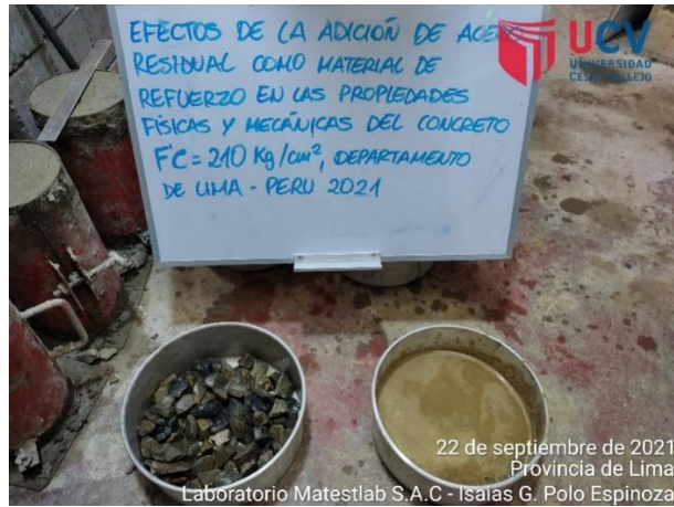
Figura 27: Agregado fino y grueso sumergido en agua por 24 horas
