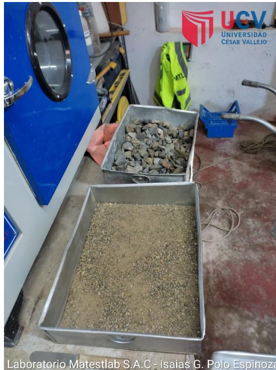
Figura 37: Muestra de agregado grueso peso seco
