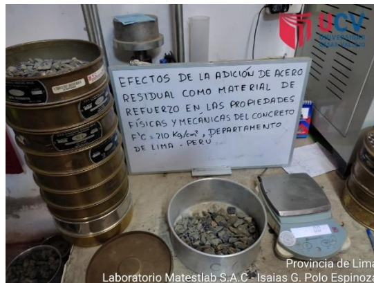
Figura 19: Modulo de fineza para el agregado grueso
