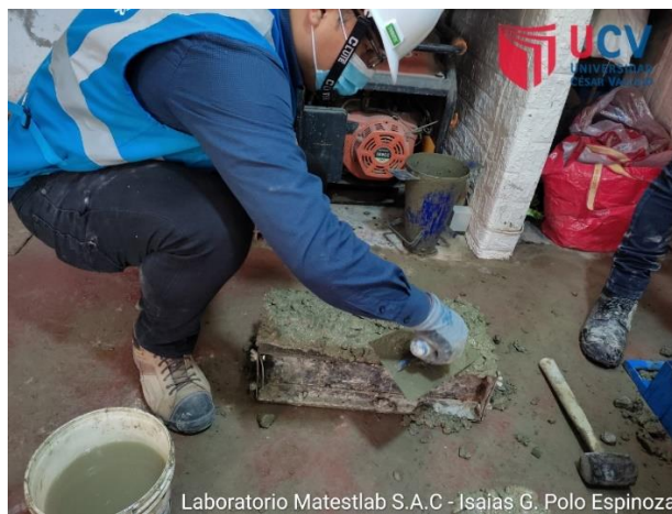
Figura 45: Enrasado del molde tipo viga con la plancha metálica
