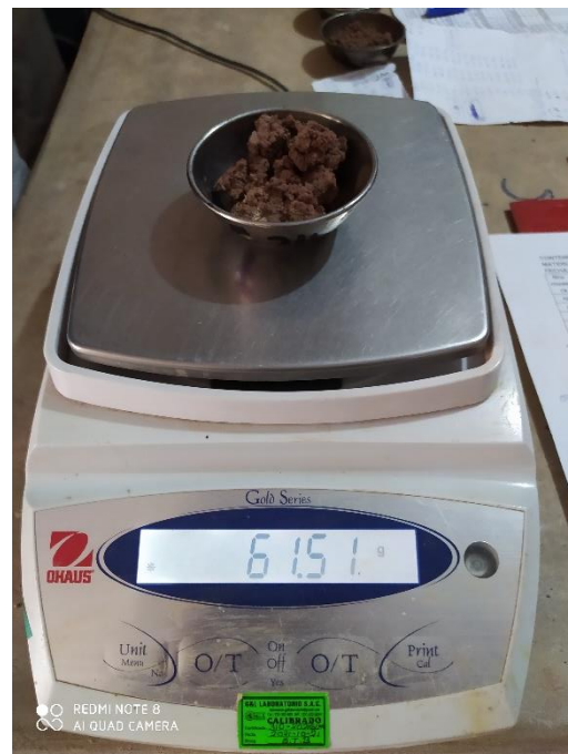
Figura 48. Medición con el sensor capacitivo y pesaje de muestra de suelo húmedo.
