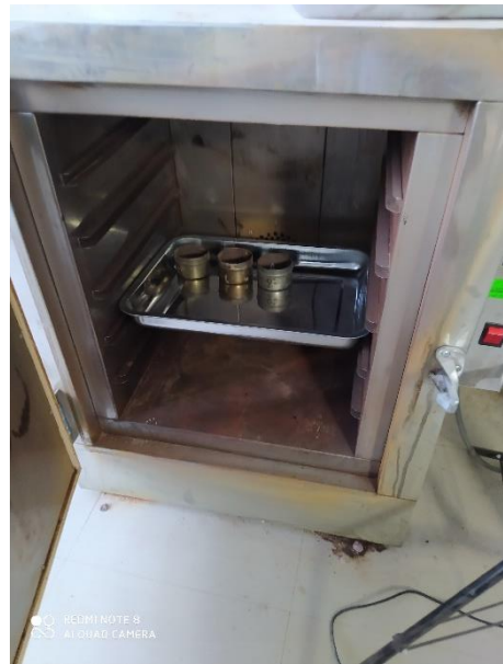
Figura 29. Medición del peso de la capsula más peso de suelo húmedo y colocación en horno de tiro forzado durante 24 horas a 110°C.
