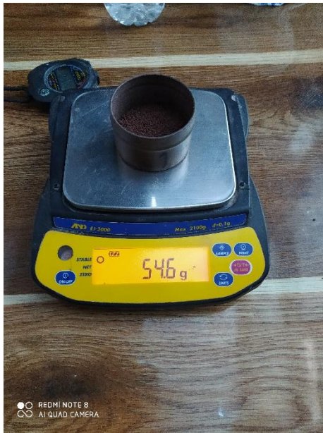
Figura 29. Medición del peso de la capsula más peso de suelo húmedo y colocación en horno de tiro forzado durante 24 horas a 110°C.
