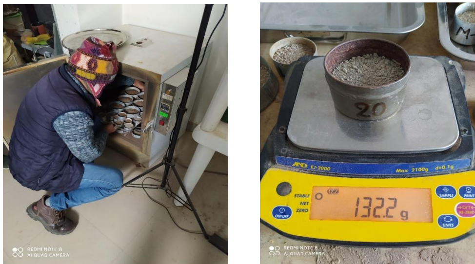
Figura 42. Colocación de muestras en horno de tiro forzado, extracción luego del secado a 110°C durante 24 horas y pesaje de muestras secas.
