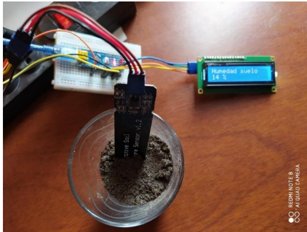
Figura 15. Medición de humedad del sensor en arena 14%.
