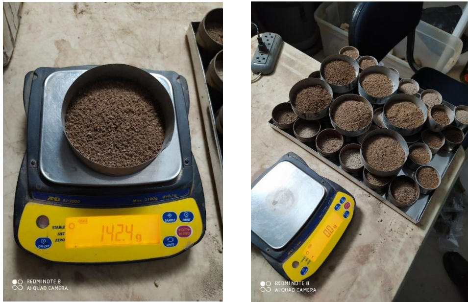
Figura 41. Pesaje de muestras húmedas en laboratorio.
