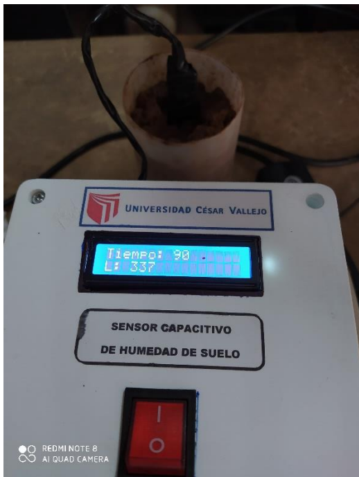
Figura 48. Medición con el sensor capacitivo y pesaje de muestra de suelo húmedo.
