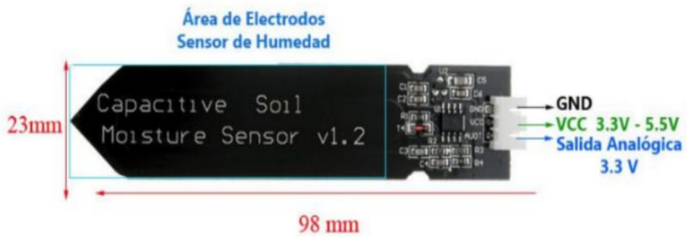
Figura 9. Pines de conexión del sensor capacitivo.
