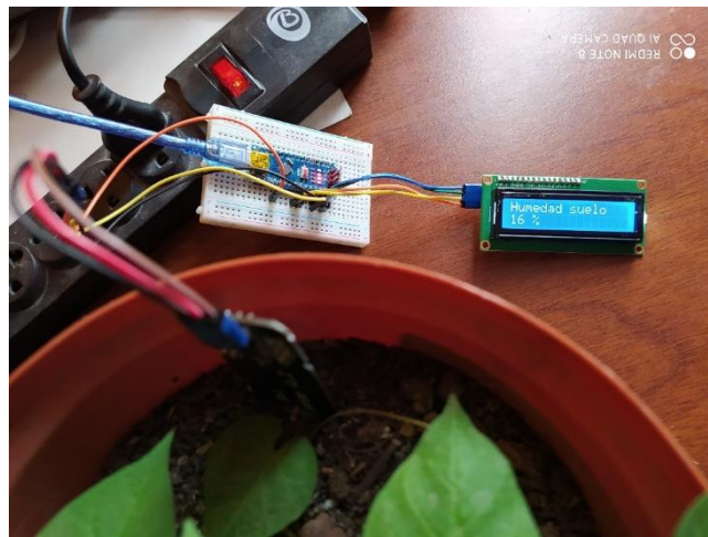
Figura 16. Medición de humedad del sensor en suelo orgánico 16%.
