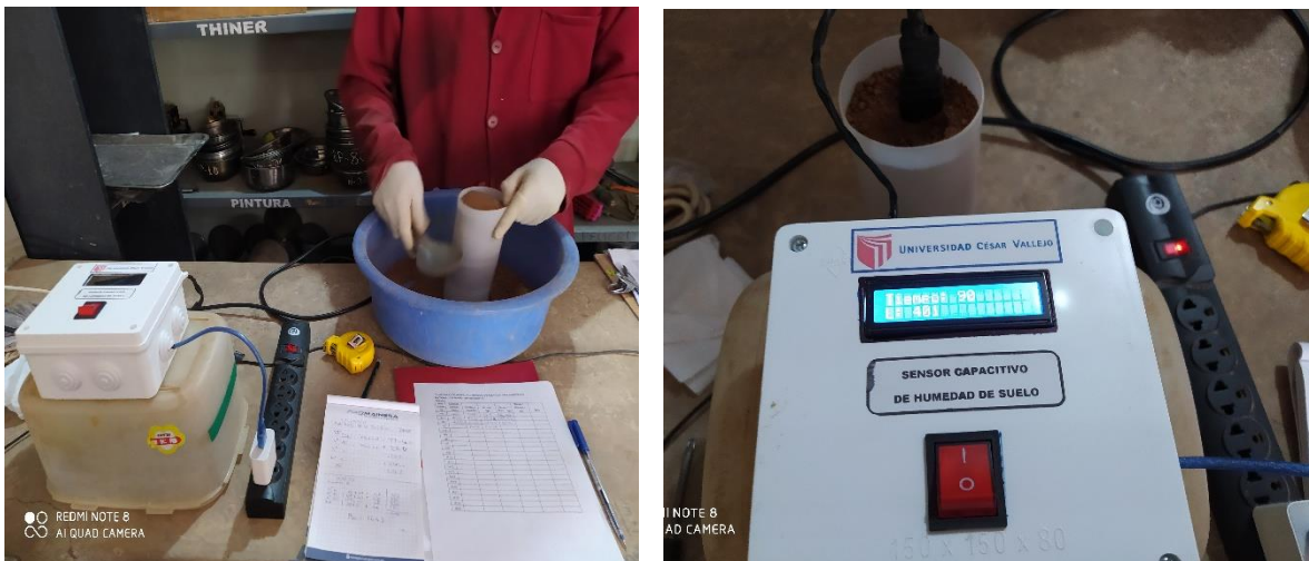
Figura 46. Preparación de la probeta con el suelo y medición con sensor capacitivo.
