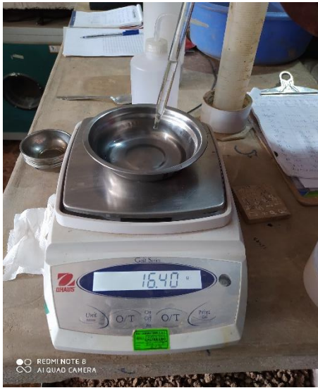
Figura 47. Adición de 16.40 g de agua y mezcla con suelo para cada medición
