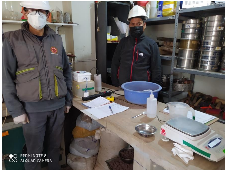
Figura 45. Preparación de equipos para ensayos de humedad con sensor capacitivo y método gravimétrico.
