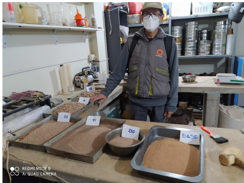
Figura 44. Suelo preparado para la gradación de material de base de la cantera de Sencca.
