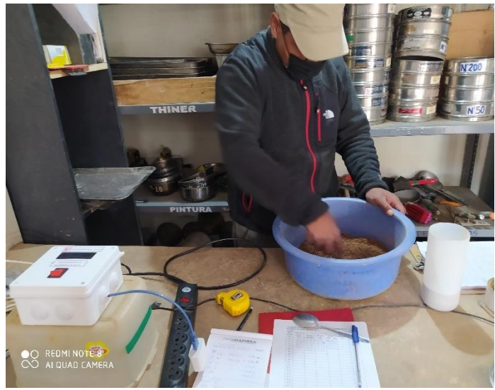
Figura 47. Adición de 16.40 g de agua y mezcla con suelo para cada medición
