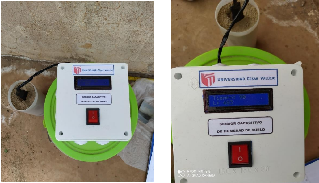
Figura 39. Mediciones de humedad con sensor capacitivo.
