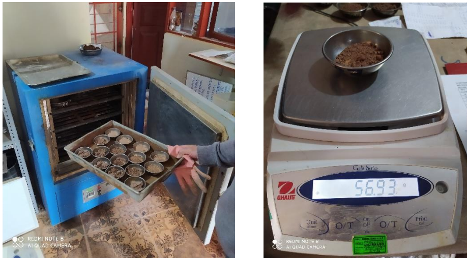
Figura 49. Colocación de muestras húmedas en el horno, pesaje de muestras luego del secado en horno de tiro forzado.
