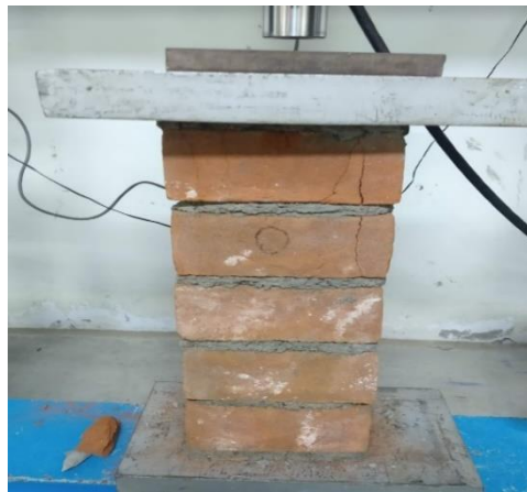
Fotografía 42. Compresión del ensayo pilas.
