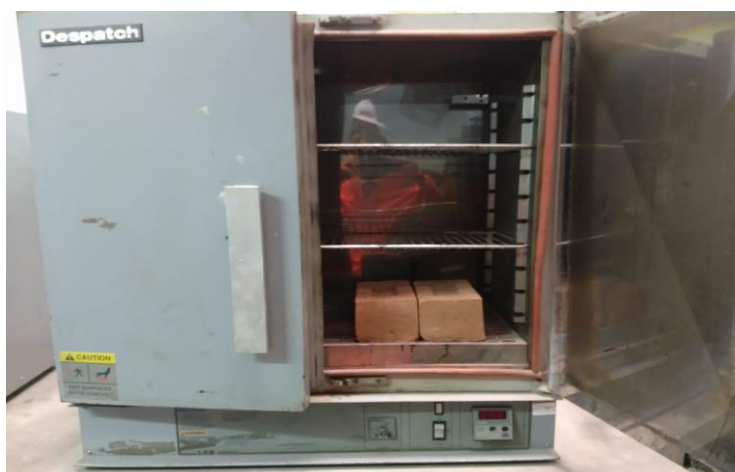
Fotografía 31. Se colocó los ladrillos al horno por 24 horas.
