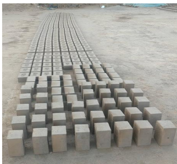
Fotografía 14. Secado de los ladrillos por lados adversos y reversos.
