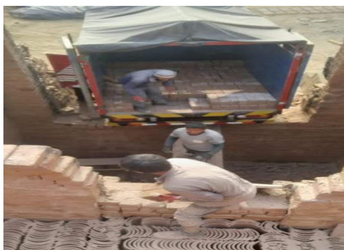
Fotografía 18. Retiro del ladrillo después de ser cocido.
