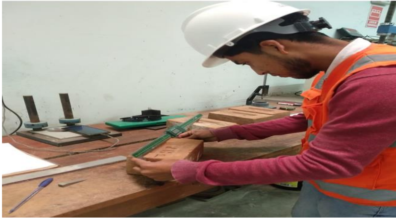
Fotografía 22. Toma de medidas para el ensayo variación dimensional.
