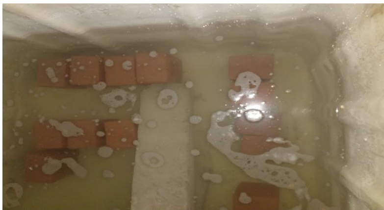
Fotografía 25. Saturación 24 horas ladrillo ensayo densidad.
