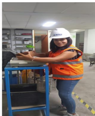
Fotografía 28. Toma del peso de los ladrillos después de estar en el horno 24h, ensayo succión.
