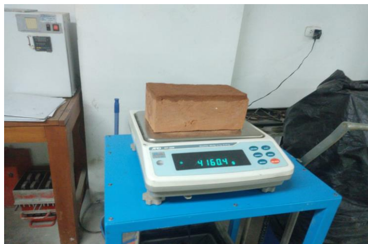
Fotografía 30. Toma del peso del ladrillo después de estar sumergido con poca agua, ensayo succión.
