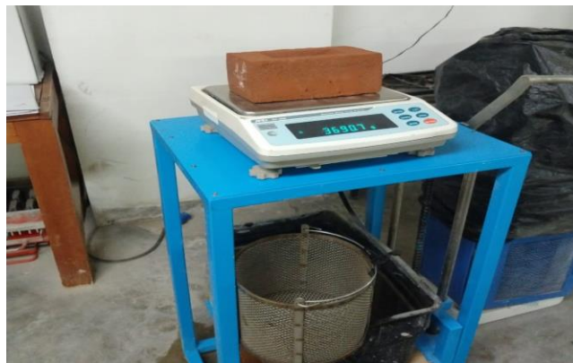
Fotografía 34. Peso del ladrillo luego de estar en la fuente por 24 h, ensayo absorción.
