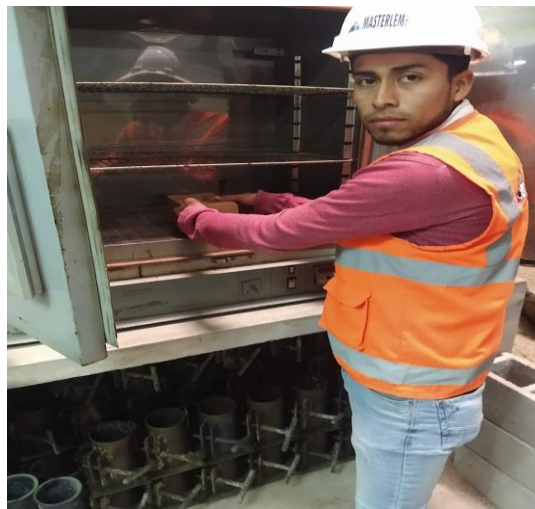
Fotografía 27. Colocación de los ladrillos al horno por 24 horas ensayo succión.
