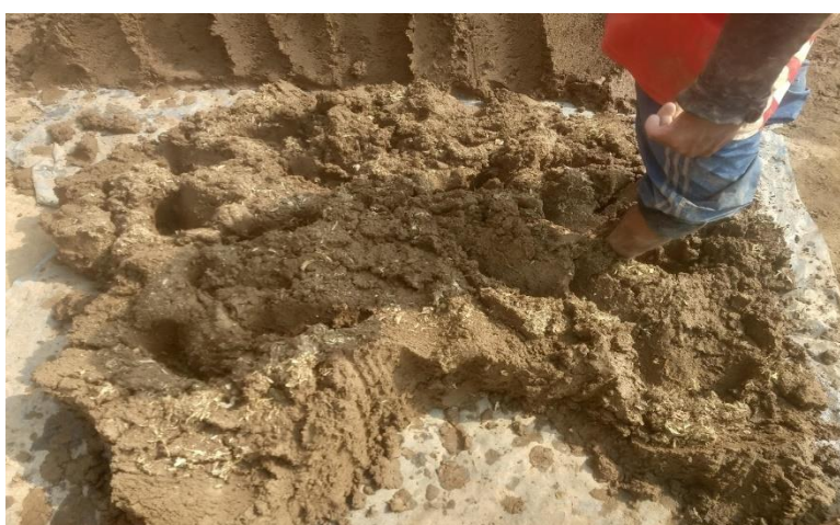
Fotografía 9. Mezclado artesanal con los pies para obtener una mezcla homogénea y con pala para adherir la arcilla y las coronas de piña molida.
