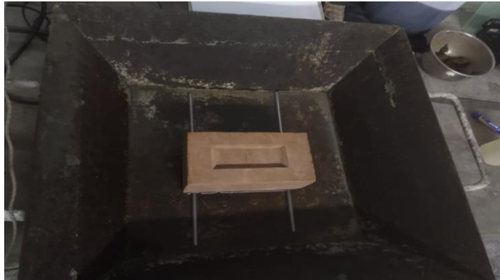
Fotografía 29. Colocación de los ladrillos en el agua después de haberlo pesados, ensayo succión.
