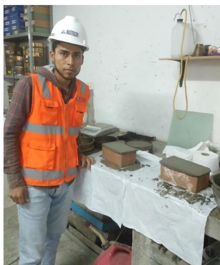
Fotografía 37. Recubrimiento con yeso y cal al ladrillo para las diferentes muestras para el ensayo compresión.
