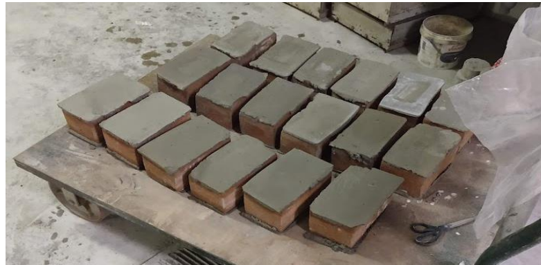
Fotografía 36. Finalización del recubrimiento para el ensayo de compresión.
