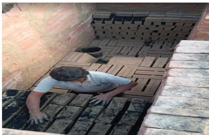
Fotografía 17. Colocación de los ladrillos al horno artesanal.
