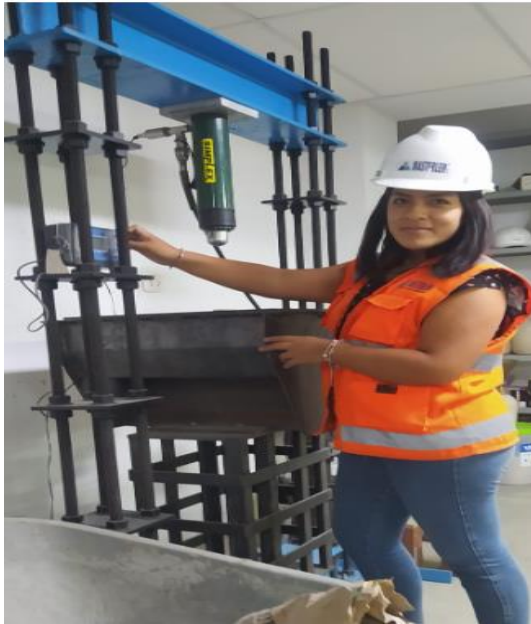
Fotografía 45. Calibración para el ensayo de muretes.
