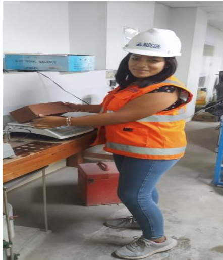
Fotografía 32. Toma del peso de los ladrillos luego de retirarlo del horno, ensayo absorción.
