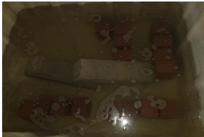
Fotografía 33. Saturación del ladrillo por 24 horas, ensayo absorción.
