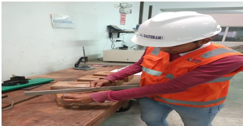
Fotografía 24. Verificación de la concavidad y la convexion para el ensayo alabeo.
