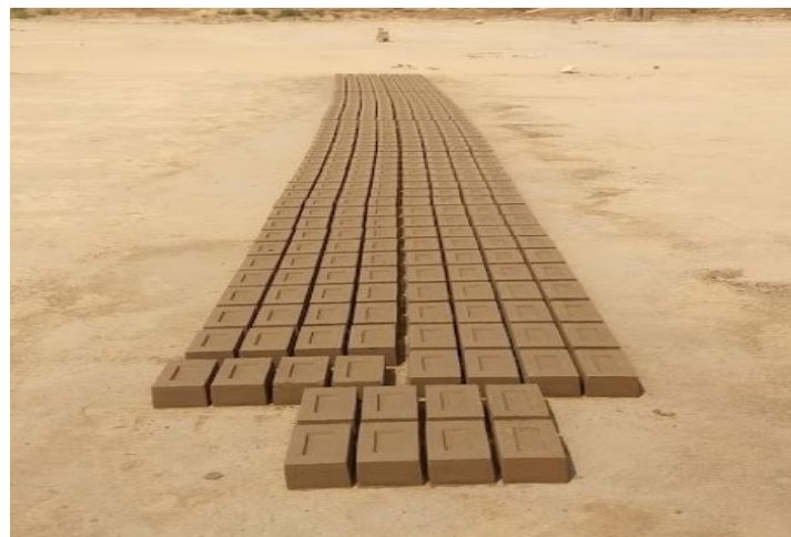
Fotografía 12. Finalización de la elaboración de ladrillos de arcilla con adición coronas de piña y esperar secar una semana de acuerdo al ambiente.
