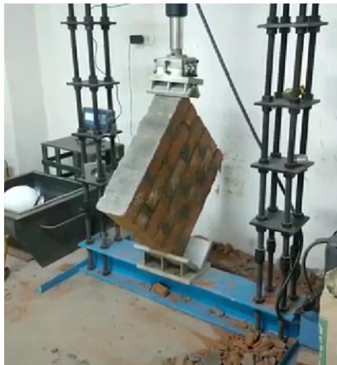
Fotografía 47. Muestra al 5% para el ensayo muretes.
