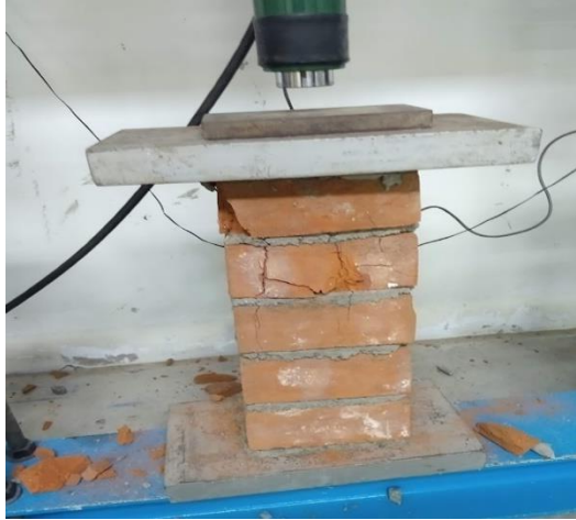
Fotografía 42. Compresión del ensayo pilas.
