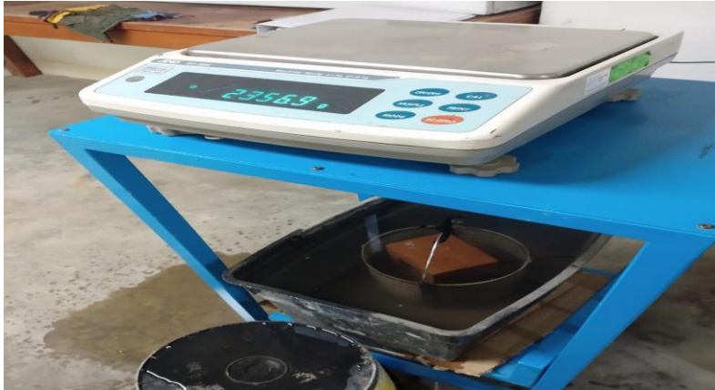
Fotografía 26. Colocación del ladrillo una vez saturado para el ensayo densidad.
