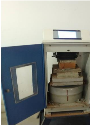
Fotografía 39. Ladrillo sometido al ensayo de compresión sucesivamente se hizo el mismo proceso con los diferentes porcentajes.
