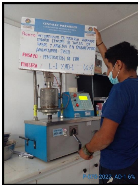
FOTOGRAFÍA N°24: Ensayo de CBR adicionando 6% de ceniza de tallo de habas
