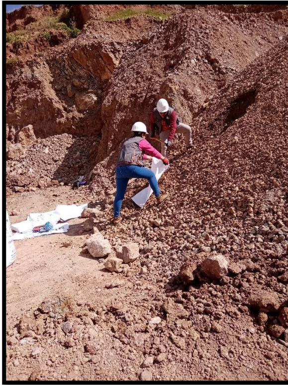
FOTOGRAFÍA N°3: Extracción de lastre de la cantera Callipata.
