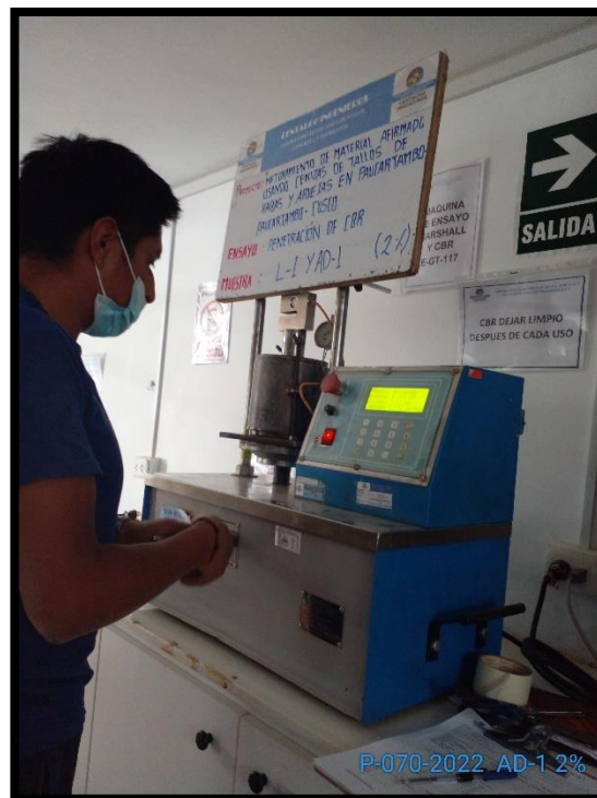
FOTOGRAFÍA N°18: Ensayo de CBR adicionando 2% de ceniza de tallo de habas
