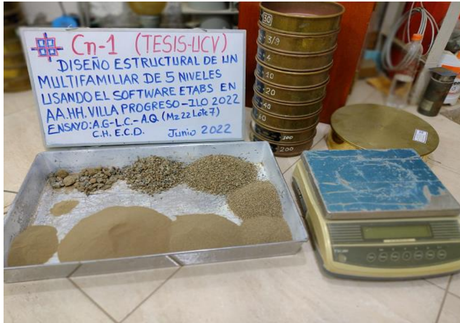
Figura 24 Ensayo de granulometría. Laboratorio de Geotecnia (2022)
