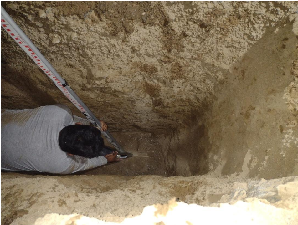
Figura 84 Toma de muestra y medición de corte. Elaboración propia
