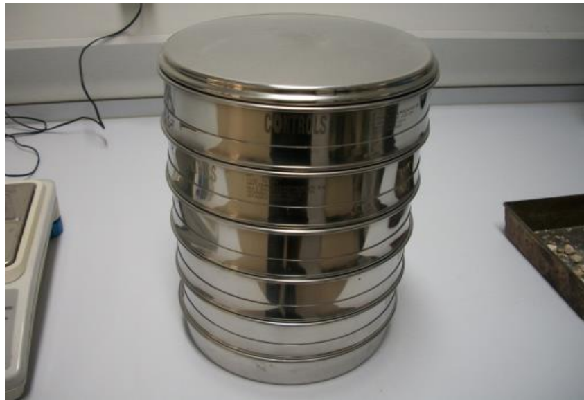
Figura 22 Tamices según la ASTM-D422. Tomás, y otros (2013)
