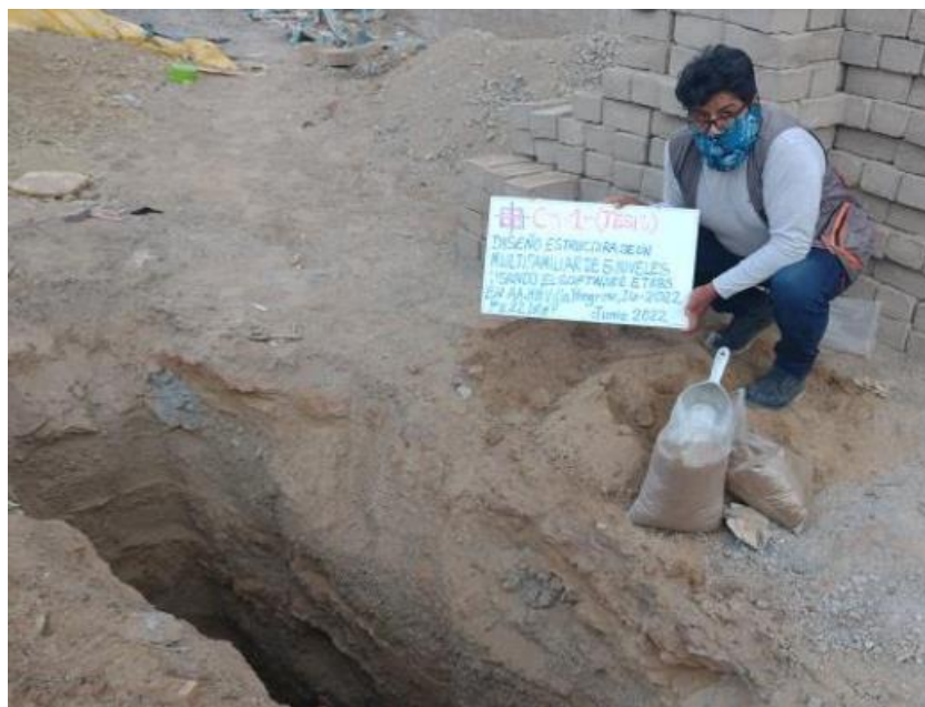
Figura 23 Recojo de muestra de suelo de calicata. Elaboración propia
