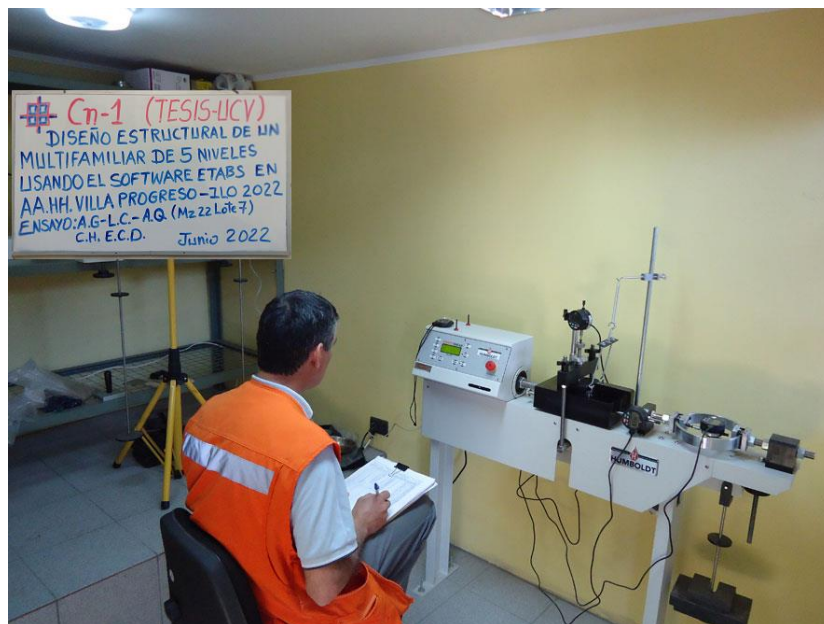
Figura 28 Máquina de corte directo. Laboratorio de Geotecnia (2022)
