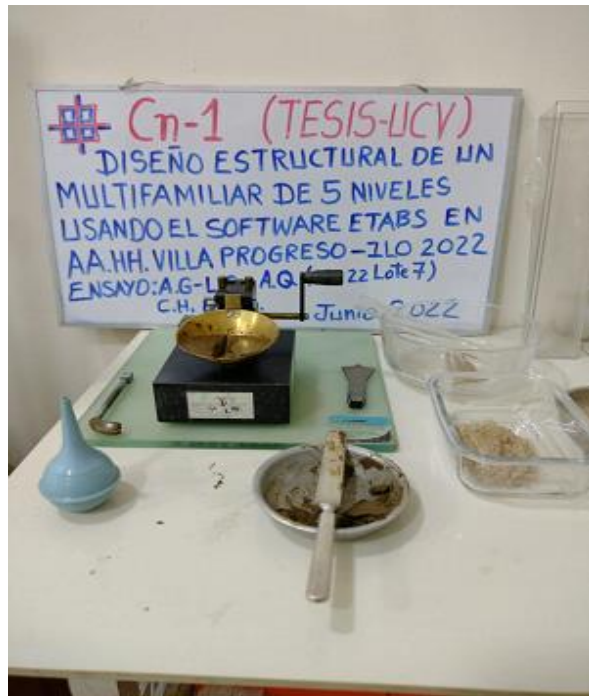
Figura 26 Ensayo de Límites de Consistencia. Laboratorio de Geotecnia (2022)
