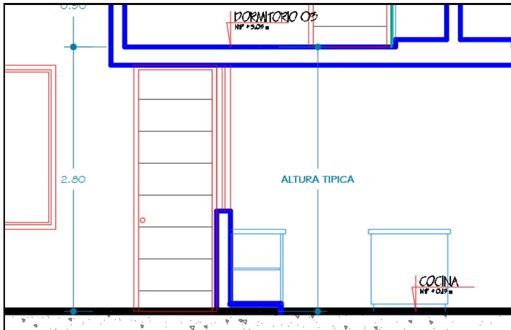
Figura 48 Altura típica de vivienda. Elaboración propia
