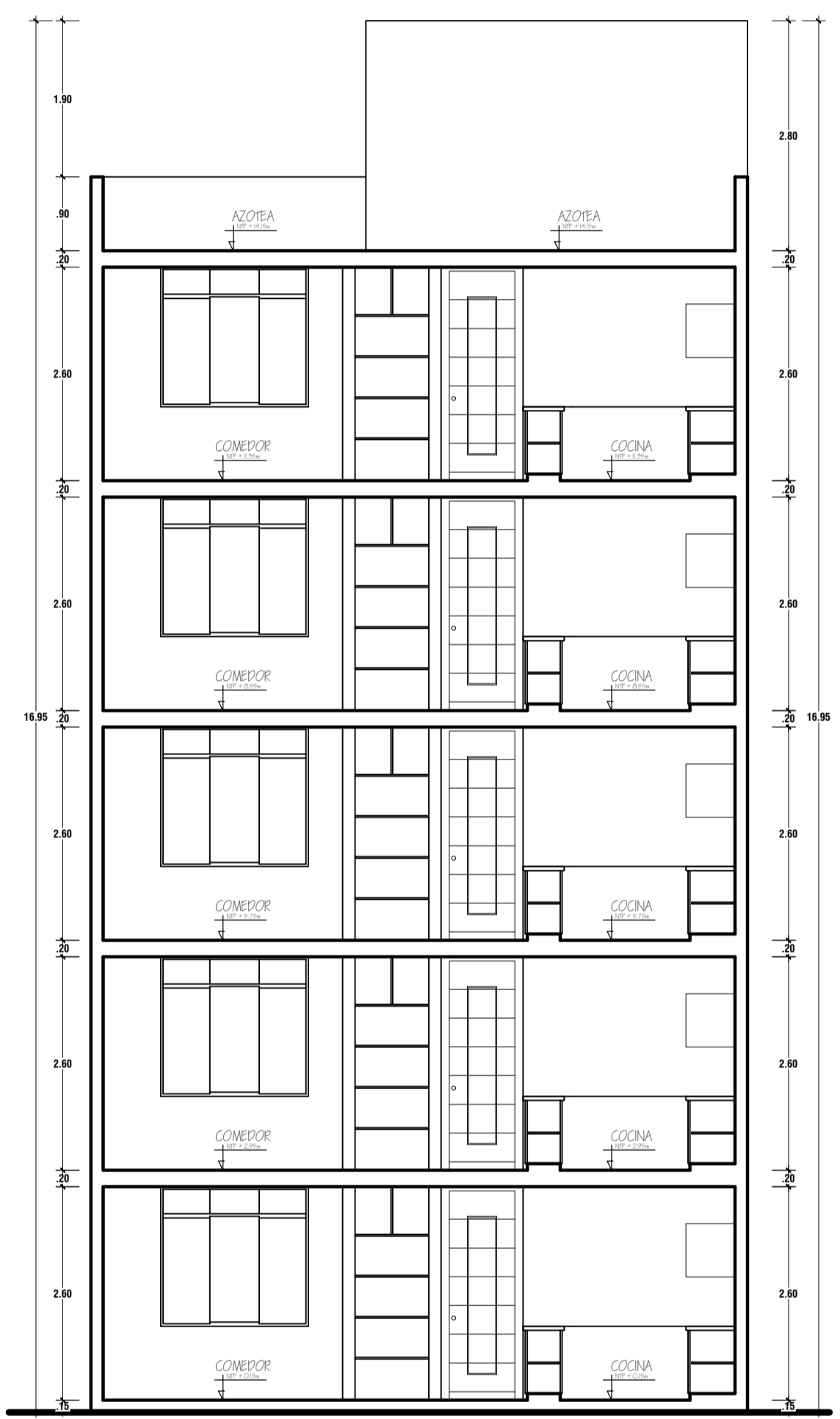
Corte B-B VIVIENDA MULTIFAMILIAR escala 1:50
