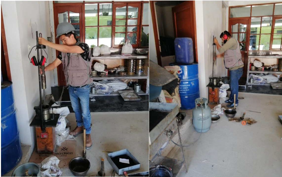
Golpe de briquetas con el martillo (75 golpes / 90 seg)
