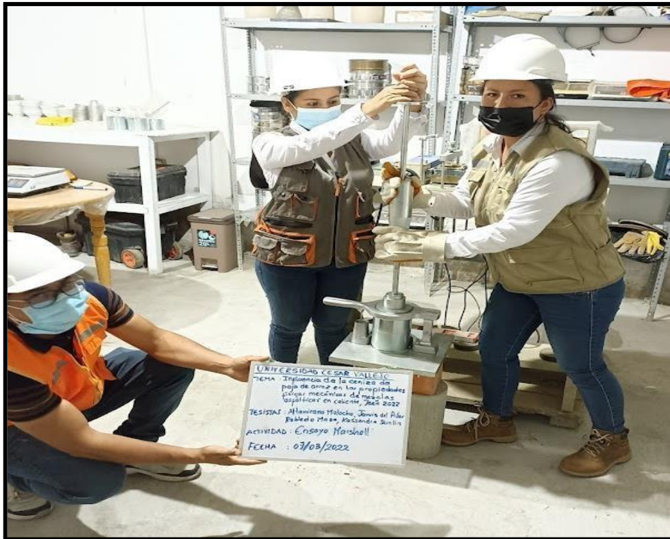
Figura 9: Compactación con el Martillo Marshall
