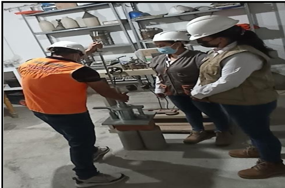
Figura 10. Compactación de la mezcla asfáltica para briqueta (75 golpes)
