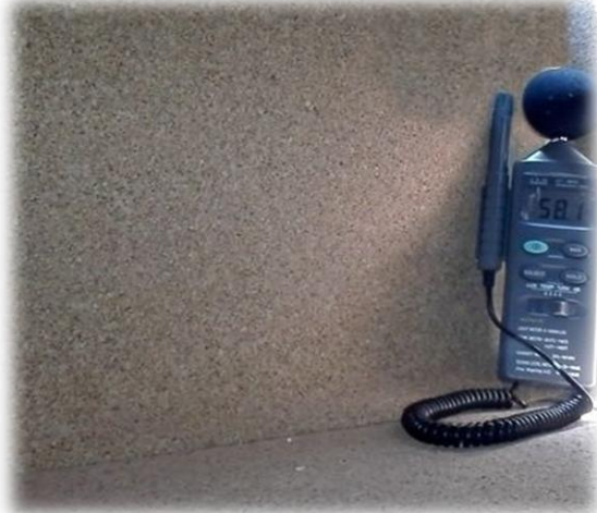
Resultado de sonómetro 58.1dB después de la implementación con corcho (1:30pm –Domingo)
