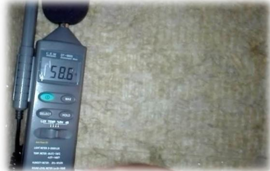
Resultado de sonómetro 58.6 dB después de la implementación con lana de roca (8:30am - Domingo)
