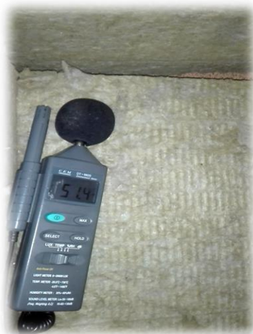
Figura N° 17: Medición con sonómetro de la caja acústica implementado con lana de roca
