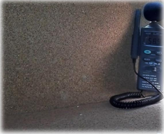
Resultado de sonómetro 58.9dB después de la implementación con corcho (6:30pm – Jueves)
