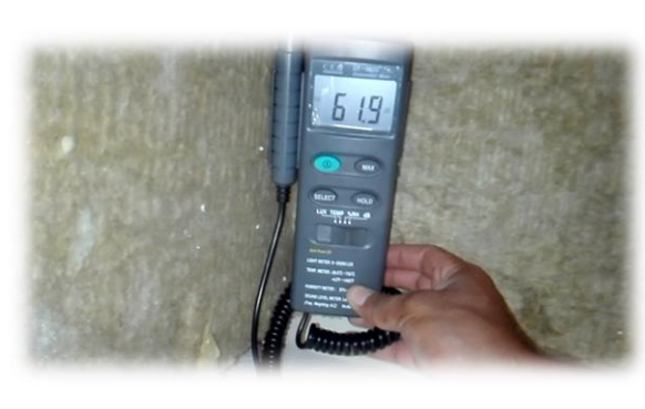
Resultado de sonómetro 61.9 dB después de la implementación con lana de roca (1:30pm - Jueves)
