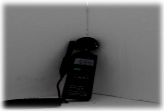
Resultado de sonómetro 59.4dB después de la implementación con poliestireno expandido (8:30am - Sábado)
