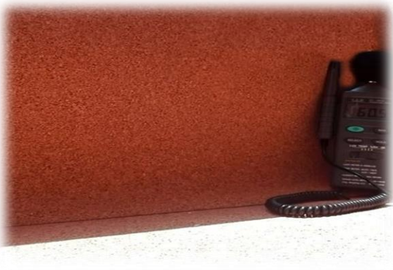
Resultado de sonómetro 60.5dB después de la implementación con corcho (1:30pm – Domingo)
