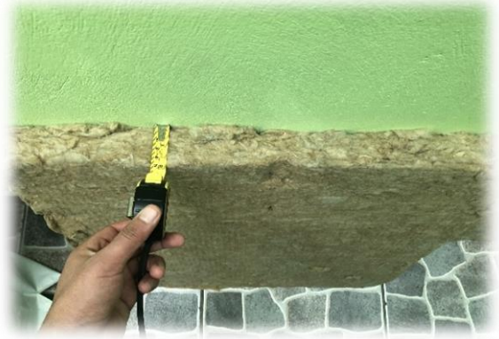
MEDIDA DE ESPESOR DE LA LANA DE ROCA 50 MM
