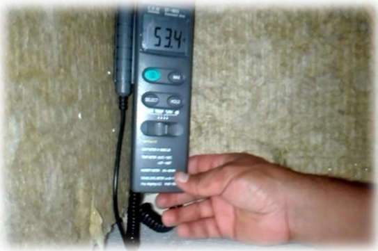
Resultado de sonómetro 53.4 dB después de la implementación con lana de roca (8:30am - Domingo)
