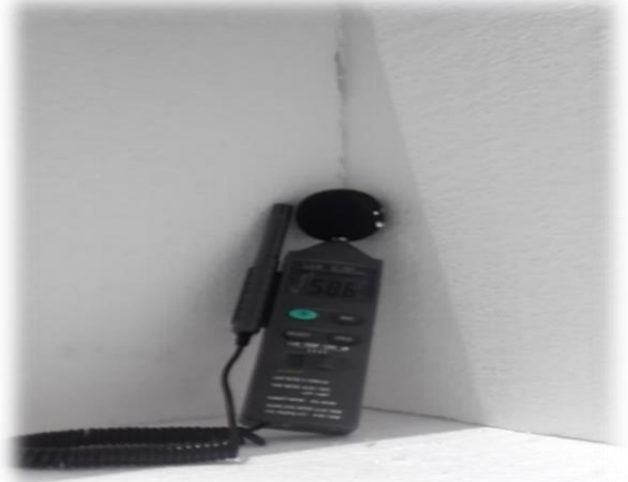
Resultado de sonómetro 58.6dB después de la implementación con poliestireno expandido (8:30am - Domingo)
