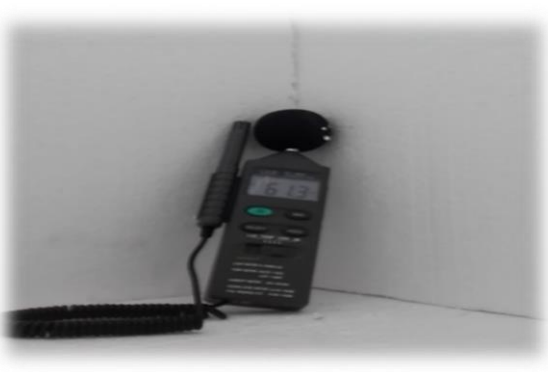
Resultado de sonómetro 61.3dB después de la implementación con poliestireno expandido (1:30pm - Jueves)
