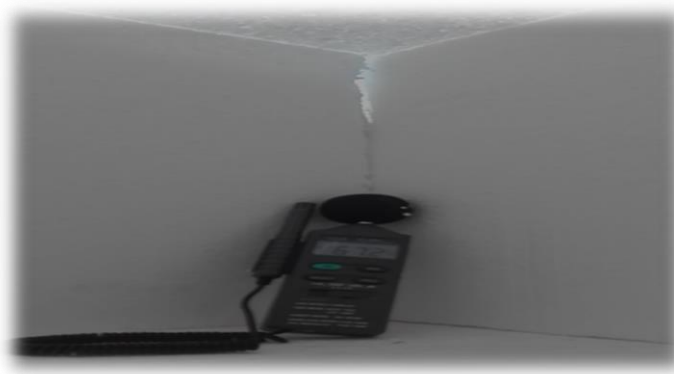
Resultado de sonómetro 67.2 dB después de la implementación con poliestireno expandido (1:30pm - Sábado)
