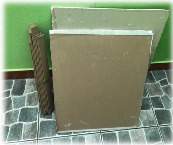
Figura N° 6: Planchas de draywall 60x60
