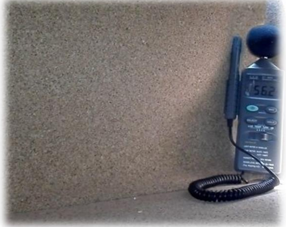
Resultado de sonómetro 56.2dB después de la implementación con corcho (8:30am – Domingo)
