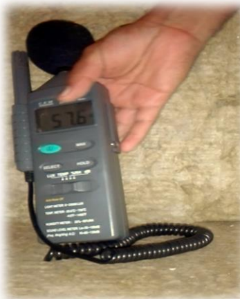
Resultado de sonómetro 57.6 dB después de la implementación con lana de roca (6:30pm - Sábado) 62.1dB (6:30 – Sábado) después de la implementación con lana de roca 54.7 dB (8:30am - Sábado) después de la implementación con lana de roca
