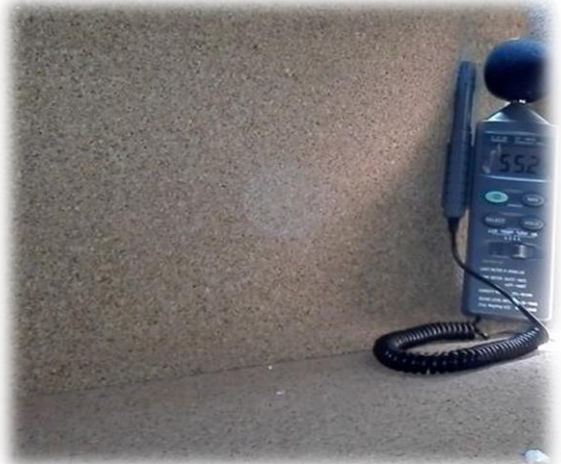
Resultado de sonómetro 55.2dB después de la implementación con corcho (8:30am – Jueves)
