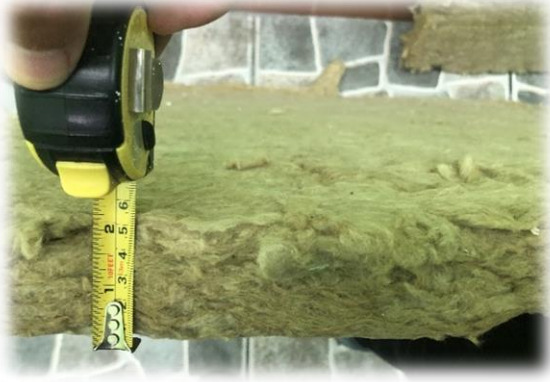
MEDIDA DE ESPESOR DE LA LANA DE ROCA 50 MM
