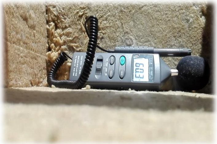
Figura N° 17: Medición con sonómetro de la caja acústica implementado con lana de roca
