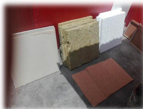
Figura N° 6: Draywall y los aislantes cortado en 60 x60 cm
