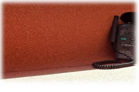
Resultado de sonómetro 58.5dB después de la implementación con corcho (1:30pm – Jueves)
