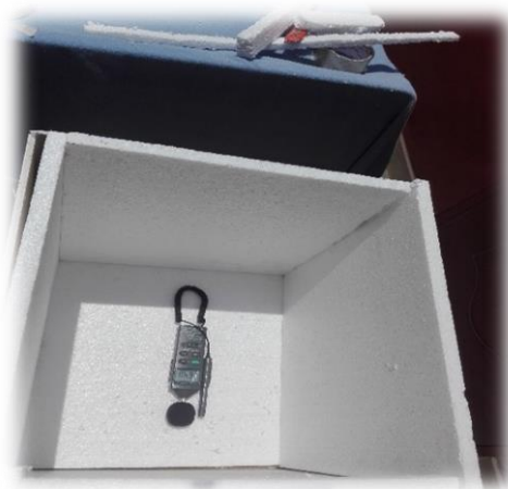
Figura N° 14: Medición con sonómetro de la caja acústica implementado con poliestireno expandido
