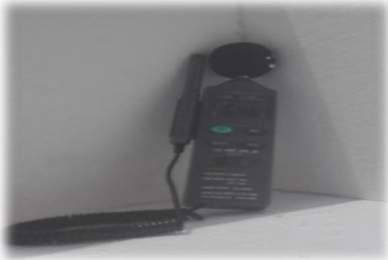
Resultado de sonómetro 64.8 dB después de la implementación con poliestireno expandido (1:30pm - Jueves)
