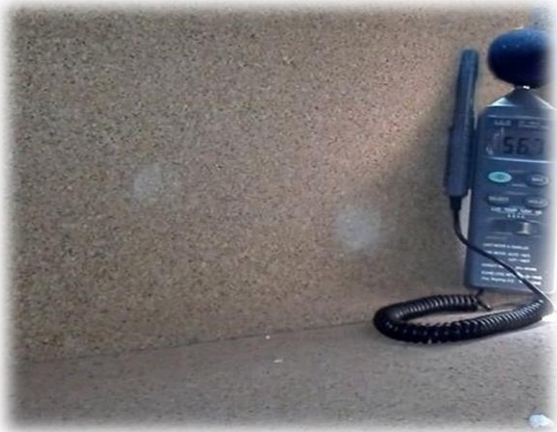
Resultado de sonómetro 56.7dB después de la implementación con corcho (8:30am – Sábado)
