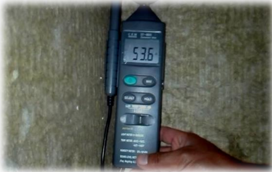
Resultado de sonómetro 53.6 dB después de la implementación con lana de roca (8:30am - Jueves)
