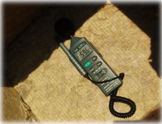
Resultado de sonómetro 59.6 dB después de la implementación con lana de roca (6:30pm - Domingo)
