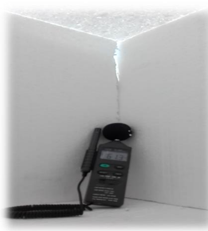
Figura N° 14: Medición con sonómetro de la caja acústica implementado con poliestireno expandido
