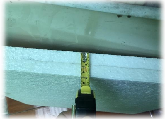
MEDIDA DE ESPESOR DEL POLIESTIRENO EXPANDIDO 2 PULGADAS
