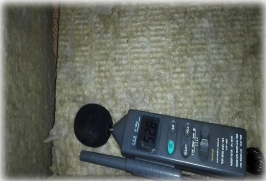
Resultado de sonómetro 52.8 dB después de la implementación con lana de roca (6:30pm - Jueves)
