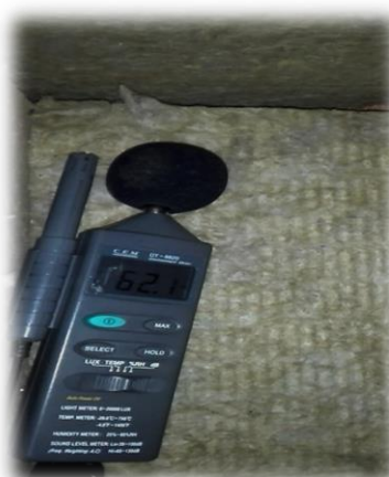
Resultado de sonómetro 57.6 dB después de la implementación con lana de roca (6:30pm - Sábado) 62.1dB (6:30 – Sábado) después de la implementación con lana de roca 54.7 dB (8:30am - Sábado) después de la implementación con lana de roca
