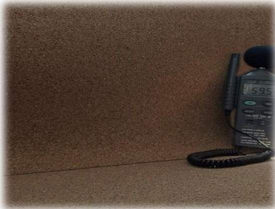
Resultado de sonómetro 59.5dB después de la implementación con corcho (6:30pm - Domingo)
