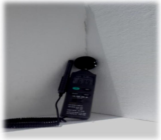
Resultado de sonómetro 63.9 dB después de la implementación con poliestireno expandido (6:30pm - Domingo)
