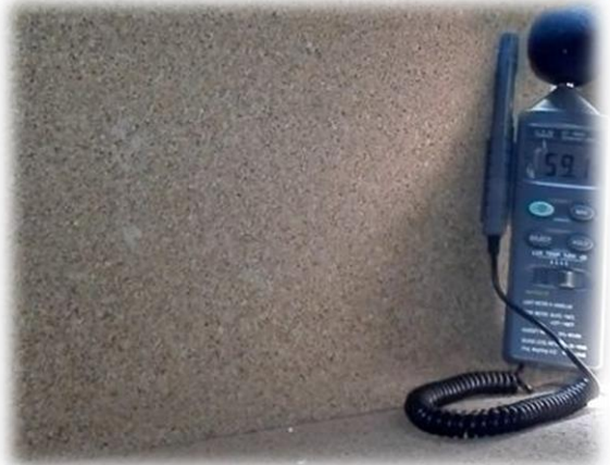
Resultado de sonómetro 59.1dB después de la implementación con corcho (8:30am – Sábado)
