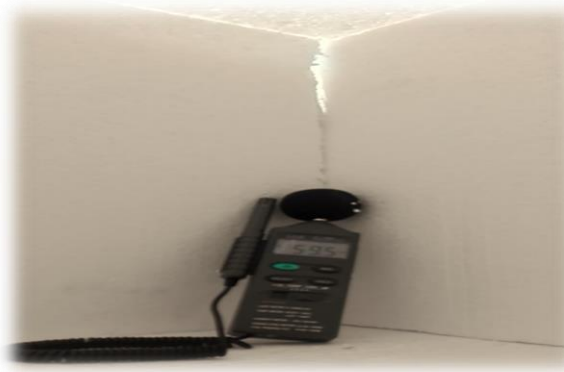
Resultado de sonómetro 59.5dB después de la implementación con poliestireno expandido (6:30pm - Jueves)
