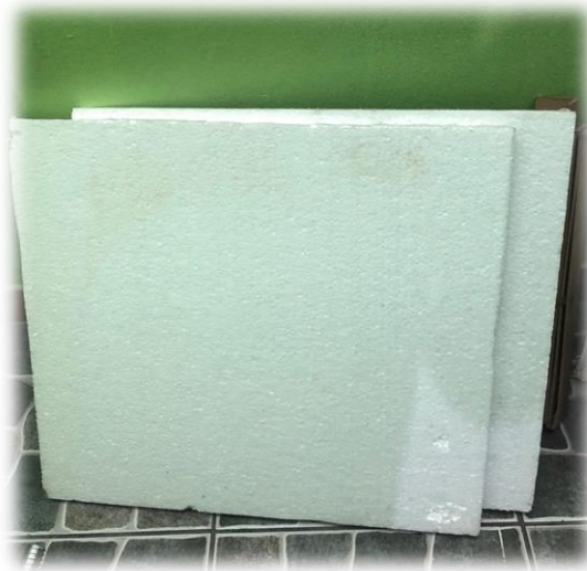
Figura N° 13: Planchas de poliestireno expandido 60X60cm
