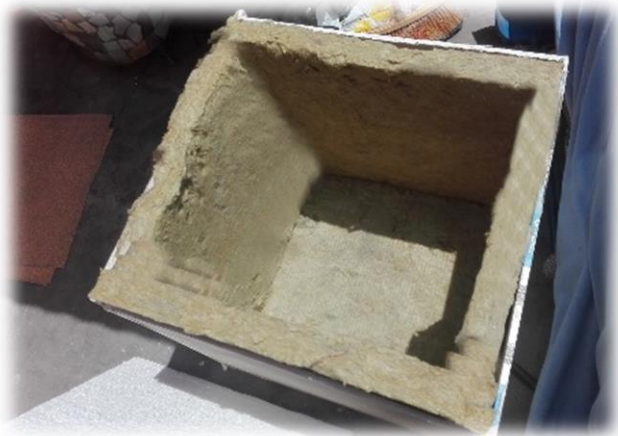
Figura N° 15: Caja acústica implementada con lana de roca
