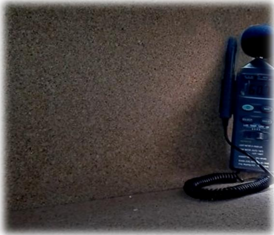
Resultado de sonómetro 60.7dB después de la implementación con corcho (6:30pm – Jueves)
