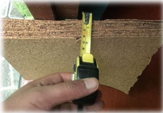
MEDIDA DE ESPESOR DEL CORCHO 2 PULGADAS
