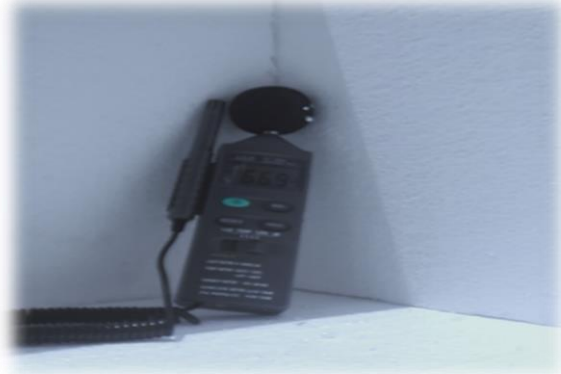
Resultado de sonómetro 66.9 dB después de la implementación con poliestireno expandido (6:30pm - Jueves)
