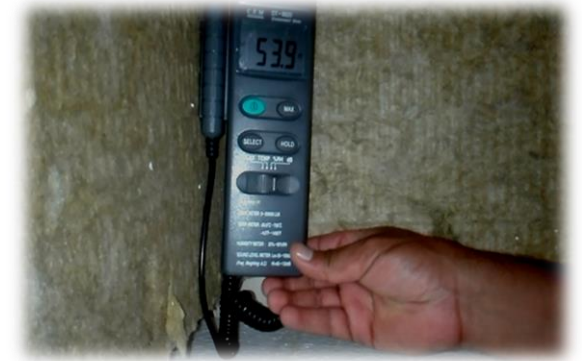
Resultado de sonómetro 53.9 dB después de la implementación con lana de roca (1:30am - Jueves)
