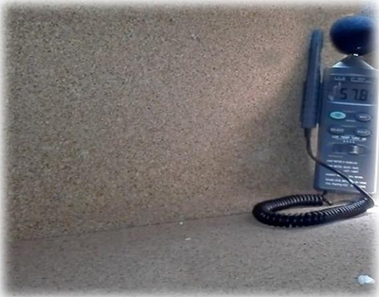
Resultado de sonómetro 57.8dB después de la implementación con corcho (8:30am – Jueves)
