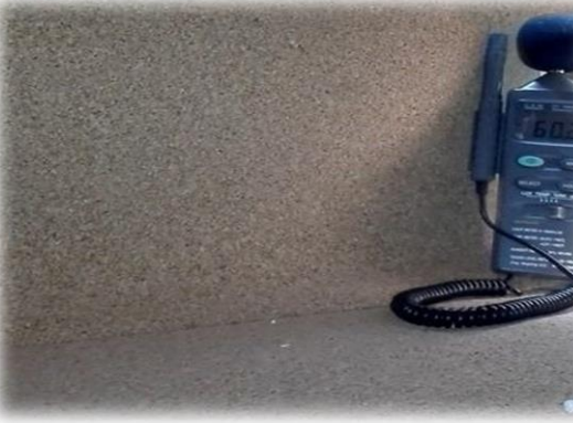
Resultado de sonómetro 60.2dB después de la implementación con corcho (1:30pm – Jueves)
