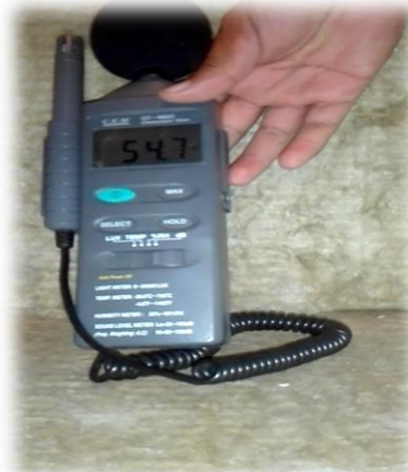
Resultado de sonómetro 57.6 dB después de la implementación con lana de roca (6:30pm - Sábado) 62.1dB (6:30 – Sábado) después de la implementación con lana de roca 54.7 dB (8:30am - Sábado) después de la implementación con lana de roca
