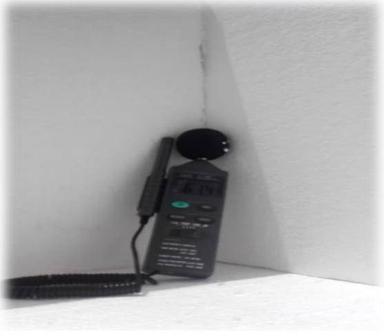
Resultado de sonómetro 61.4 dB después de la implementación con poliestireno expandido (6:30pm - Domingo)
