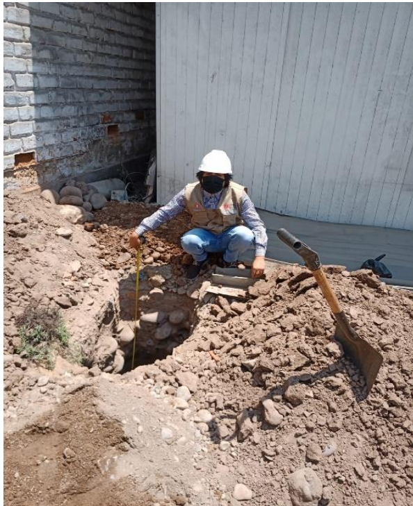
Figura 20. calicata, profundidad 3 metros.
